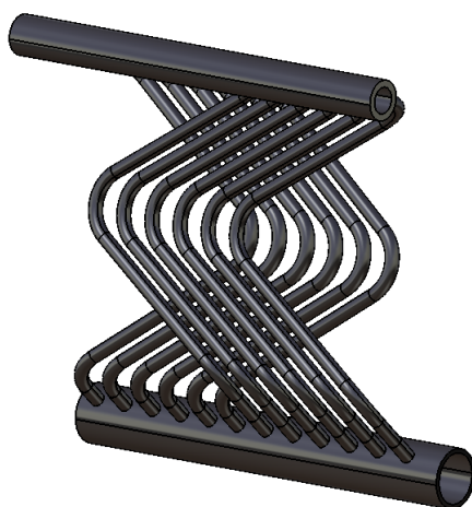
Slika 3.2: Prikaz pola 3D modela donjeg dijela rešetke
