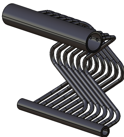
Slika 3.3: Prikaz pola 3D modela gornjeg dijela rešetke
