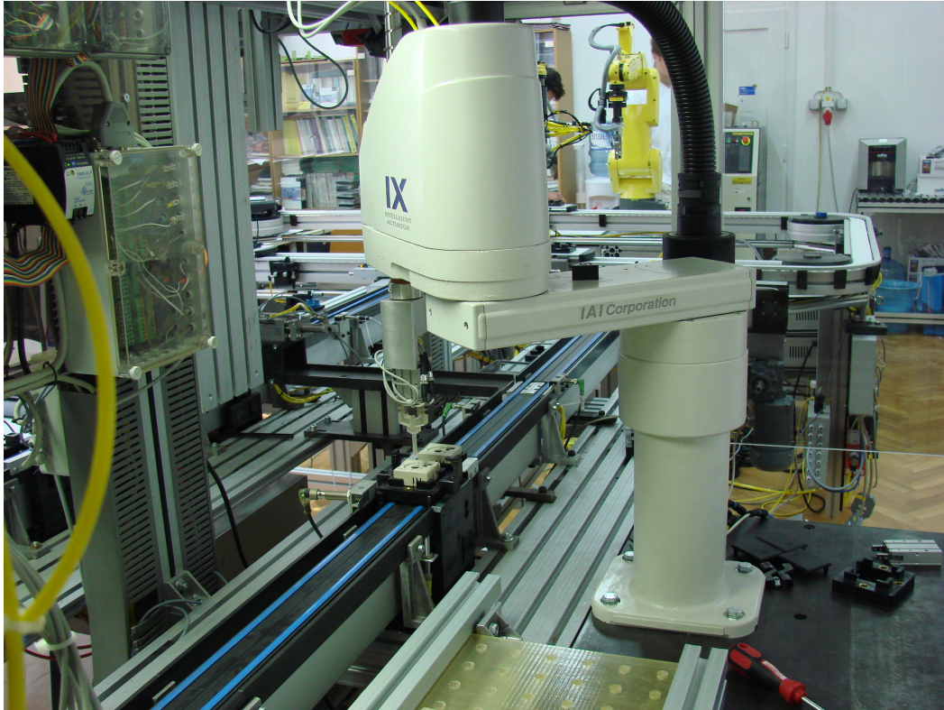
Slika 6.19 Umetanje krivuljne osovinice pomoću SCARA robota.
