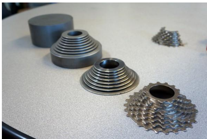
Slika 8. Koraci proizvodnog procesa SRAM kazeta iz jednog komada čelika[10]
