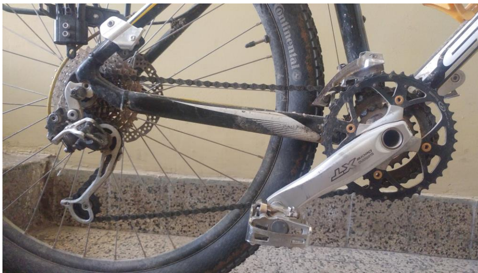
Slika 23. Fotografija 3 x 9 prijenosa cross-country brdskog bicikla
