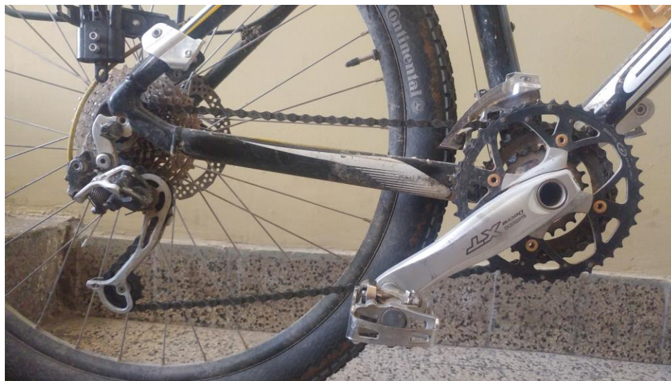
Slika 23. Fotografija 3 x 9 prijenosa cross-country brdskog bicikla
