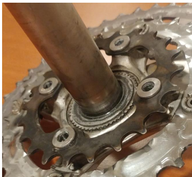
Slika 21. Lančanic nitriran plazma potpomognutim proces fotografiran nakon ugradnje na pogonski sklop prije početka eksploatacijskog trošenja
