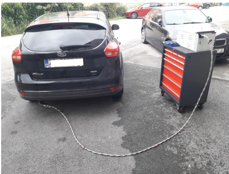
Slika 49. Postavljanje mjerne opreme za inicijalna mjerenja na vozilu s GDI motorom
