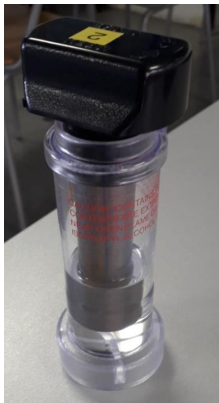
Slika 36. Spremnik radne tekućine uronjen u radnu tekućinu unutar staklene kapsule za punjenje
