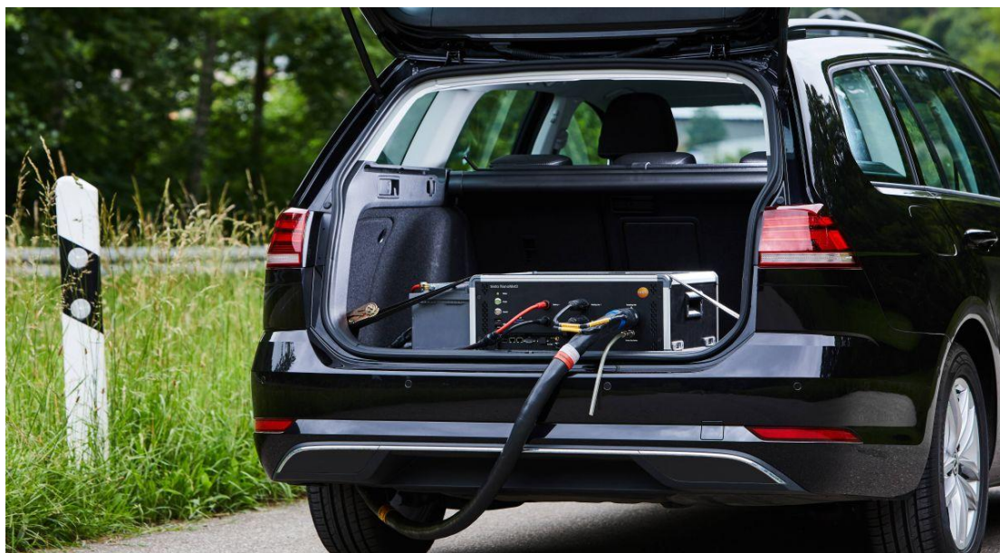
Slika 23. Prijenosni analizator Testo NanoMet3 za mjerenje broja krutih čestica postavljen u prtljažniku vozila [25]
