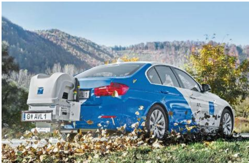
Slika 21. AVL PN PEMS sustav za praćenje emisija u realnim uvjetima vožnje ugrađen na stražnji dio vozila [24]
