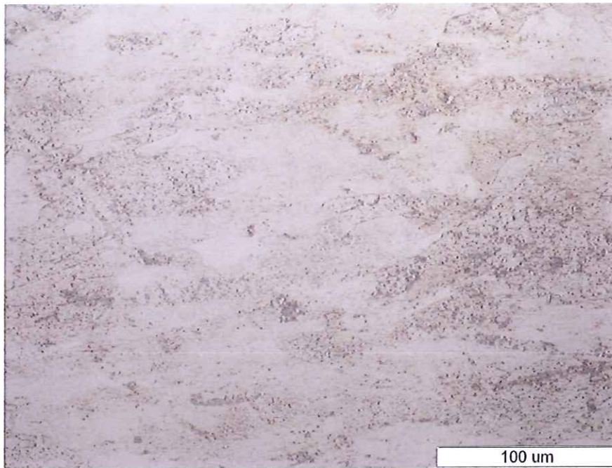
Slika 33. Mikrostruktura letećeg ležaja na svjetlosnom mikroskopu pod povećanjem 500x
