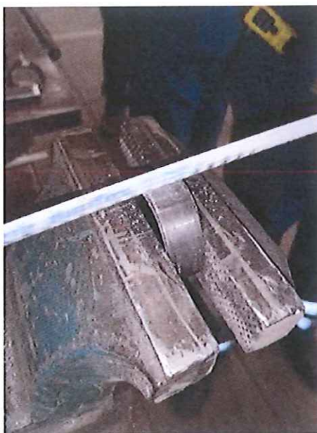
Slika 30. Rezanje ležaja za analizu mikrostrukture
