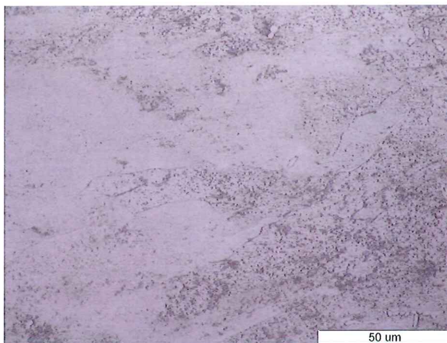
Slika 34. Mikrostruktura letećeg ležaja na svjetlosnom mikroskopu pod povećanjem 1000x
