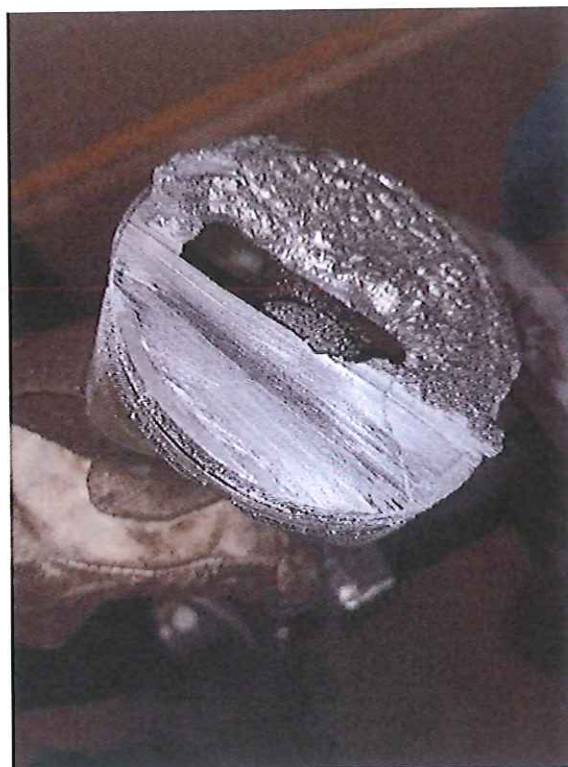
Slika 37. Mjesto rezanja na klipu za analizu mikrostrukture
