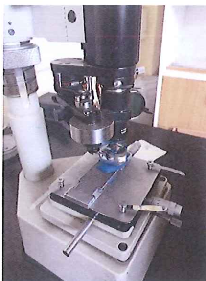
Slika 27. Prikaz uzoraka tijekom ispitivanja tvrdoće
