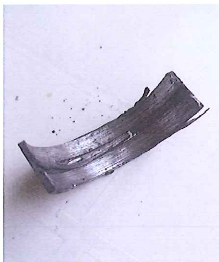
Slika 17. Istrošenost kliznog ležaja 1.4 TDI motora
