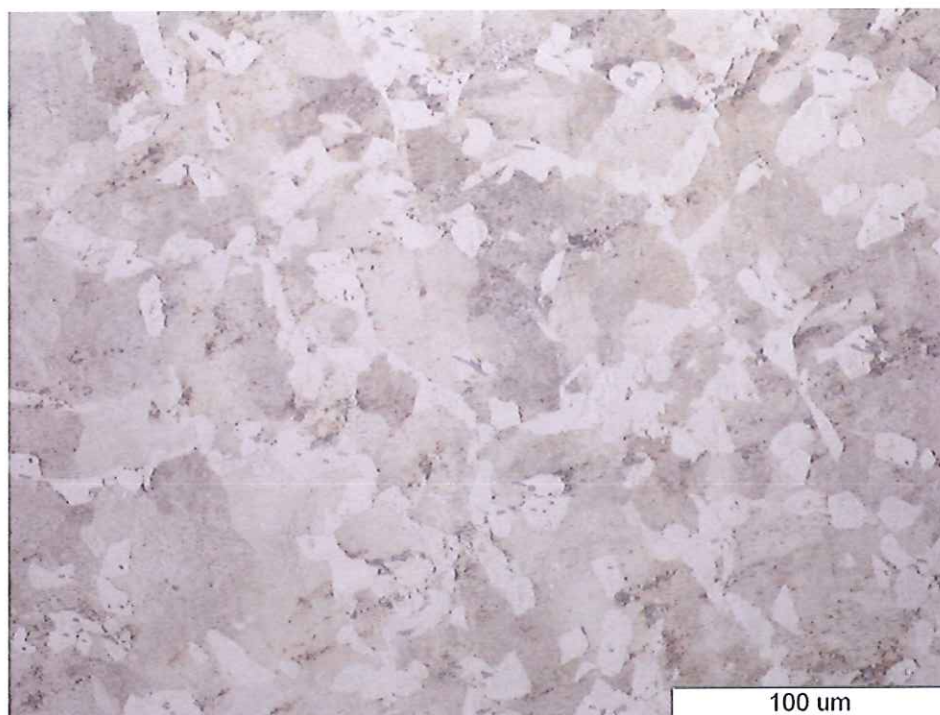
Slika 23. Mikrostruktura dosjednog ležaja koljenastog vratila na svjetlosnom mikroskopu pod povećanjem 500x
