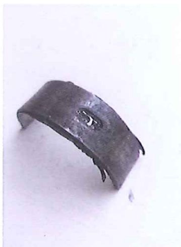
Slika 28. Prikaz otvora na podnožju ležaja koje služi za podmazivanje rotacijskih dijelova u radu motora
