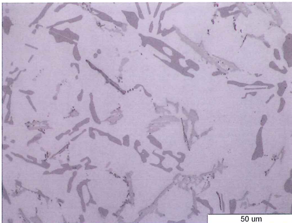
Slika 42. Mikrostruktura klipa na svjetlosnom mikroskopu pod povećanjem 1000x
