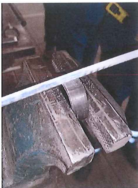
Slika 30. Rezanje ležaja za analizu mikrostrukture
