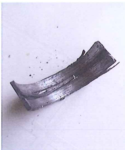
Slika 17. Istrošenost kliznog ležaja 1.4 TDI motora
