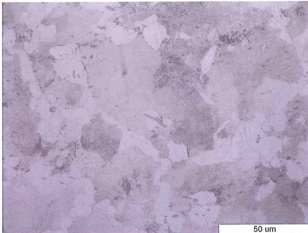
Slika 24. Mikrostruktura dosjednog ležaja koljenastog vratila na svjetlosnom mikroskopu pod povećanjem 1000x
