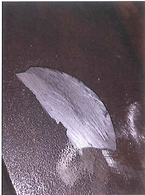
Slika 38. Uzorak odrezan s klipa
