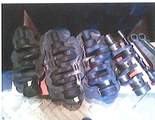
Slika 3. Izrada kovanog koljenastog vratila [6]
