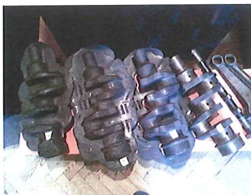
Slika 3. Izrada kovanog koljenastog vratila [6]
