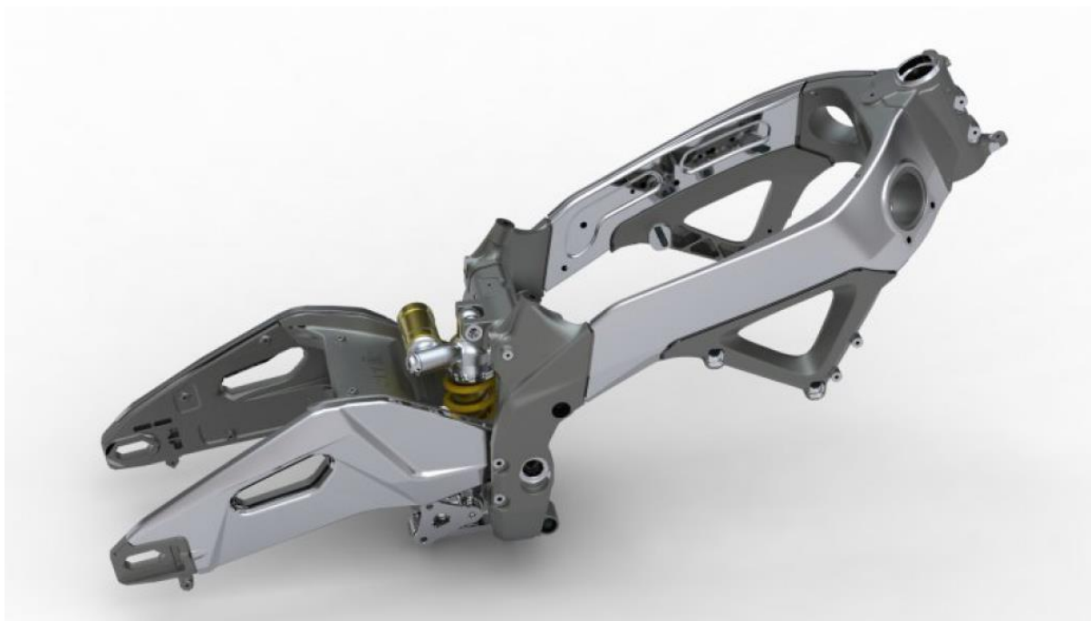
Slika 19: Aluminijska šasija izvedena s mnogo vijčanih spojeva [9]
