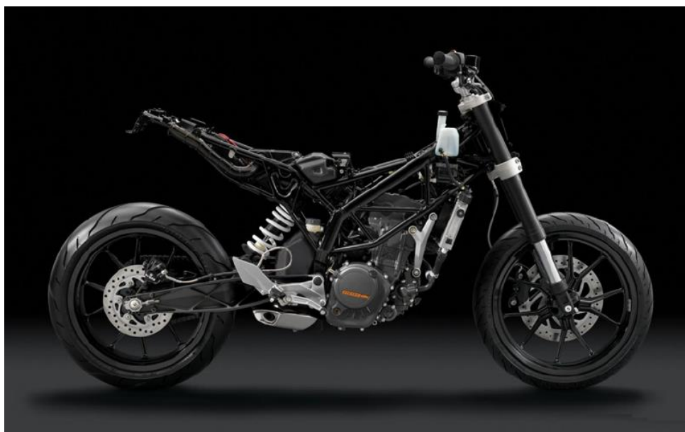
Slika 7: „Trellis“ triangulirana šasija – KTM Duke 200 [1]
