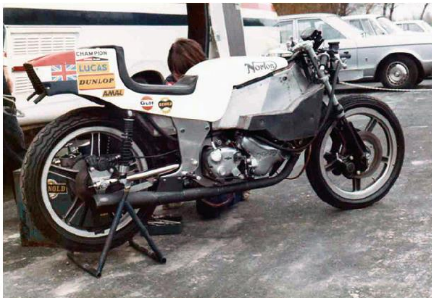
Slika 10: Monocoque šasija John Norton, 1973. godina [1]
