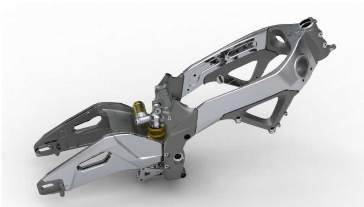
Slika 19: Aluminijska šasija izvedena s mnogo vijčanih spojeva [9]
