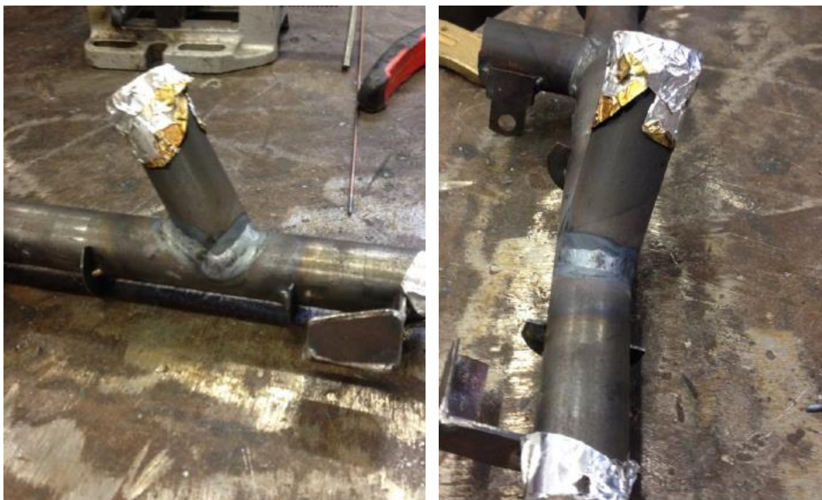
Slika 42: Zavareni spoj netom nakon zavarivanja
