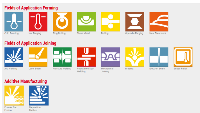
Slika 29: Prikaz postupaka koji se mogu simulirati koristeći Simufact [20]
