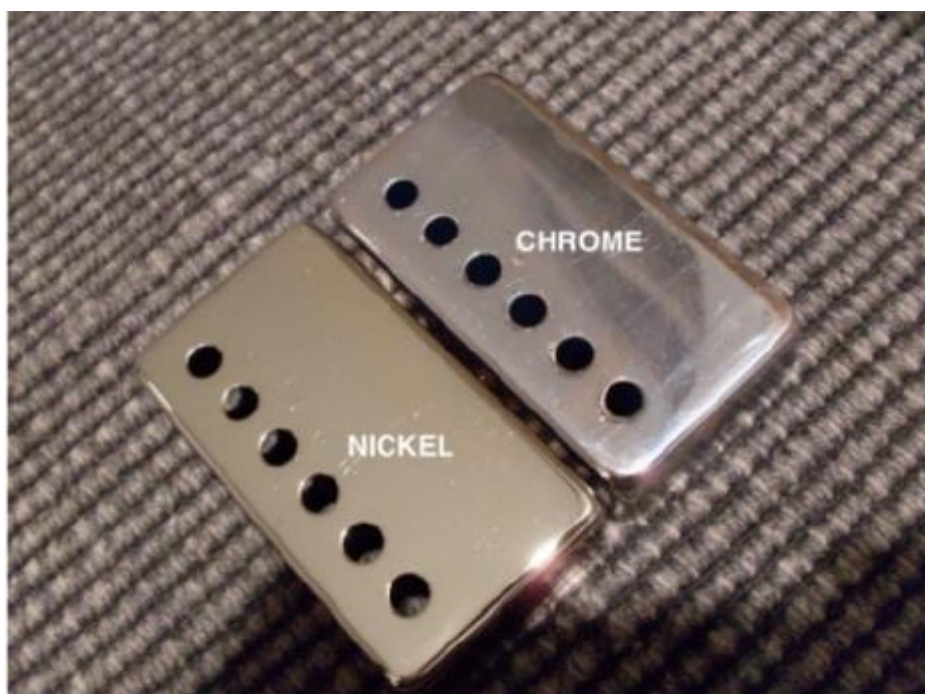
Slika 22: Primjer niklane i kromirane pločice [11]
