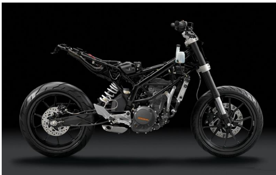
Slika 7: „Trellis“ triangulirana šasija – KTM Duke 200 [1]
