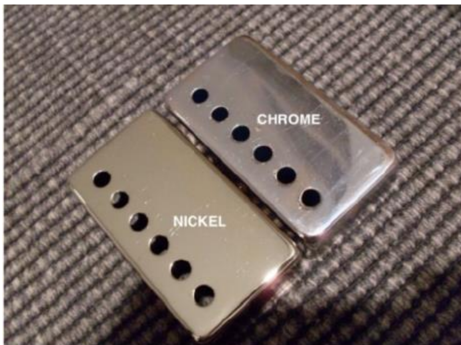
Slika 22: Primjer niklane i kromirane pločice [11]
