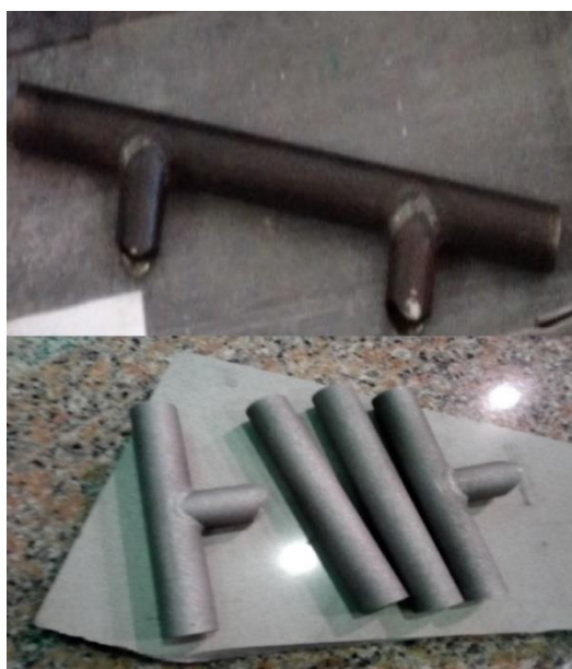
Slika 46: Uzorci prije i nakon rezanja i sačmarenja
