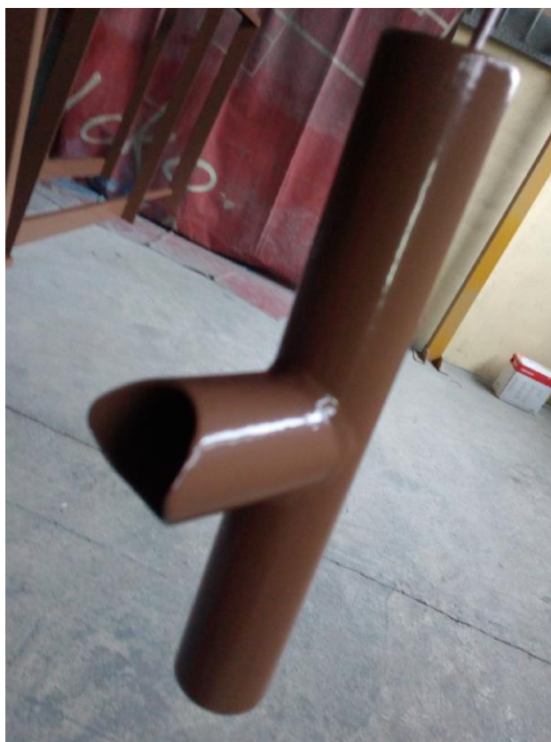
Slika 49: Zaštita postupkom elektrostatskog nanošenja praška
