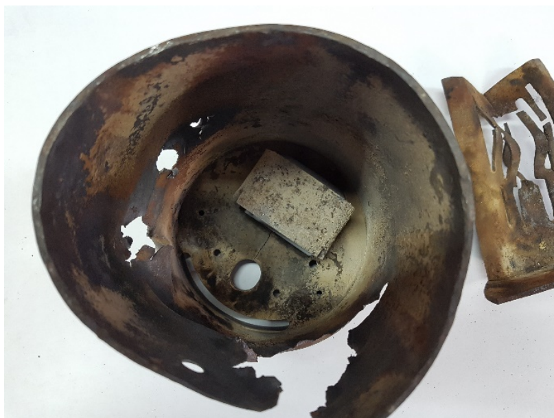
Slika 19. Prikaz oštećenja unutrašnjosti plamenika
