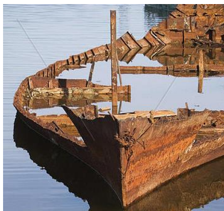
Slika 15: Plovilo uništeno korozijom.
