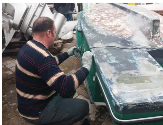
Slika 21: Brušenje gaza plovila na suhom vezu.
