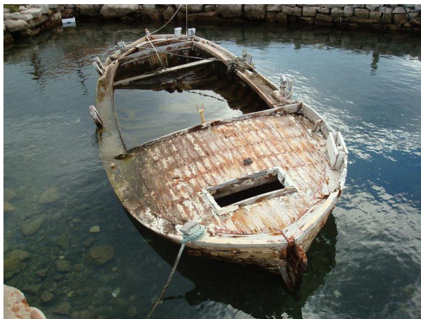
Slika 17: Istrunulo drveno plovilo.
