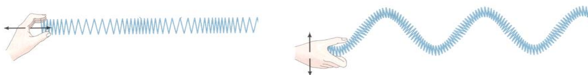
Slika 4: Načini širenja valova a) transversalni valovi b) longitudinalni valovi [9].
