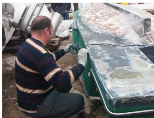
Slika 21: Brušenje gaza plovila na suhom vezu.
