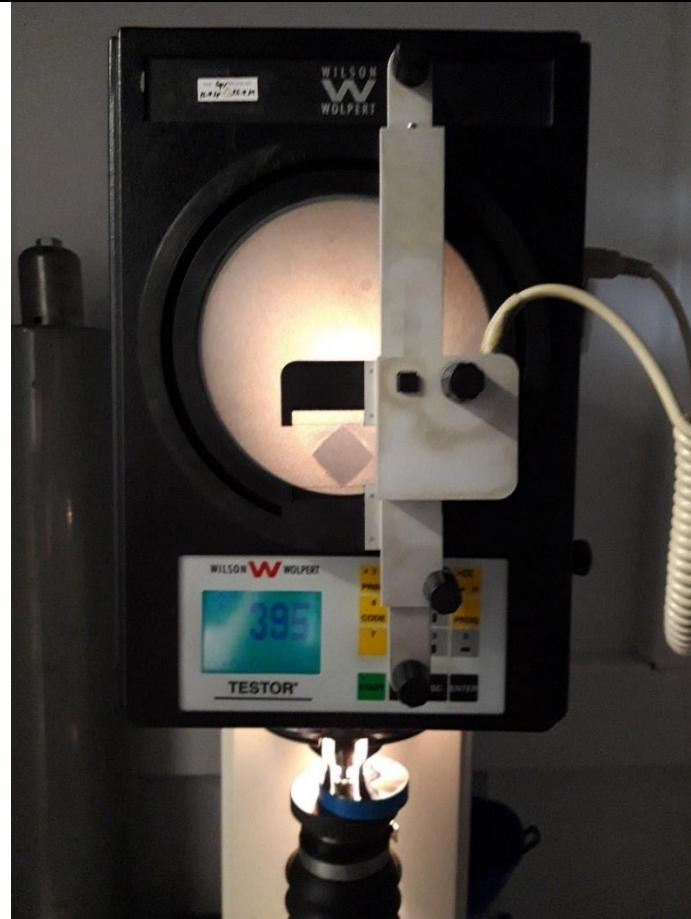
**Slika 22** Primjer korištenog tvrdomjera kod laboratorijske 3
