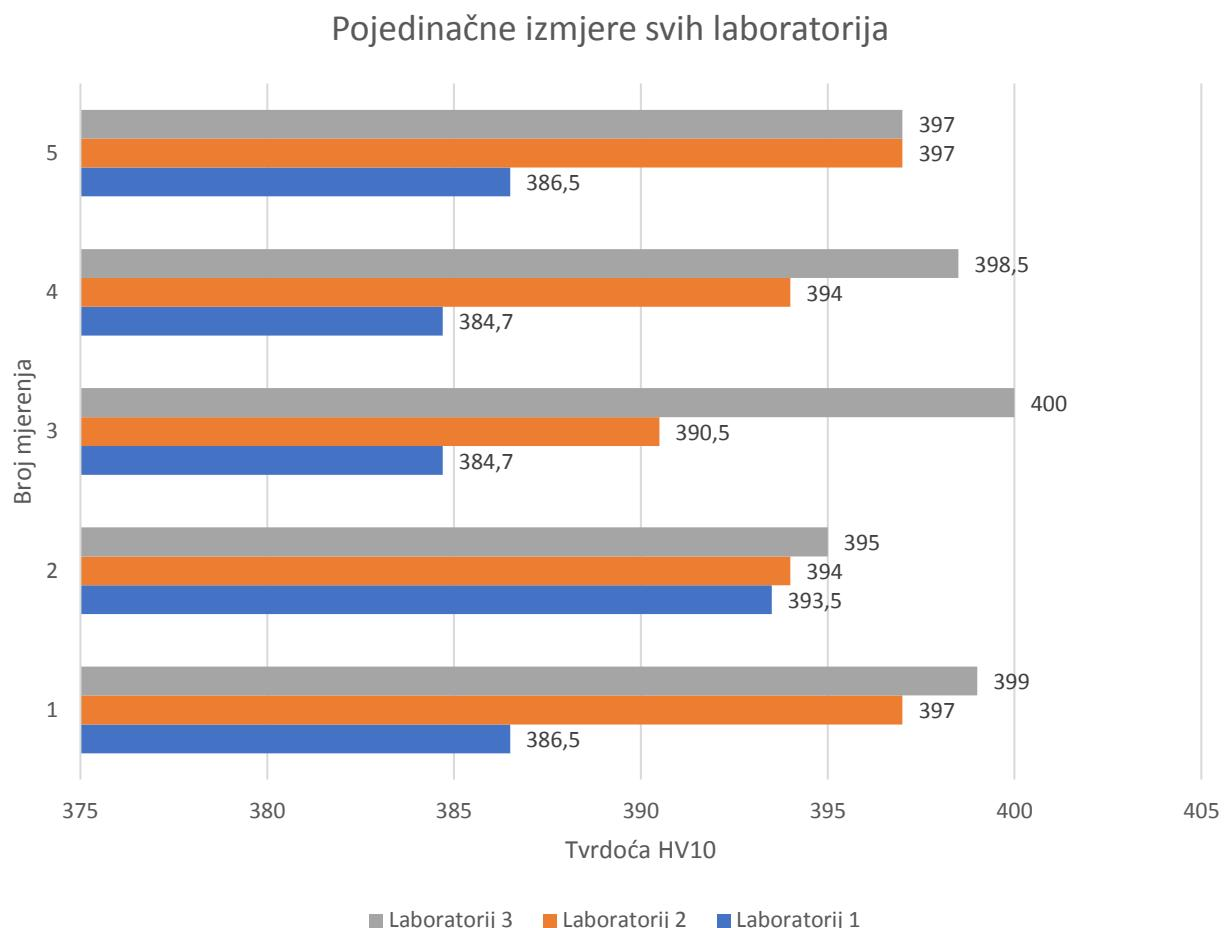
**Slika 24** Grafički prikaz pojedinačnih mjerena tvrdoće svih laboratorijskih mjerjenja
