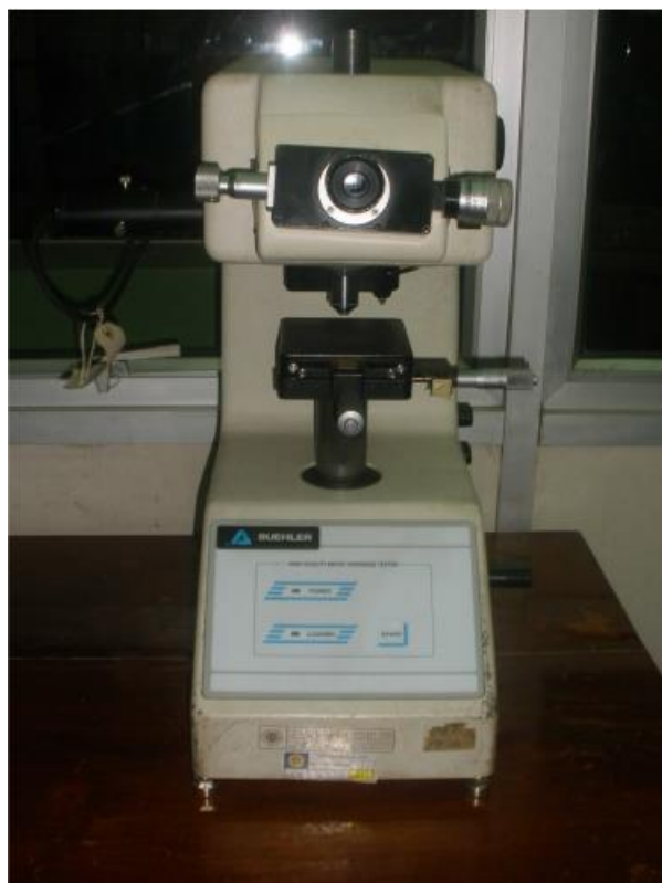
Slika 18 Primjer korištenog tvrdomjera u laboratoriju 1
