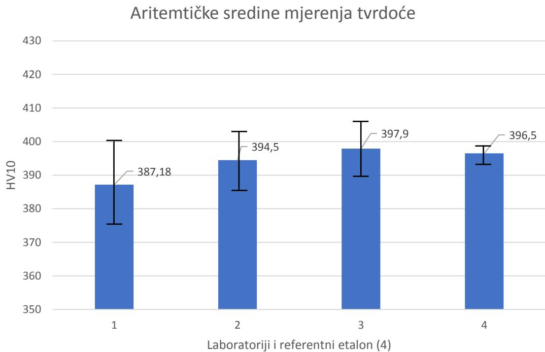
**Slika 25** Grafički prikaz aritmetičkih sredina mjerena tvrdoće svih laboratorija i referentnog etalona sa standardnim odstupanjem
