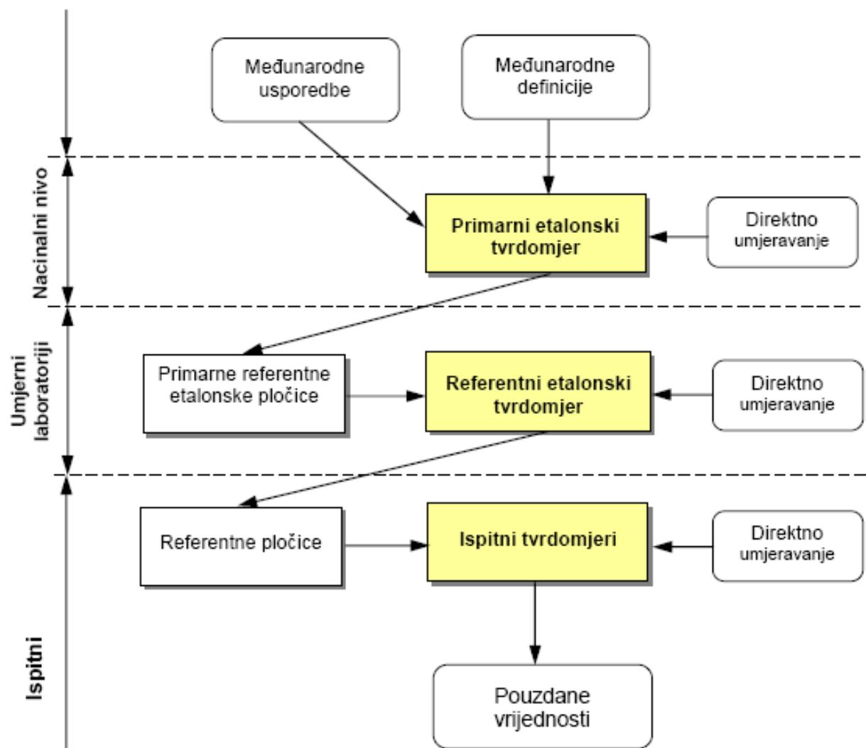
Slika 8 Mjerna sljedivost mjerne veličine tvrdoće [5]
