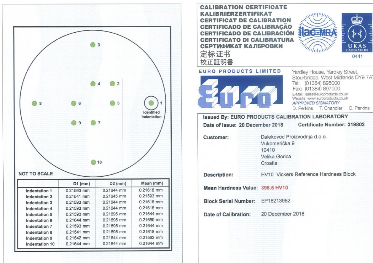
Slika 13 Kalibracijski certifikat referentnog etalona [13]
