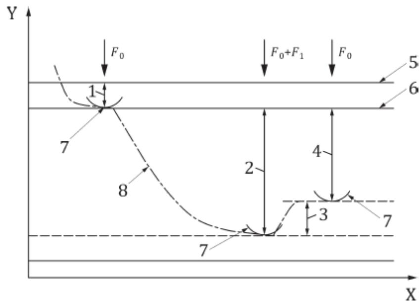
**Slika 2** Postupak mjerena tvrdoće po Rockwellu [4]
