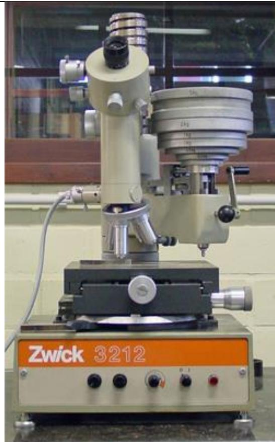
**Slika 20** Primjer korištenog tvrdomjera kod laboratoriјa 2
