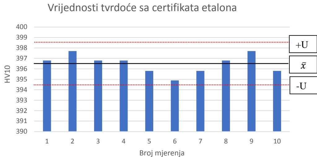
**Slika 23** Vrijednosti tvrdoće referentnog etalona tvrdoće
