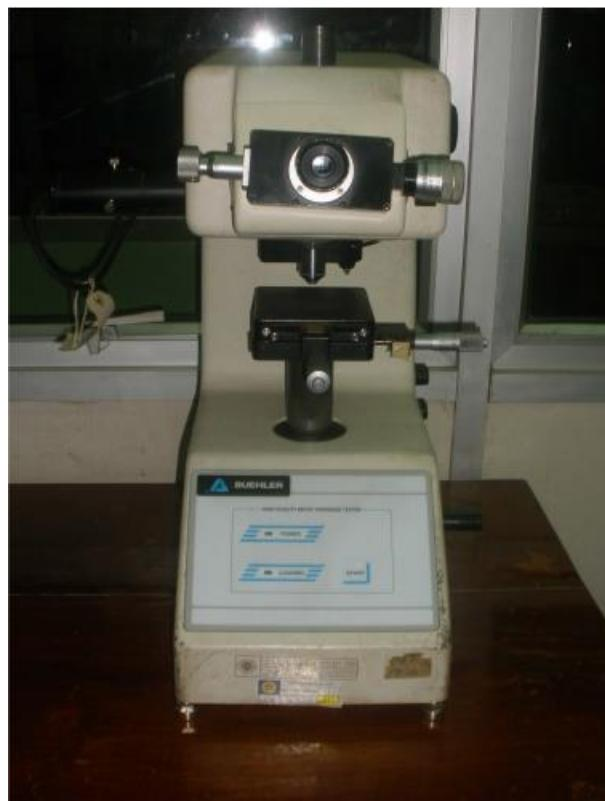
**Slika 18** Primjer korištenog tvrdomjera u laboratorijski 1
