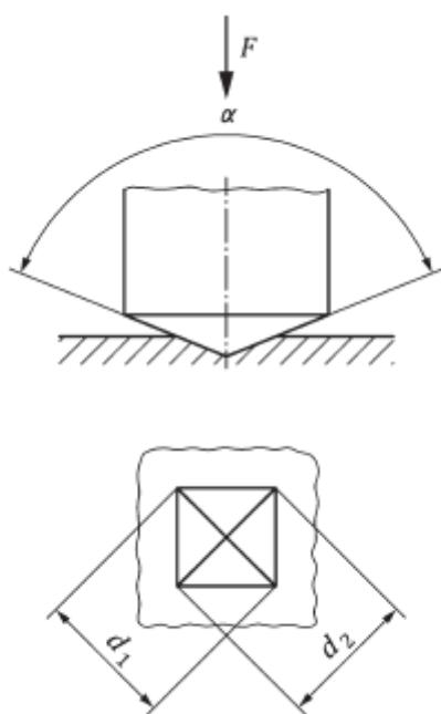
**Slika 4** Postupak mjerenja tvrdoće po Vickersu [6]
