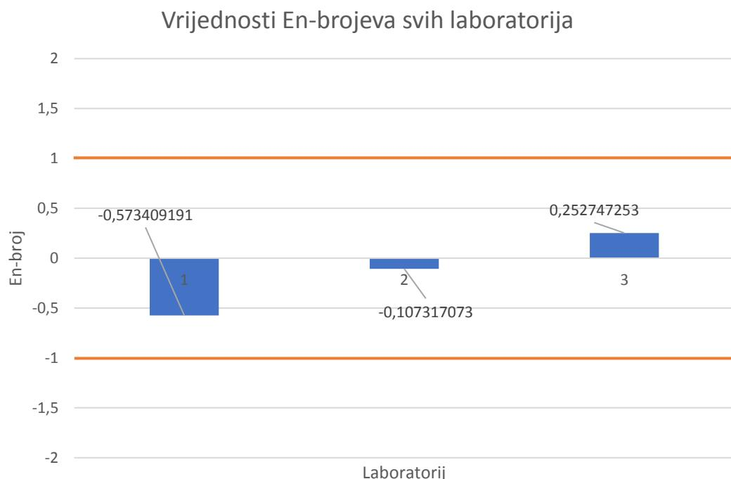
**Slika 28** Vrijednosti  $E_n$ -brojeva svih laboratorijskih rezultata
