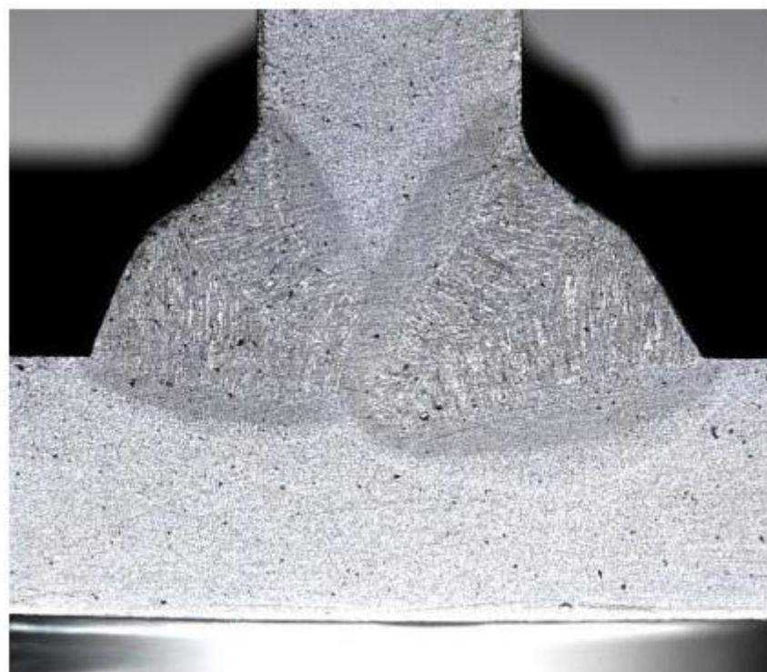
**Slika 29. Kutni spoj debljine 8 mm s potpunom penetracijom izведен RMT postupkom [43]**
