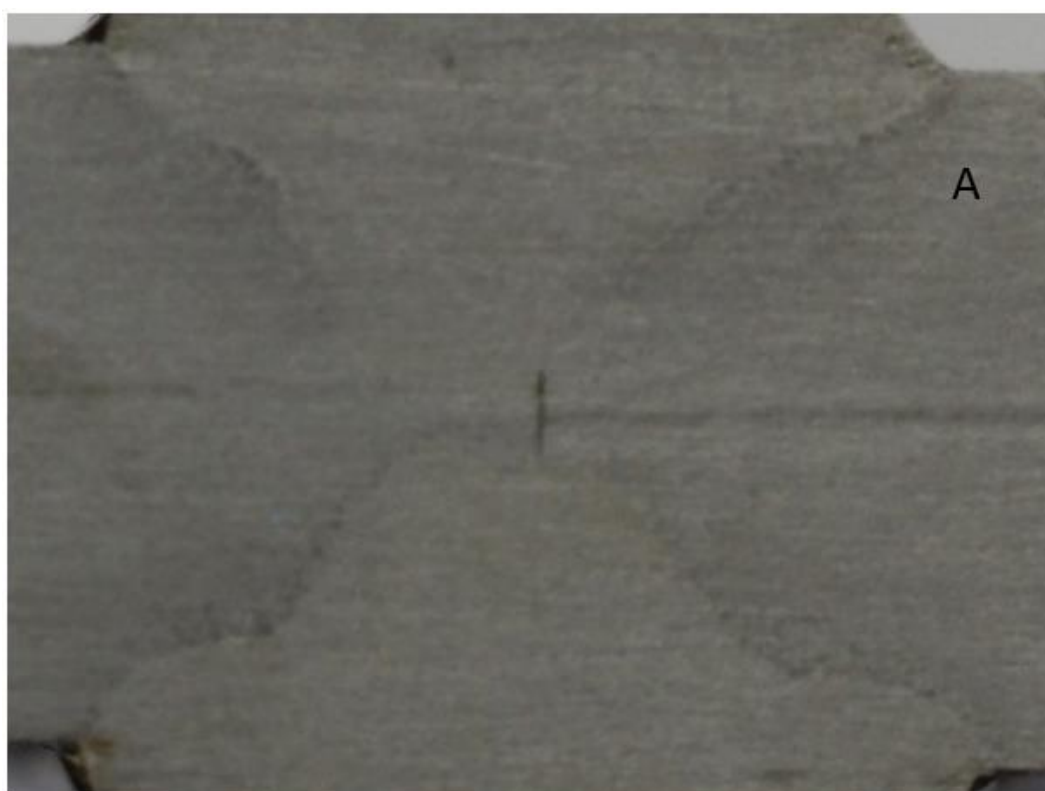
Slika 80. Nepotpuni provar uzorka A
