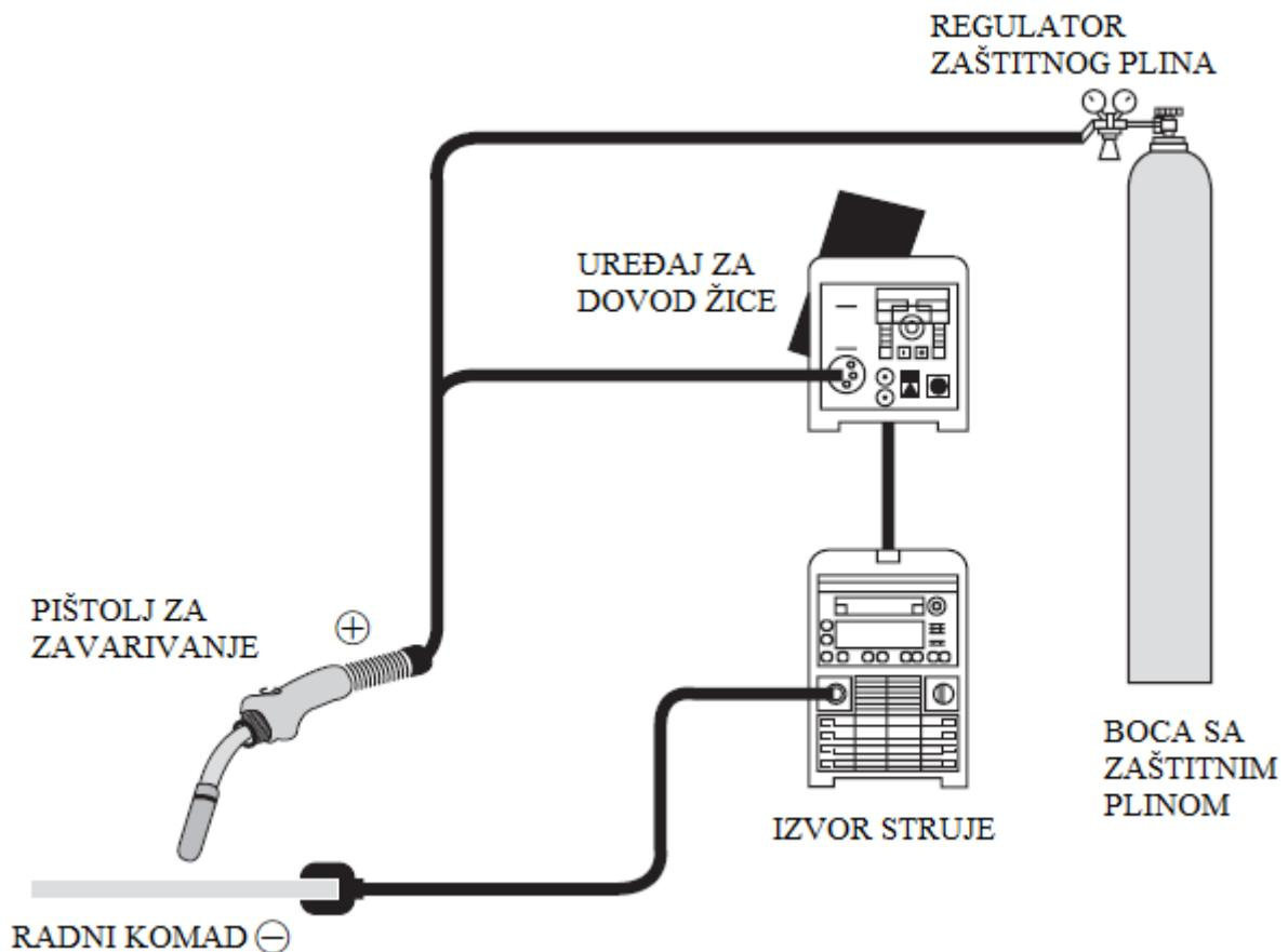
Slika 2. Oprema za MIG/MAG postupak zavarivanja [5]
