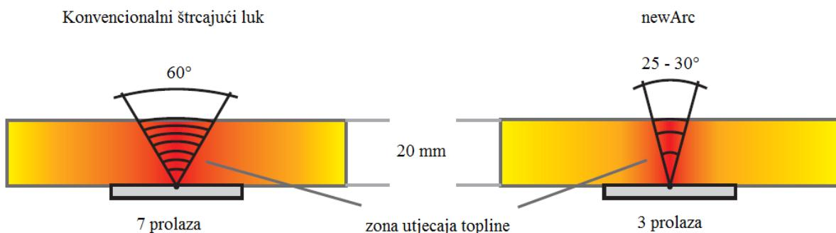
**Slika 43. Usporedba konvencionalnog štrcajućeg luka i newArc postupka s obzirom na kut pripreme spoja, broj prolaza i ZUT [56]**
