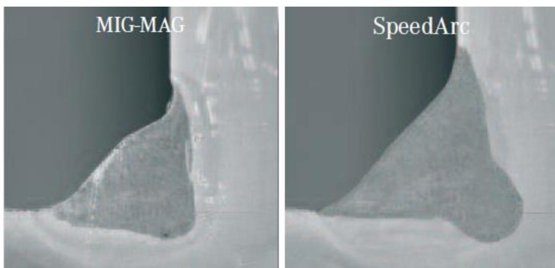
**Slika 40. Usporedba dubine penetracije na kutnom spoju između SpeedArc varijante i konvencionalnog MIG/MAG zavarivanja [54]**
