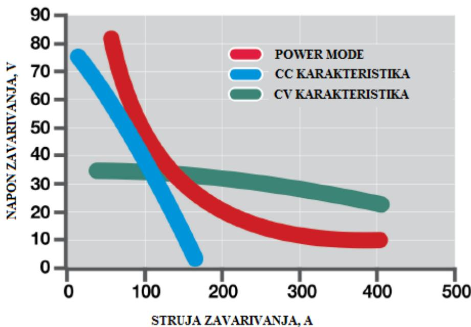
Slika 24. Prikaz statičke karakteristike Power Mode postupka zavarivanja [40]
