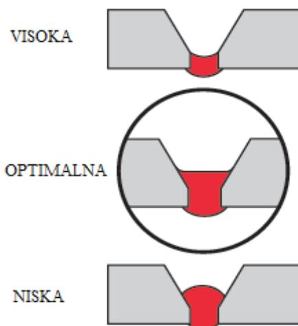
**Slika 18. Utjecaj vršne struje na geometriju zavarenoga spoja [33]**
