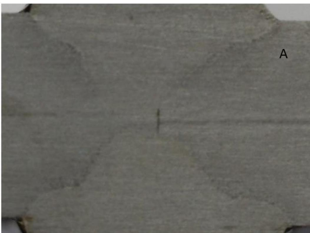
Slika 80. Nepotpuni provar uzorka A
