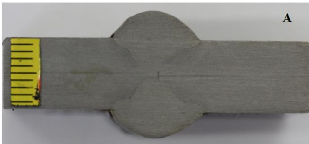
Slika 77. Makroizbrusak uzorka A
