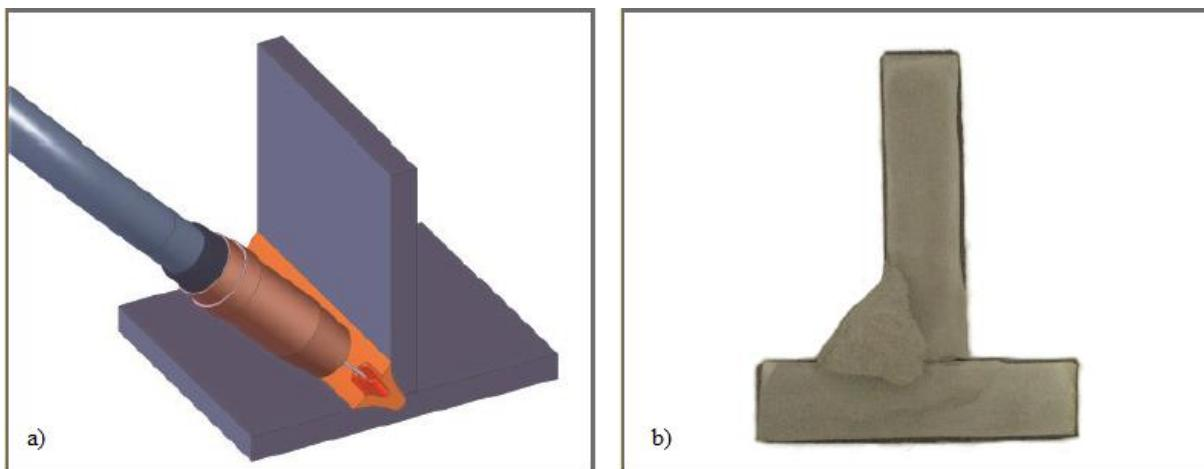
**Slika 44.** Primjena newArc postupka na kutnomy spoju: a) vođenje pištolja; b) izgled gotovog zavarenog spoja [56]
