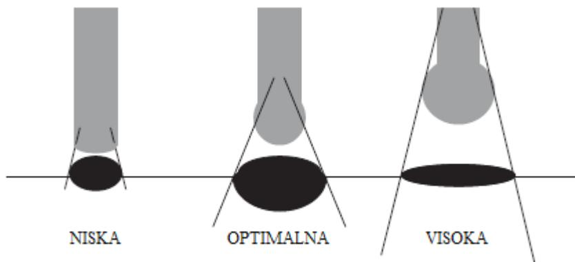
**Slika 19. Utjecaj osnovne struje na geometriju zavarenoga spoja [32]**
