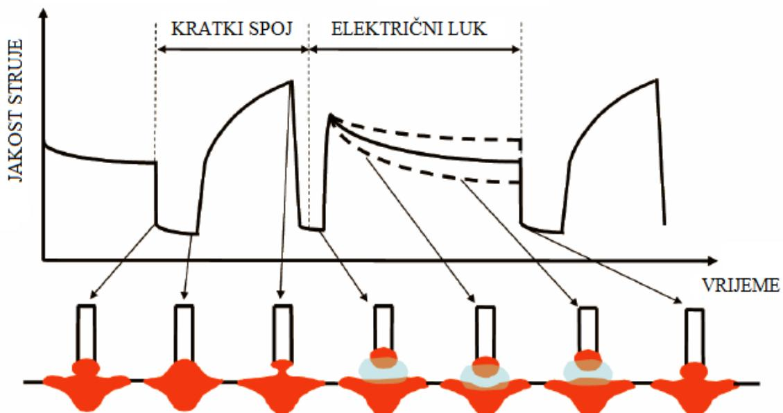
**Slika 8. Princip rada CBT MIG/MAG postupka zavarivanja [18]**
