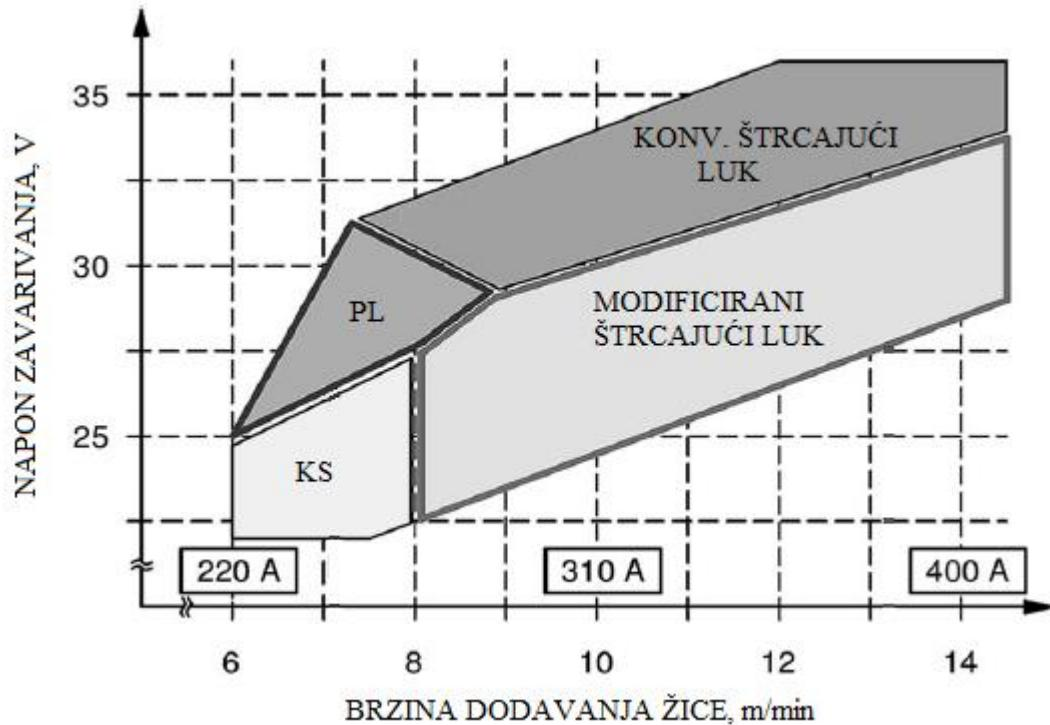
Slika 22. Radno područje modificiranoga štrcajućega luka u odnosu na područje parametara konvencionalnog štrcajućeg luka, prijelaznoga luka (PL) te kratkih spojeva (KS) [37]
