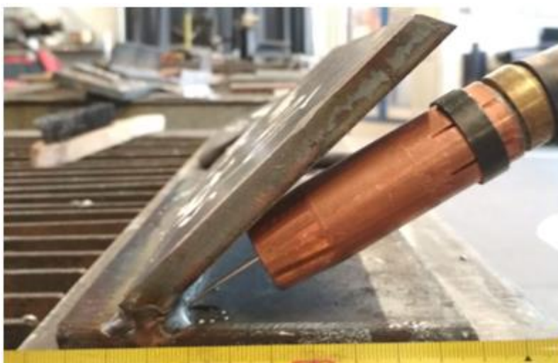
Slika 72. Položaj pištolja u žlijebu s kutom od 45^\circ
