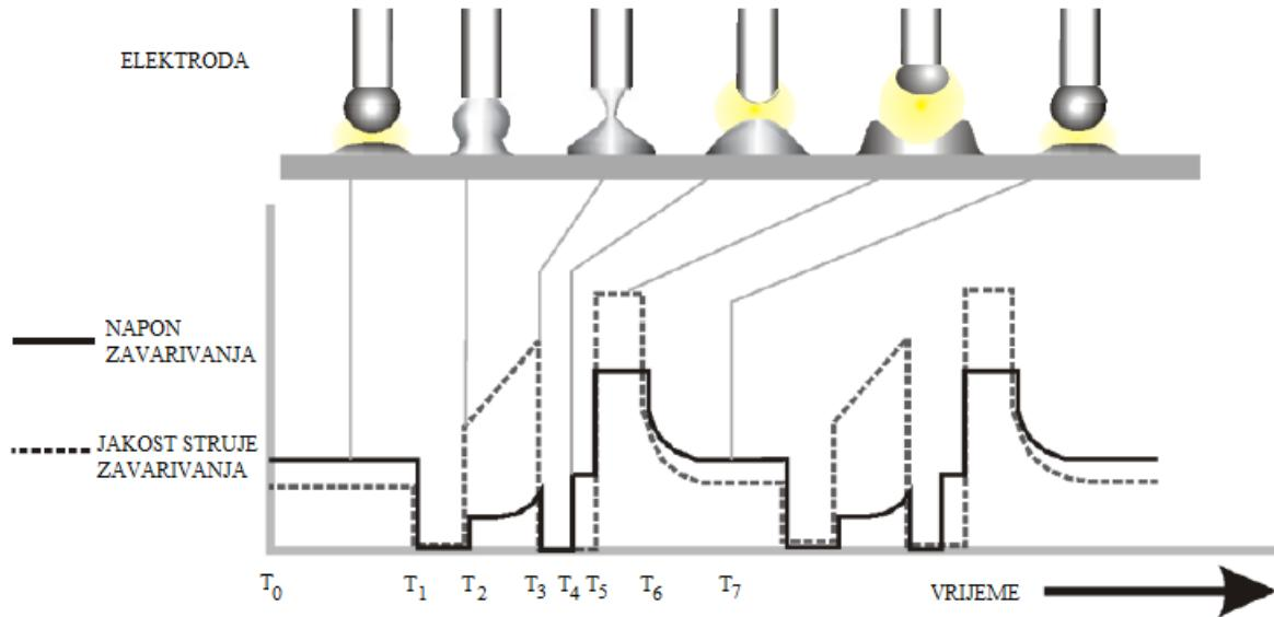
Slika 20. Prikaz dinamičke karakteristike STT procesa zavarivanja [34]
