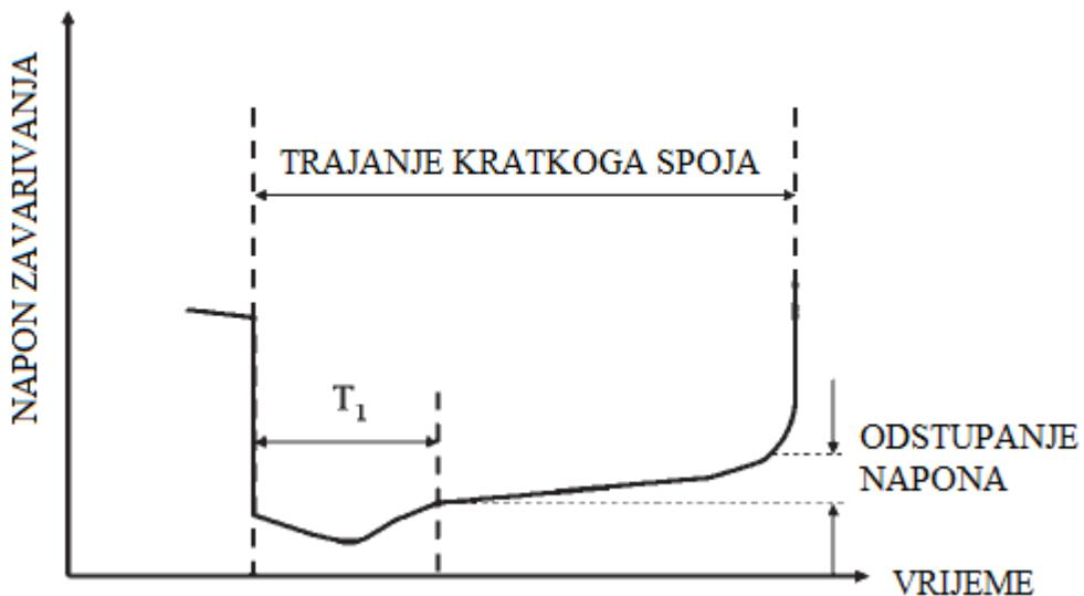
**Slika 9. Princip preciznoga predviđanja ponovne uspostave električnoga luka [20]**
