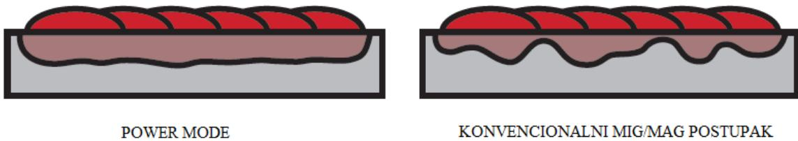
**Slika 26. Usporedba penetracijskog profila postupka Power Mode i konvencionalnoga MIG/MAG postupka [42]**
