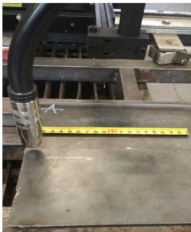
Slika 67. Prikaz položaja pištolja tijekom zavarivanja sučeljenog spoja
