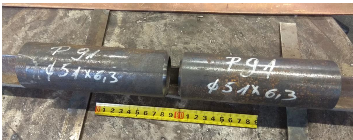
Slika 27. Izgled cijevi prije zavarivanja
