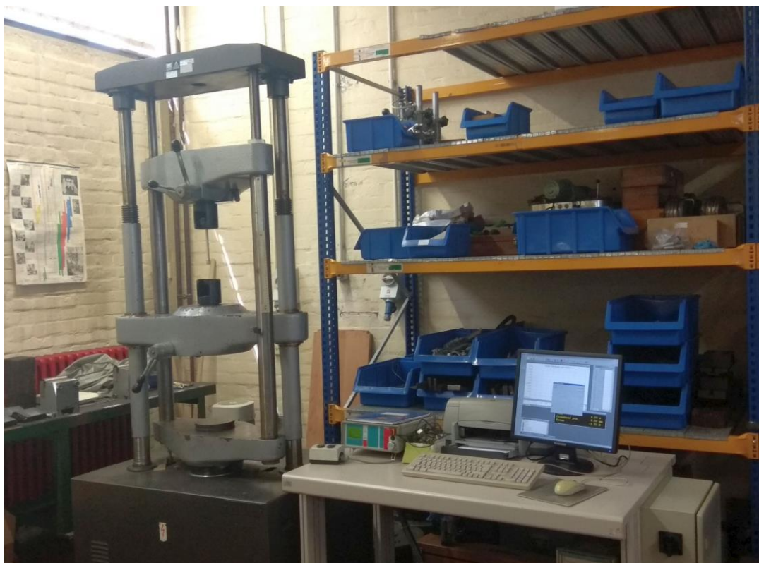
Slika 49. Oprema korištena za provođenje statičkog vlačnog ispitivanje
