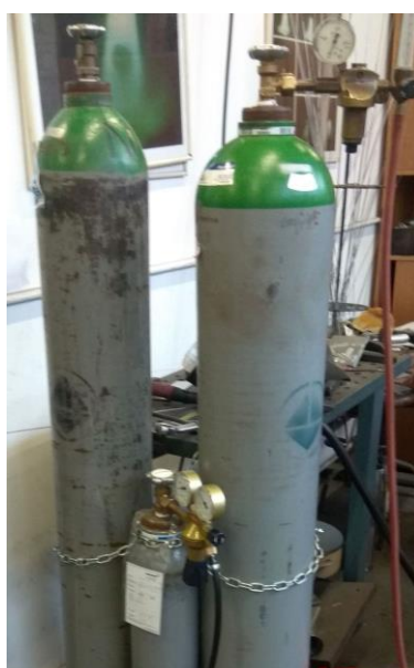
Slika 28. Čelične boce s korištenim zaštitnim plinovima
