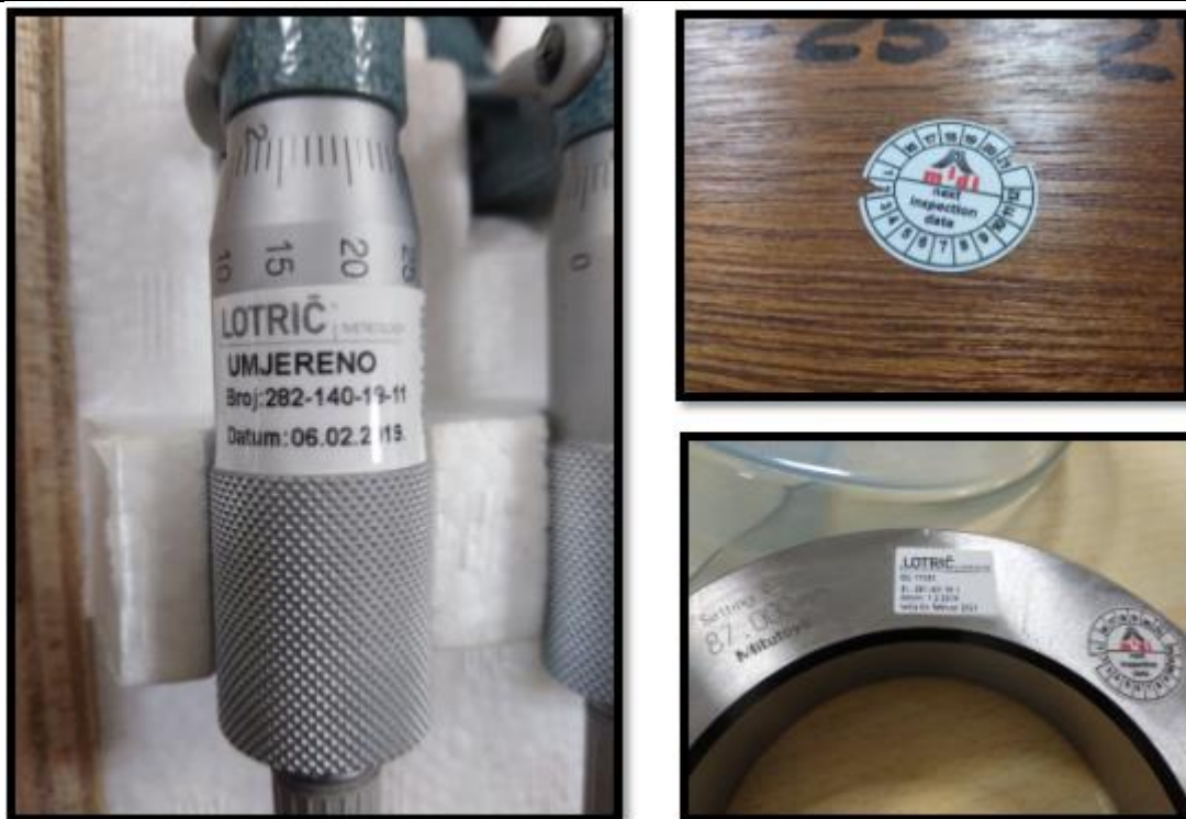
Slika 6 Prikaz oznaka o umjeravanjima mjernih uređaja
