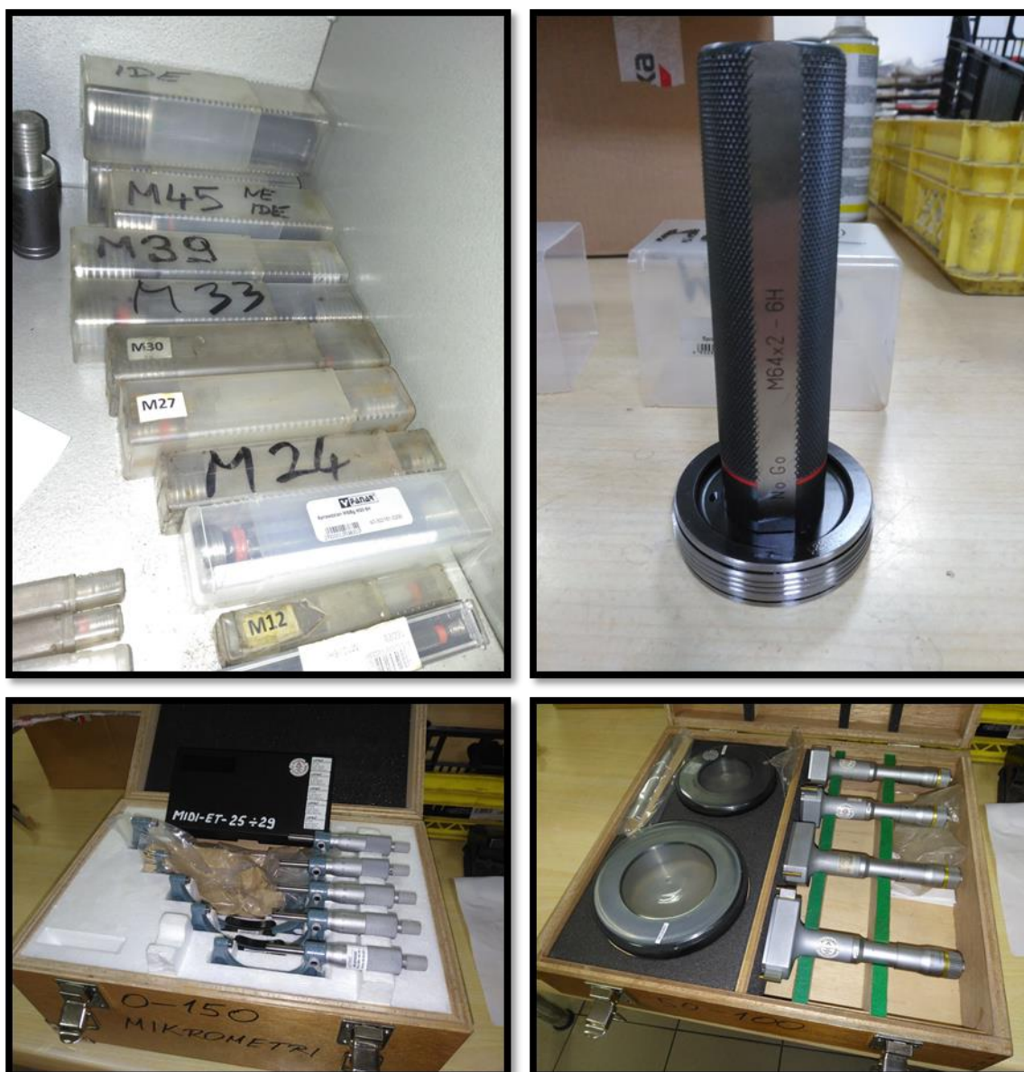
Slika 8 Prikaz skladištenja mjerne opreme, općenitog stanja i zaštitnih pakiranja
