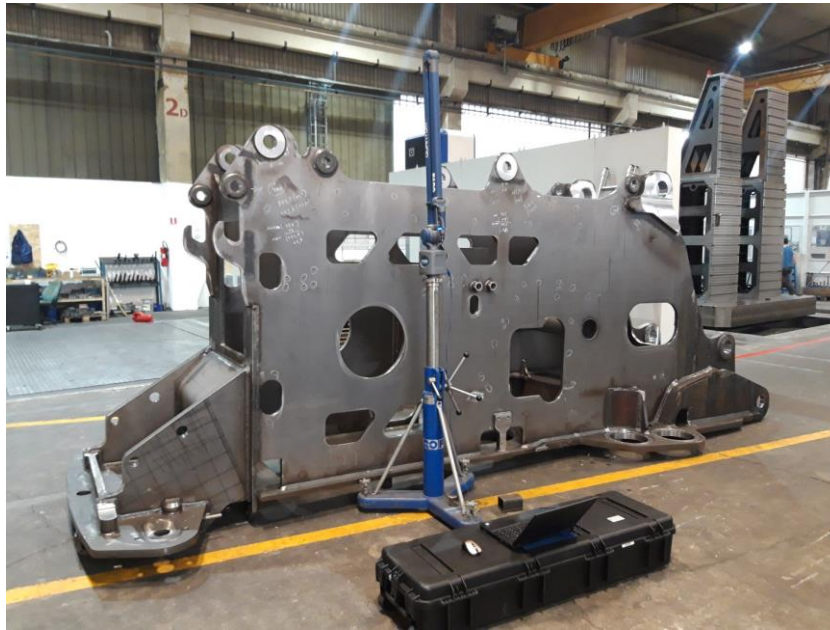
Slika 9 Prikaz trodimenzionalnog mjerenja mjernom rukom „FARO Arm“
