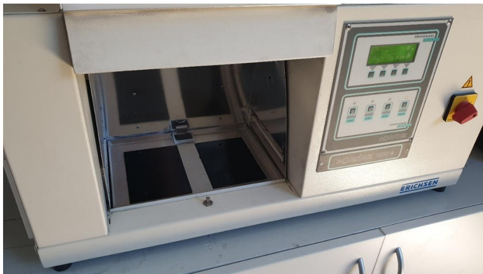
Slika 27. UV komora, Laboratorij za zaštitu materijala, FSB
