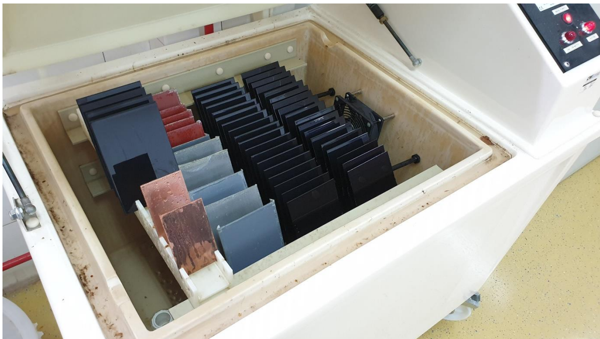
Slika 30. Ispitivanje uzoraka u vlažnoj komori
