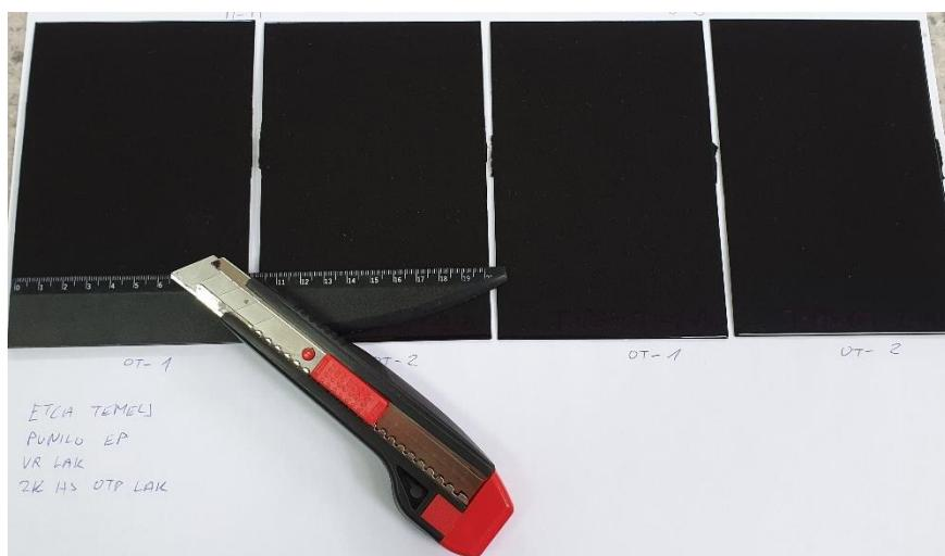
**Slika 32. Uzorci pripremljeni za ispitivanje u slanoj komori**
