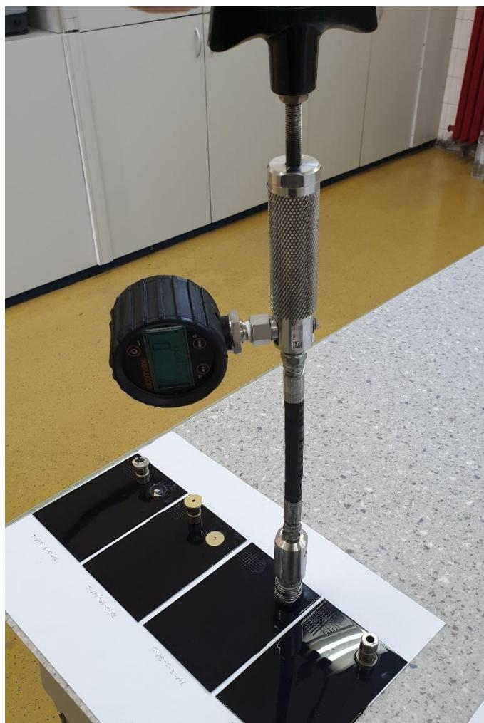
Slika 40. Ispitivanje prionjivosti Pull-off testom
