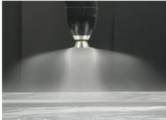
**Slika 8. Elektrostatički rotirajući atomizer [17]**
