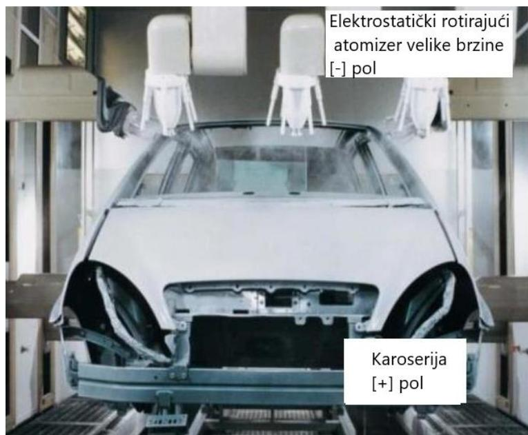
**Slika 9. Nanošenje premaza elektrostatičkim rotirajućim atomizerima [10]**
