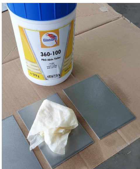
Slika 20. Fosfatiranje površine uzoraka maramicama, Glasurit 360-100 Pro Aktiv
