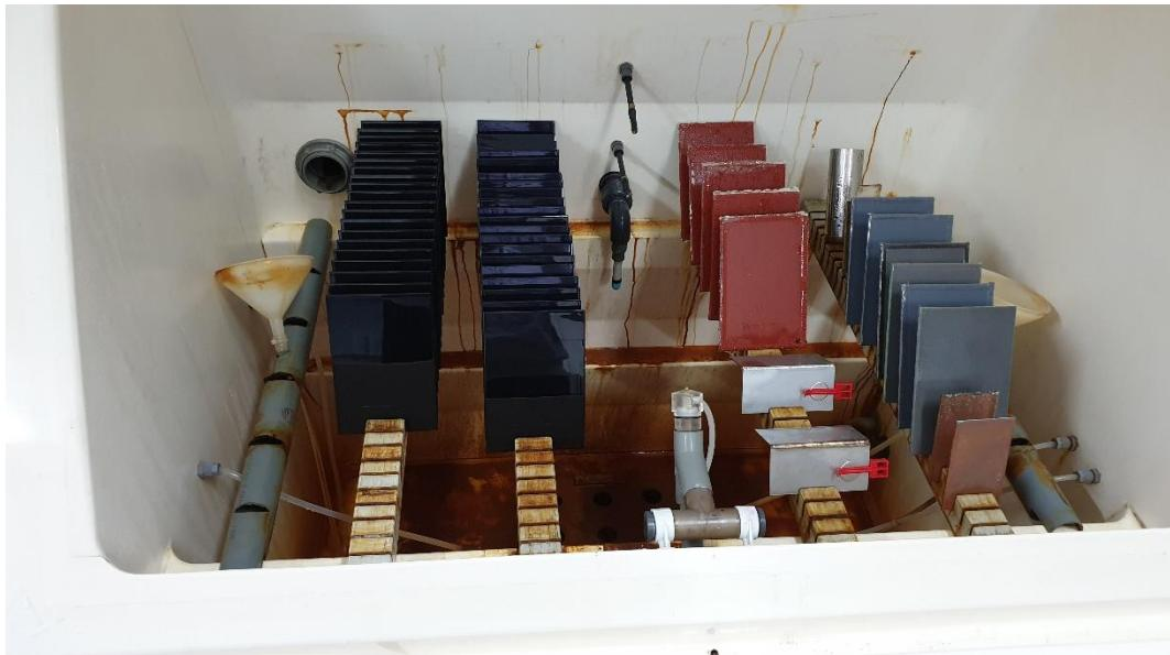
**Slika 31. Ispitivanje uzorka u slanoj komori**
