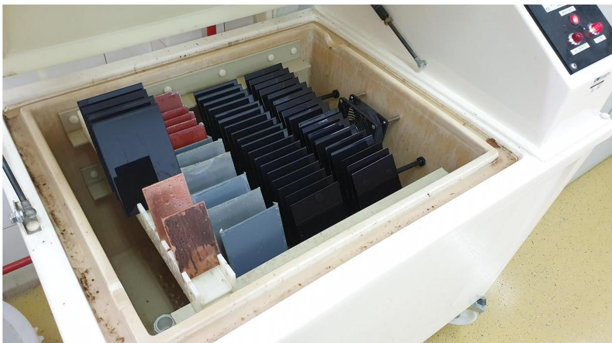
**Slika 30. Ispitivanje uzorka u vlažnoj komori**
