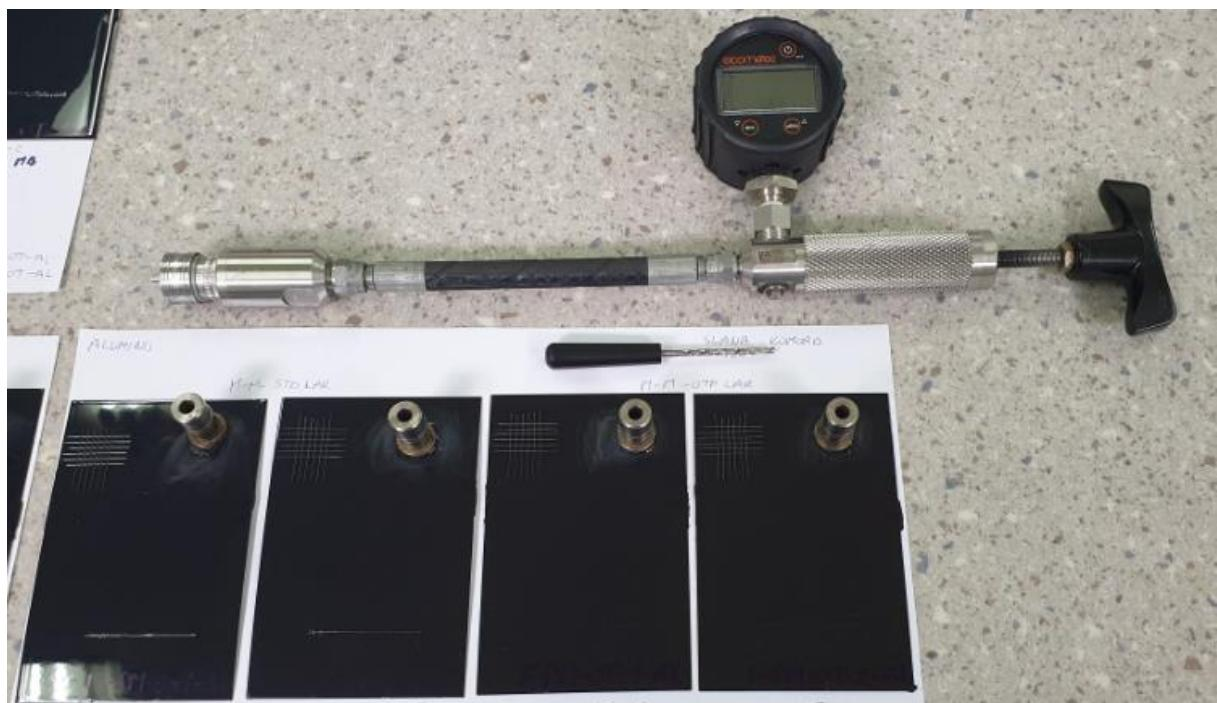
Slika 38. Lijepljenje testnih valjčića i uređaj za ispitivanje
