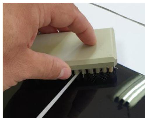
**Slika 36. Čišćenje površine četkom**
