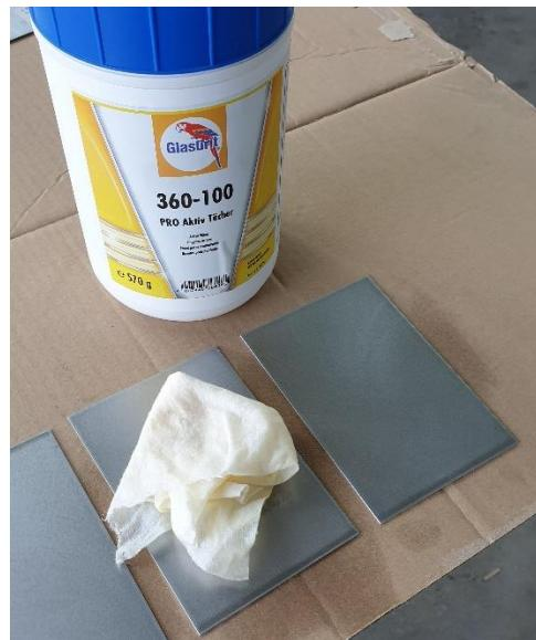
**Slika 20. Fosfatiranje površine uzorka maramicama, Glasurit 360-100 Pro Aktiv**
