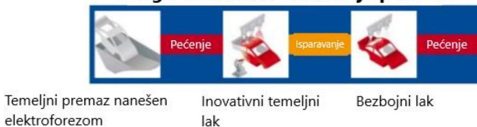
Slika 5. Integrirani sustav nanošenja premaza [14]
