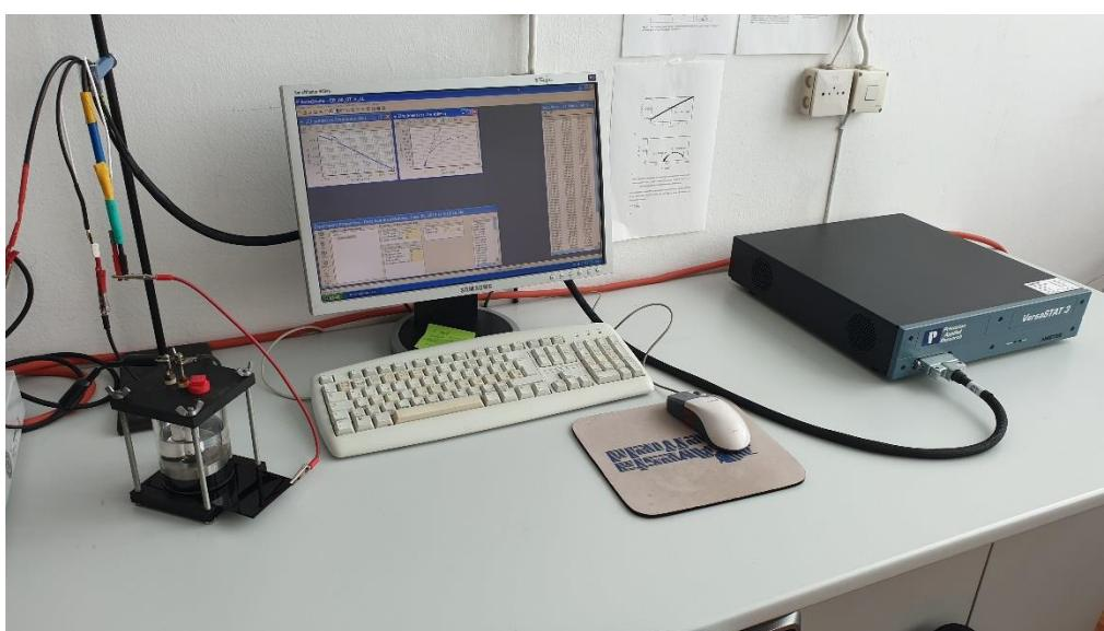
Slika 47. Ispitivanje elektrokemijskom impedancijskom spektroskopijom
