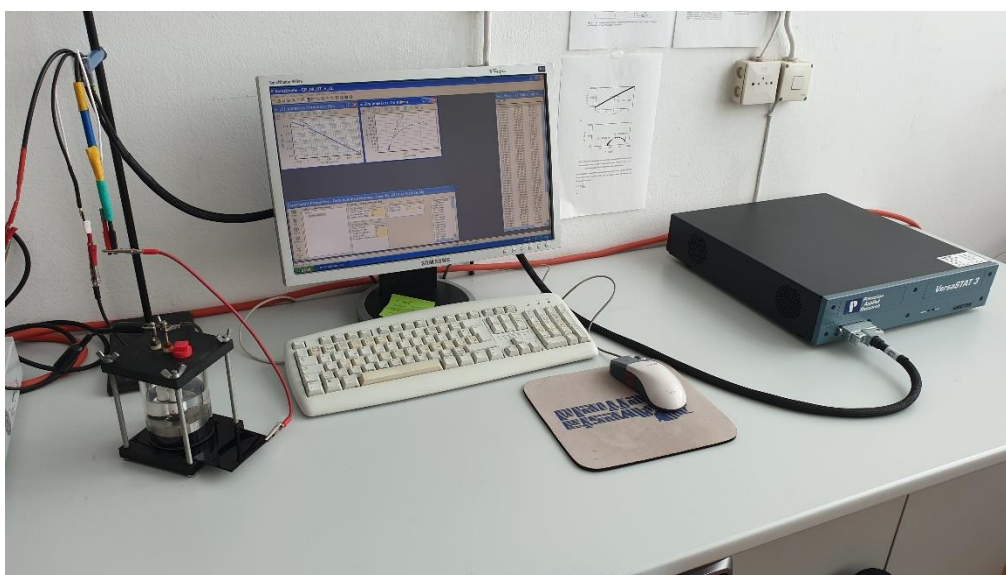
Slika 47. Ispitivanje elektrokemijskom impedancijskom spektroskopijom
