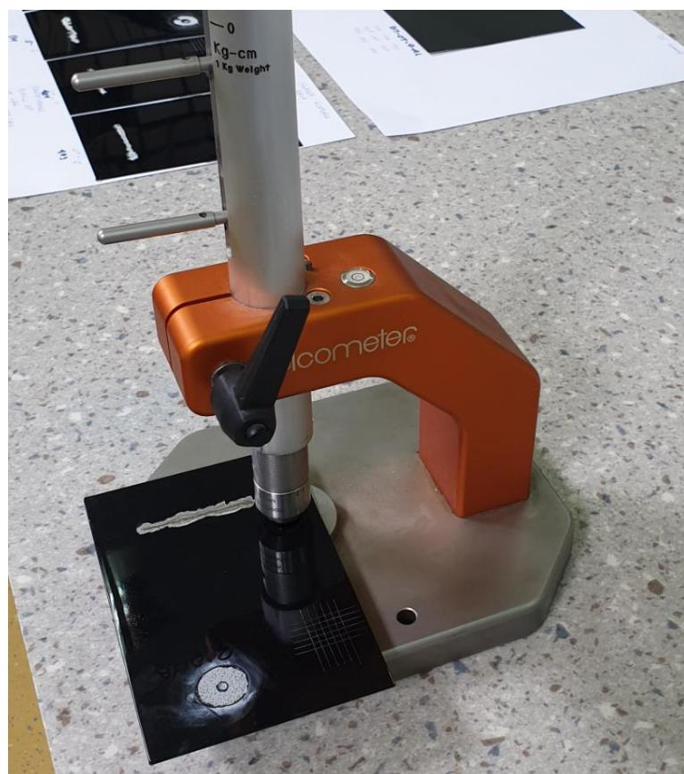
Slika 44. Ispitivanje otpornosti premaza na udar
