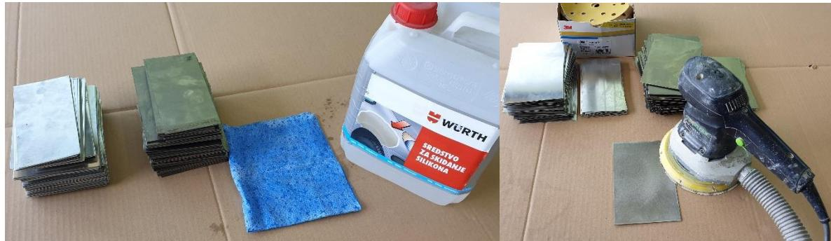
**Slika 19. Priprema uzorka prije nanošenja premaza**
