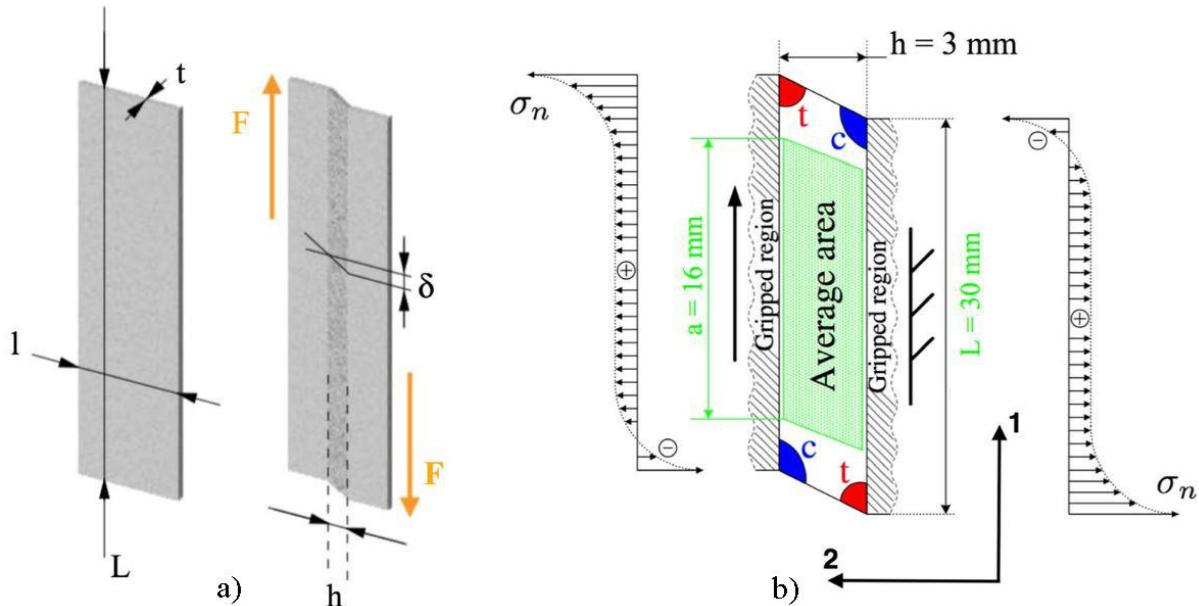
Slika 47. Uredaj za ispitivanje smika a) shematski prikaz, b) raspodjela naprezanja [50]
