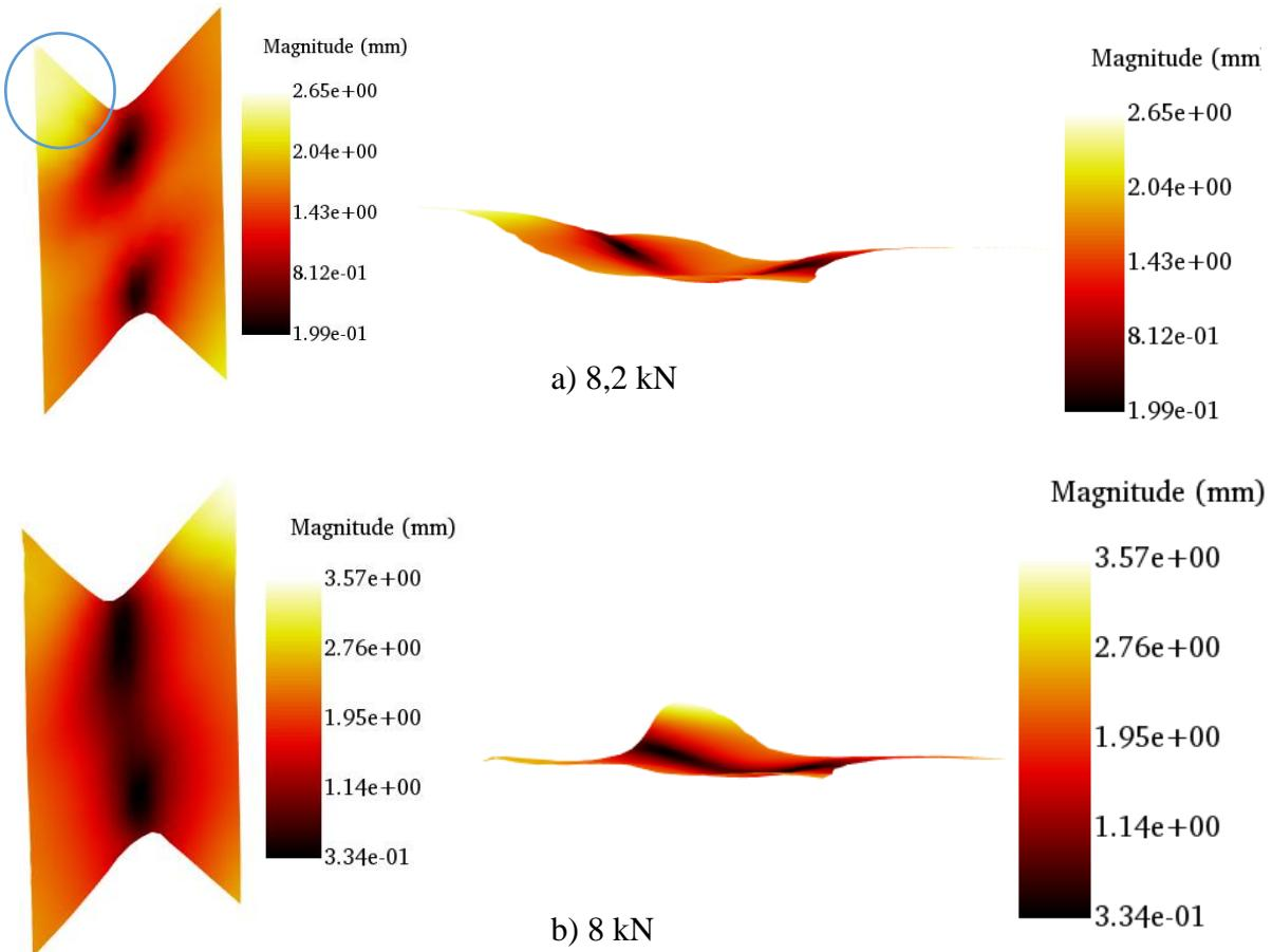
**Slika 79. Ukupni pomaci za statičko sмиčno ispitivanje uzorka E2**
