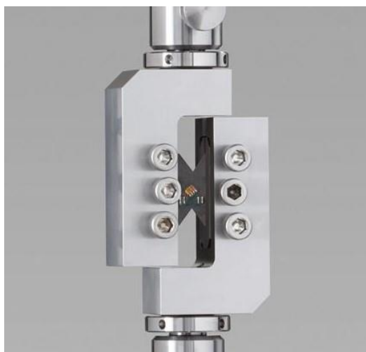
Slika 44. V – Notched Rail ispitni uređaj [48]
