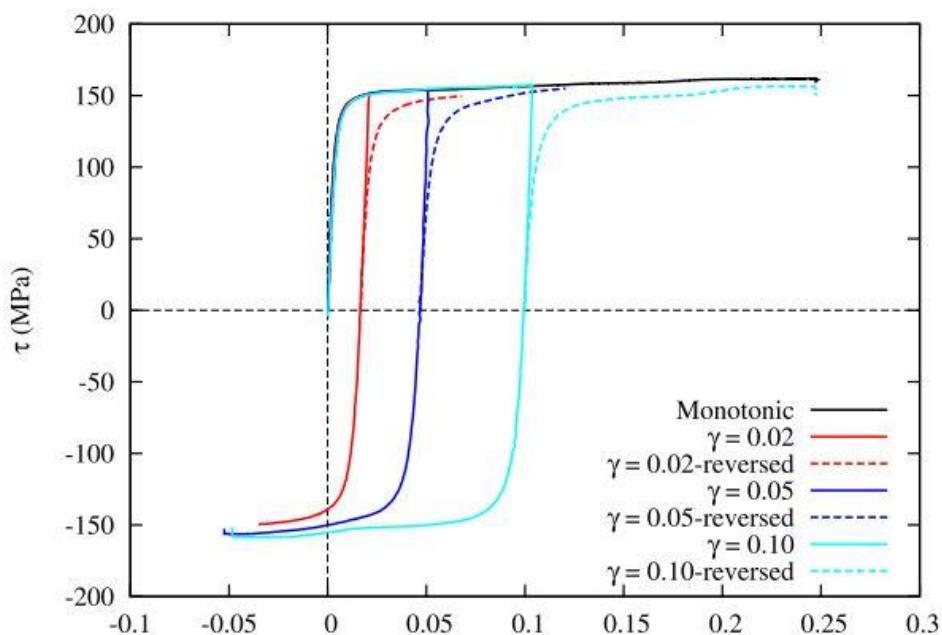
Slika 50. Prikaz Bauschingerovog efekta za čisti bakar [50]
