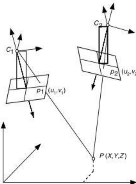
Slika 27. Princip stereovizije [26]
