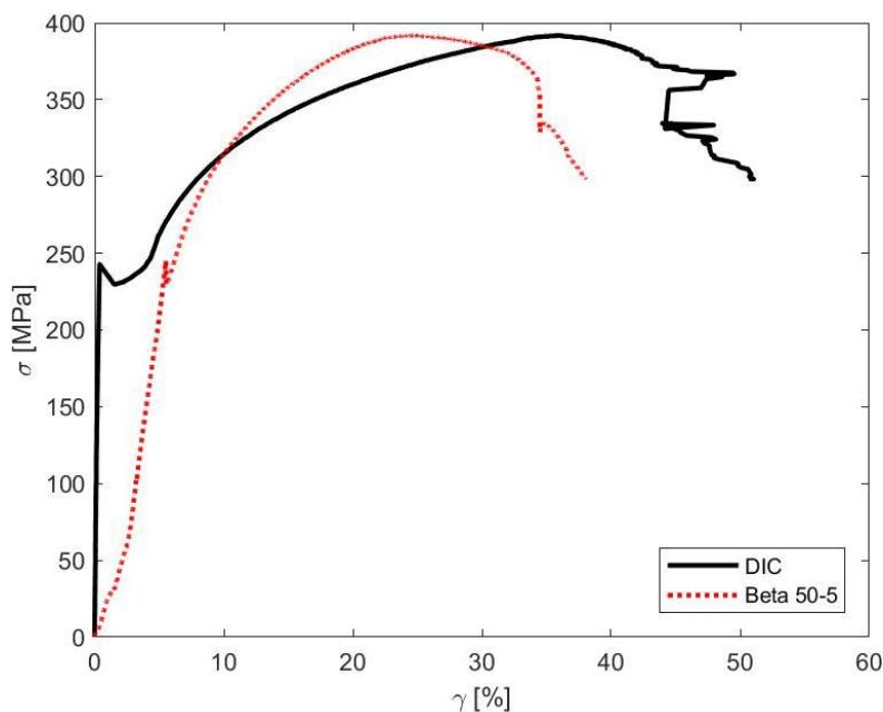
Slika 75. Krivulja inženjerskog naprezanja i izmjerene deformacije ispitnog uzorka E2
