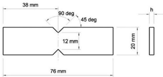
Slika 41. Standardni leptirasti uzorak za metodu ASTM D5379 [45]
