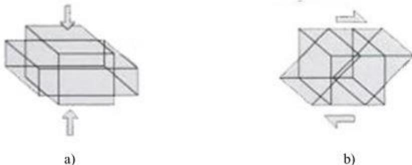
Slika 34. Primjer: a) čistog i b) jednostavnog smika [38]
