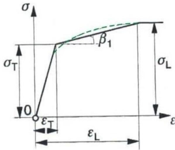
Slika 14. a) Elastično linearne očvršćujući materijal; b) elastično nelinearno očvršćujući materijal [11]
