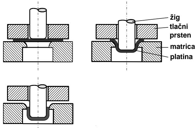
Slika 8. Postupak obrade limova dubokim vučenjem [9]
