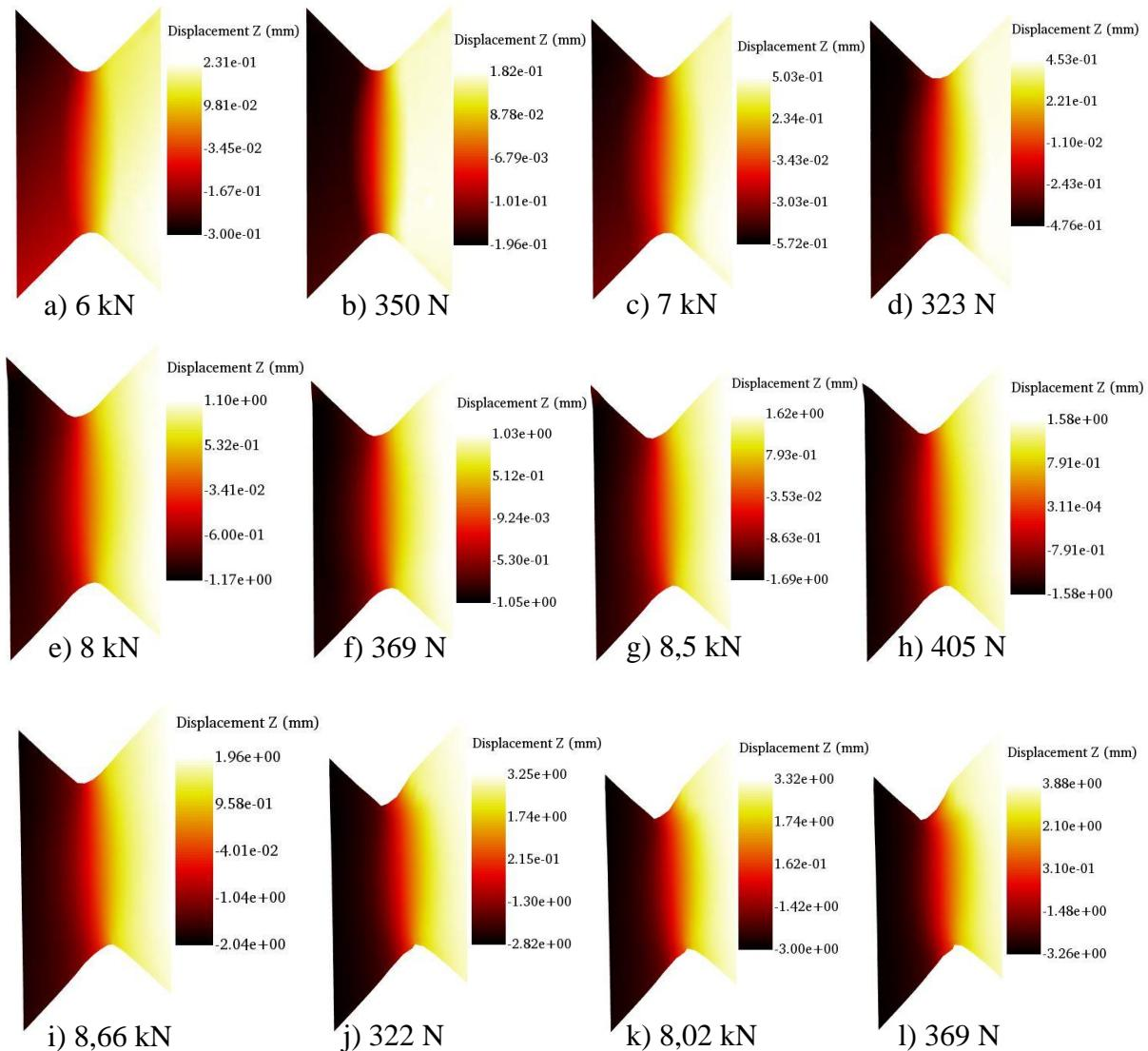
Slika 94. Pomaci u smjeru osi  $z$  pri cikličkom sručnom opterećenju uzorka E3
