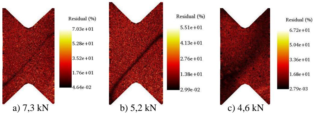
**Slika 73. Raspodjela reziduala na površini ispitnog uzorka E1**
