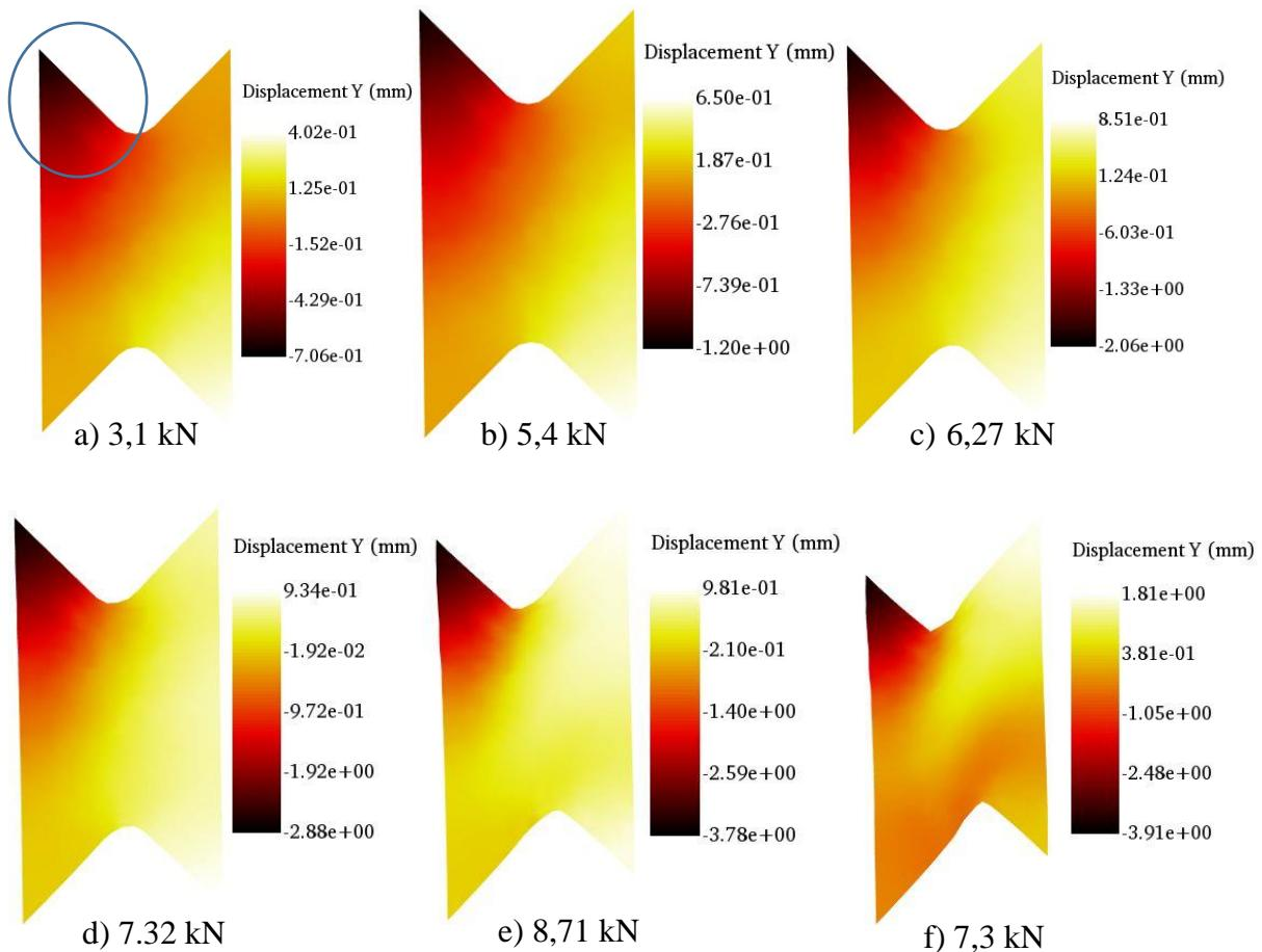
Slika 85. Pomaci u smjeru osi y za statičko sмиčno ispitivanje uzorka E3
