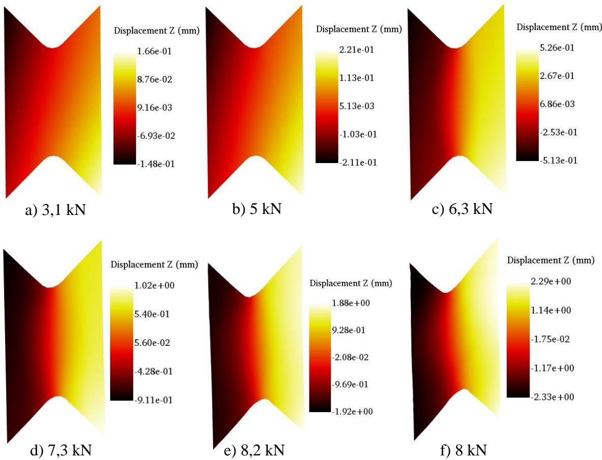
**Slika 78. Pomaci u smjeru osi z za statičko smično ispitivanje uzorka E2**
