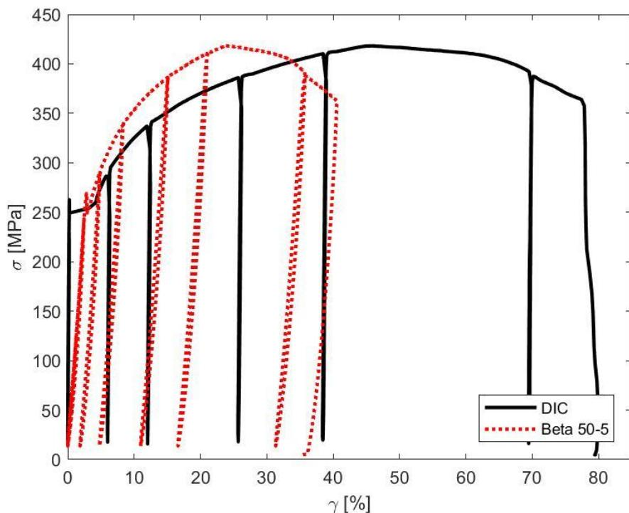
Slika 91. Krivulja inženjerskog naprezanja i izmjerene deformacije ispitnog uzorka E4
