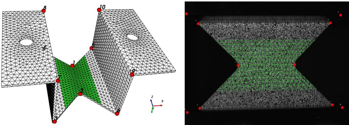
**Slika 61. Prikaz odabralih točaka u analizi statičkog smičnog ispitivanja bez potpore pleksiglasa**
