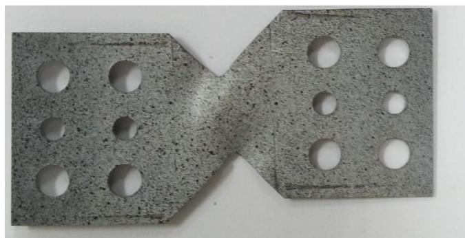
Slika 82. Deformirani ispitni uzorak E2
