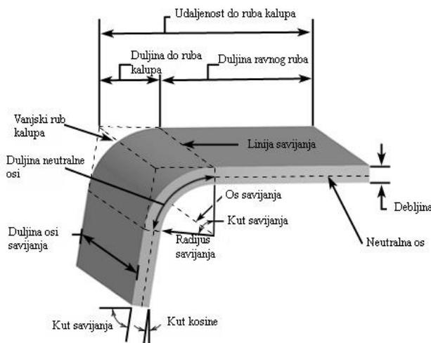
**Slika 4. Parametri savijanja [8]**
