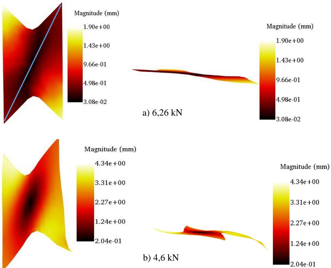
**Slika 71. Ukupni pomaci za statičko sмиčno ispitivanje uzorka E1**
