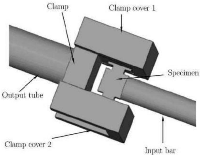
Slika 35. Model sklopa za ispitni uzorak sa dva zareza [39]
