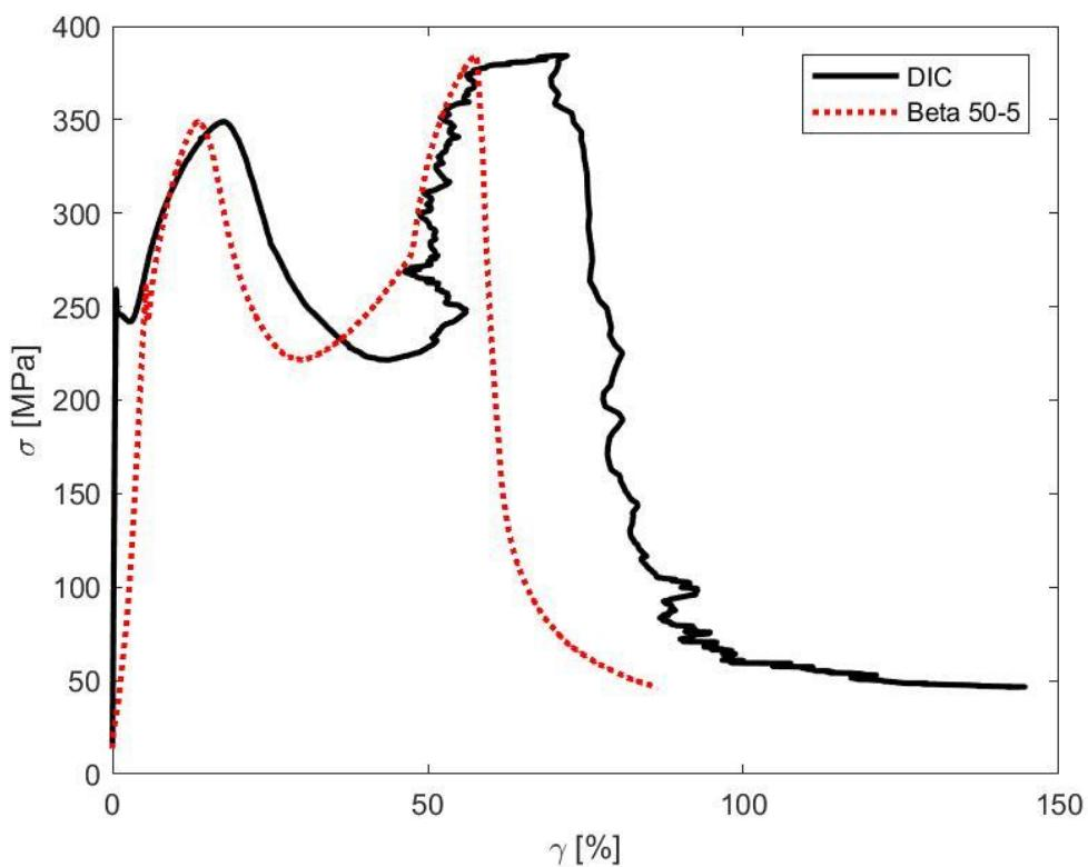
**Slika 67. Krivulja inženjerskog naprezanja i izmjereneih deformacija ispitnog uzorka E1**
