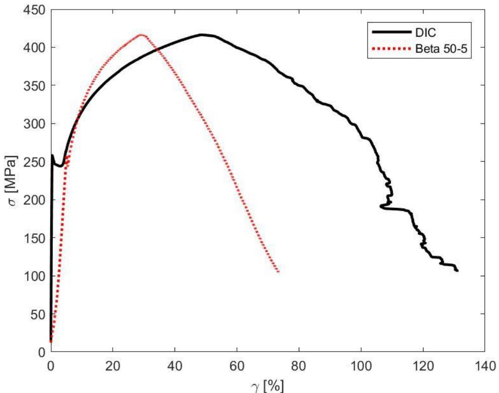
Slika 83. Krivulja inženjerskog naprezanja i izmjerene deformacije ispitnog uzorka E3
