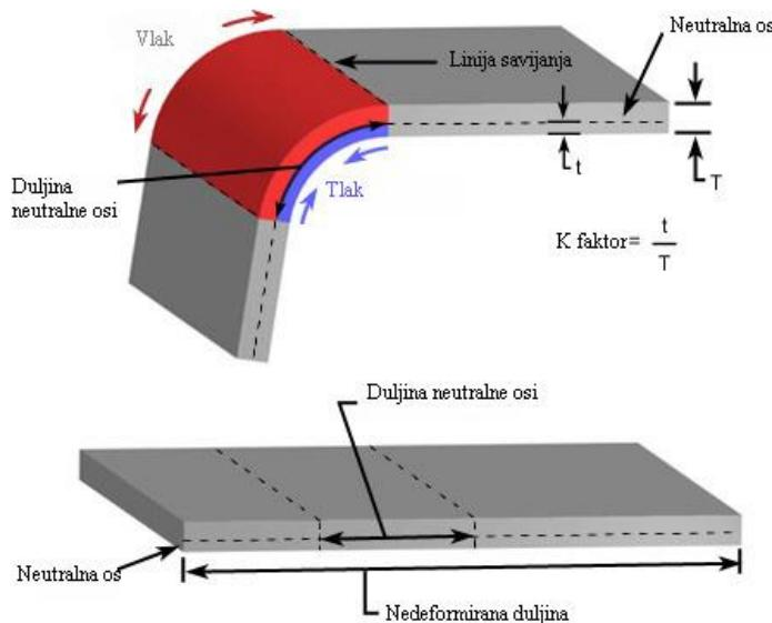
**Slika 5. Naprezanja u limu prilikom savijanja [8]**
