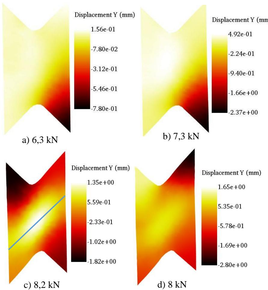
**Slika 77. Pomaci u smjeru osi y za statičko sмиčno ispitivanje uzorka E2**
