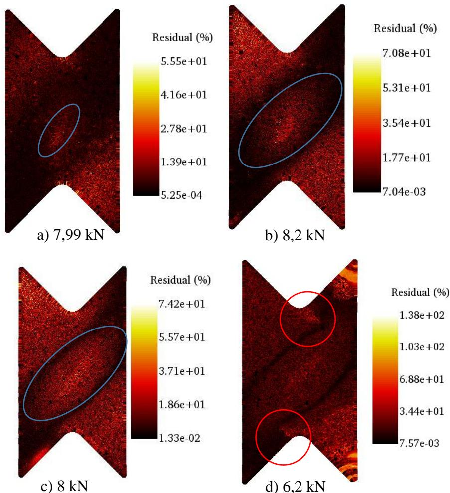
Slika 81. Raspodjela reziduala na površini ispitnog uzorka E2
