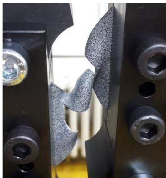
Slika 46. Izvijanje ispitnog uzorka debljine 1 mm [37]
