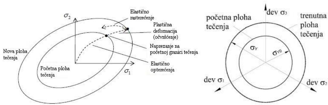
Slika 17. Grafički prikaz izotropnog očvršćenja [12] [16]
