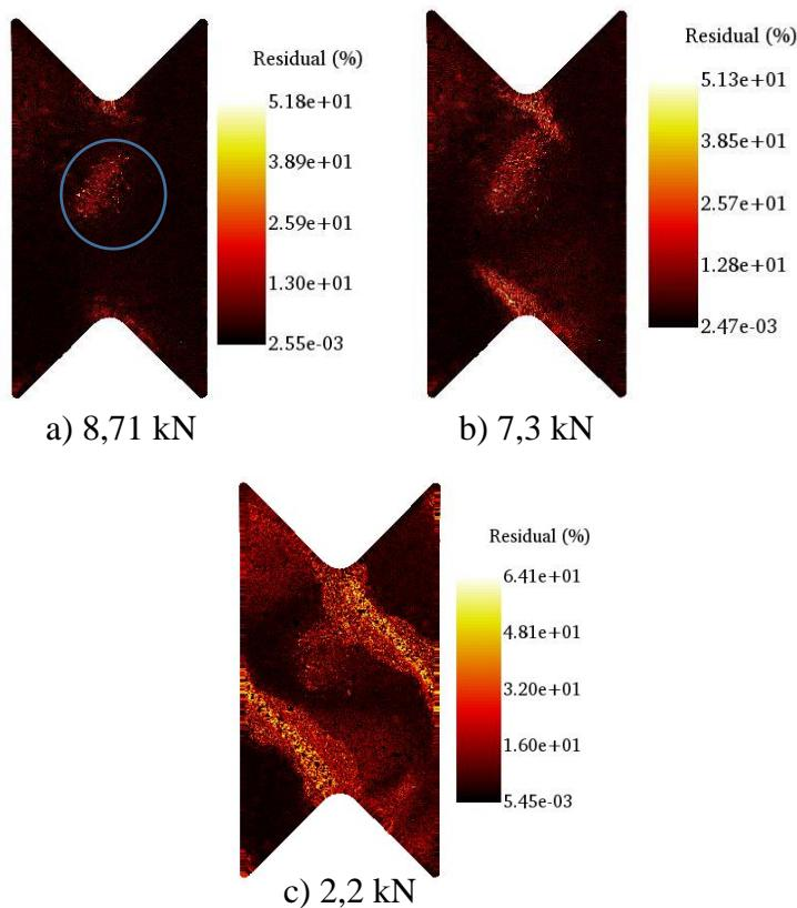
**Slika 89. Raspodjela reziduala na površini ispitnog uzorka E3**
