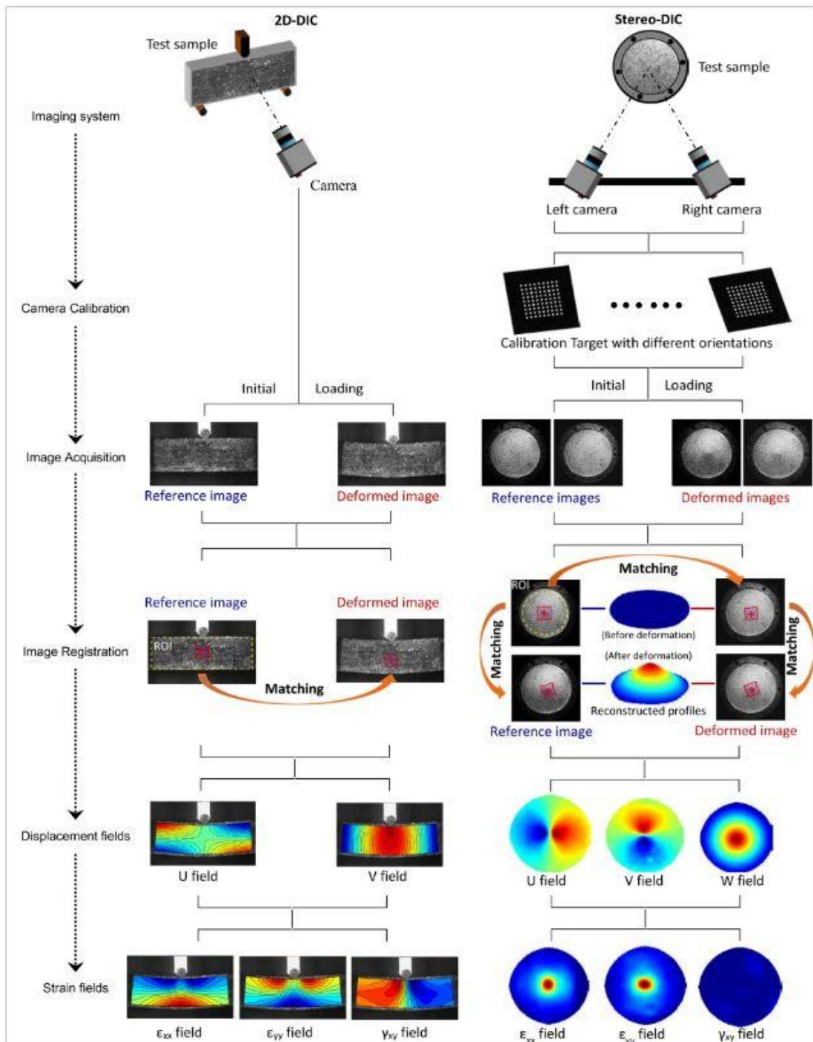
Slika 22. Postupak primjene 2D i stereo DIC metode [22]
