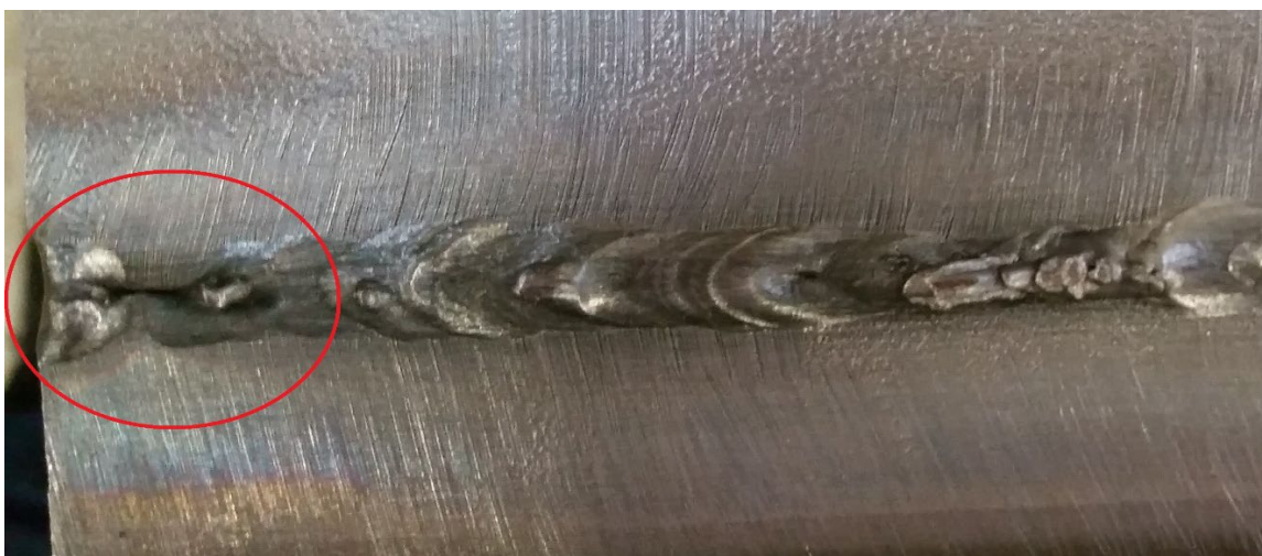
Slika 71. Prikaz pogreške nedovoljnog provara korijenskog prolaza, Laboratorij za zavarivanje, FSB, Zagreb
