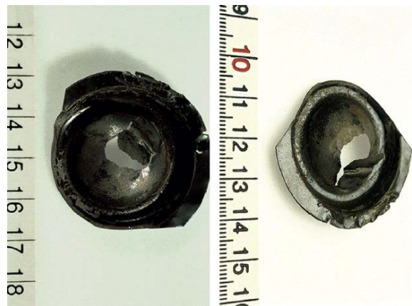
Slika 7. Prikaz napetosne korozije tehnički čistog nikla [19]
