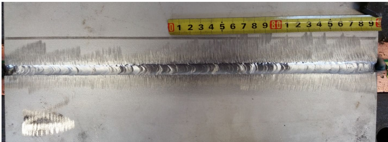
Slika 64. Prikaz prvog prolaza popune nakon čišćenja oksida, Laboratorij za zavarivanje, FSB, Zagreb
