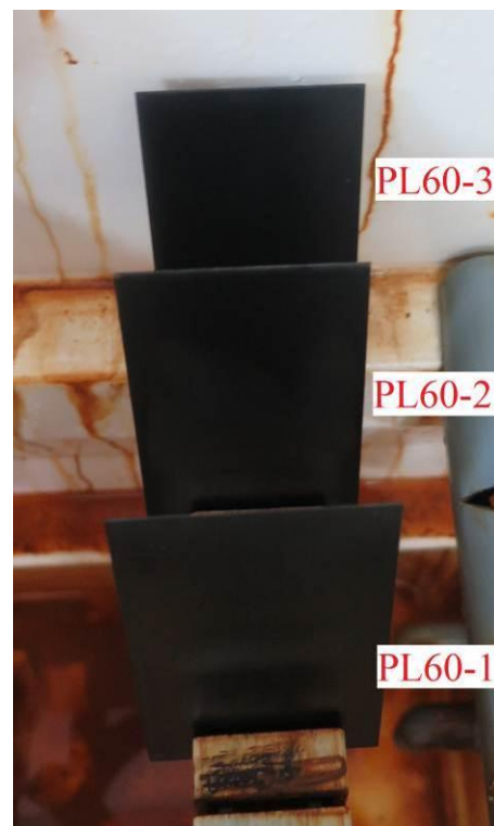
Slika 70. Uzorci PL60-1,2,3 postavljeni u slanu komoru
