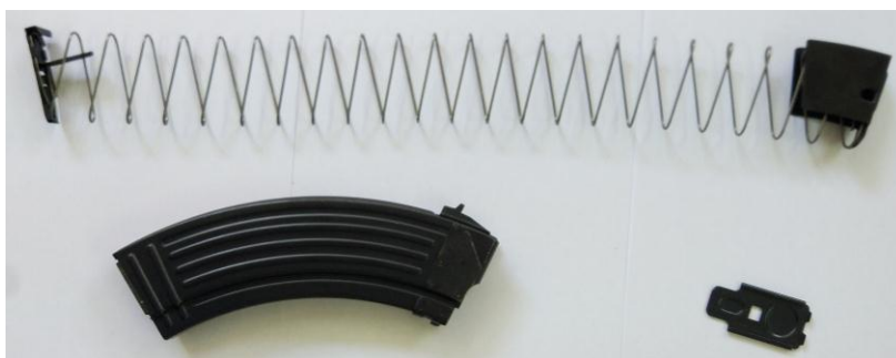
Slika 48. Rastavljeni spremnik streljiva s vidljivim pojedinim dijelovima
