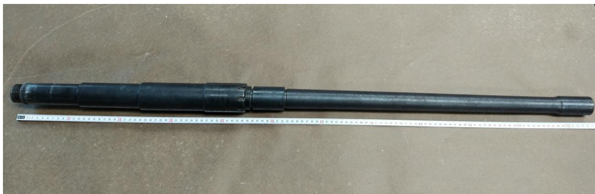
Slika 51. Cijev strojnice 12,7 mm
