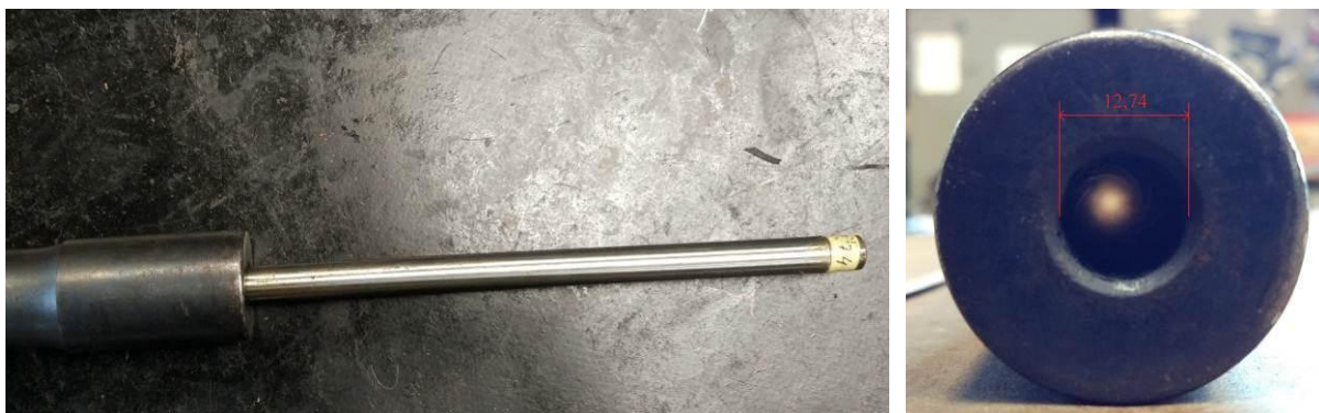
Slika 52. Mjerenje promjera cijevi etalom od 12,74 mm
