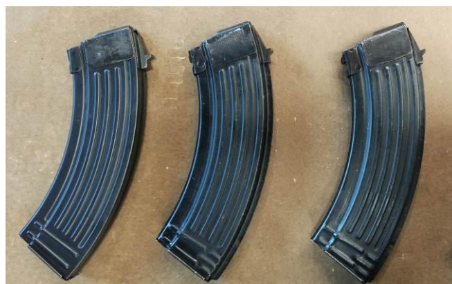
Slika 49. Brunirana tijela spremnika streljiva prije provedbe ispitivanja
