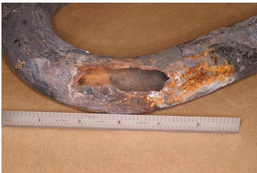
Slika 28. Oštećenje uzrokovano erozijskom korozijom [34]
