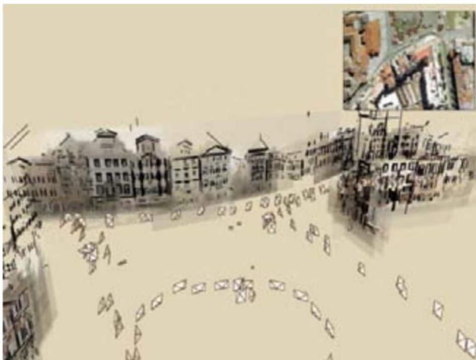
Slika 10. Primjer stvaranja 3D modela prostora na temelju velikog broja 2D fotografija [13]
