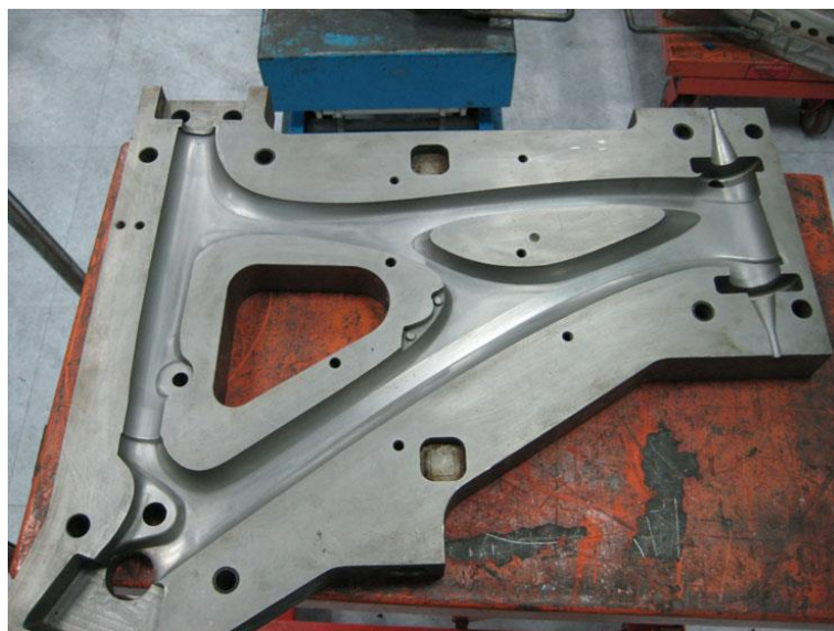
Slika 22. Otvoreni kalup za prednji okvir [13]
