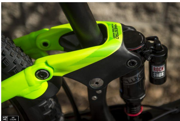
Slika 27. Klackalica iz jednog komada [17]
