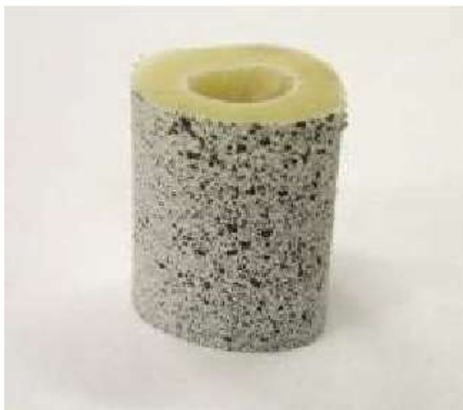
Slika 6. Primjeri stohastičkog premaza na kosti
