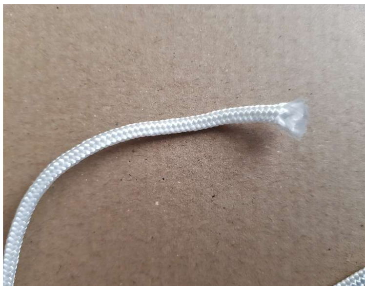
Slika 14. Uže za statičko vlačno ispitivanje
