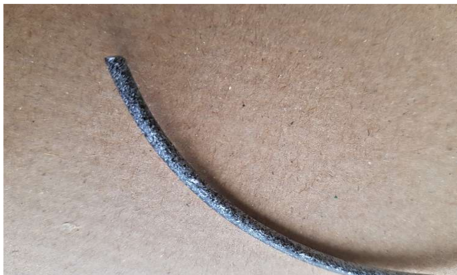
Slika 12. Stohastički premaz za ispitivanje užeta Aramis sustavom
