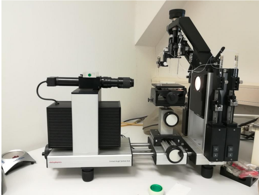
Slika 32. Uređaj za mjerenje kuta kvašenja Dataphysics Contact Angle System OCA
