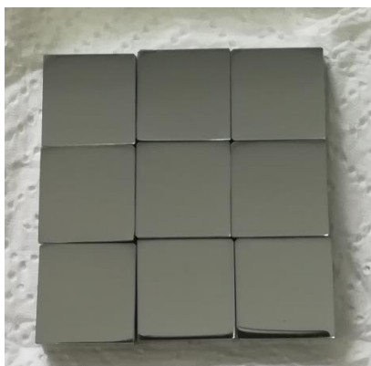
Slika 17. Uzorci nakon provedene mehaničke predobrade brušenja i poliranja
