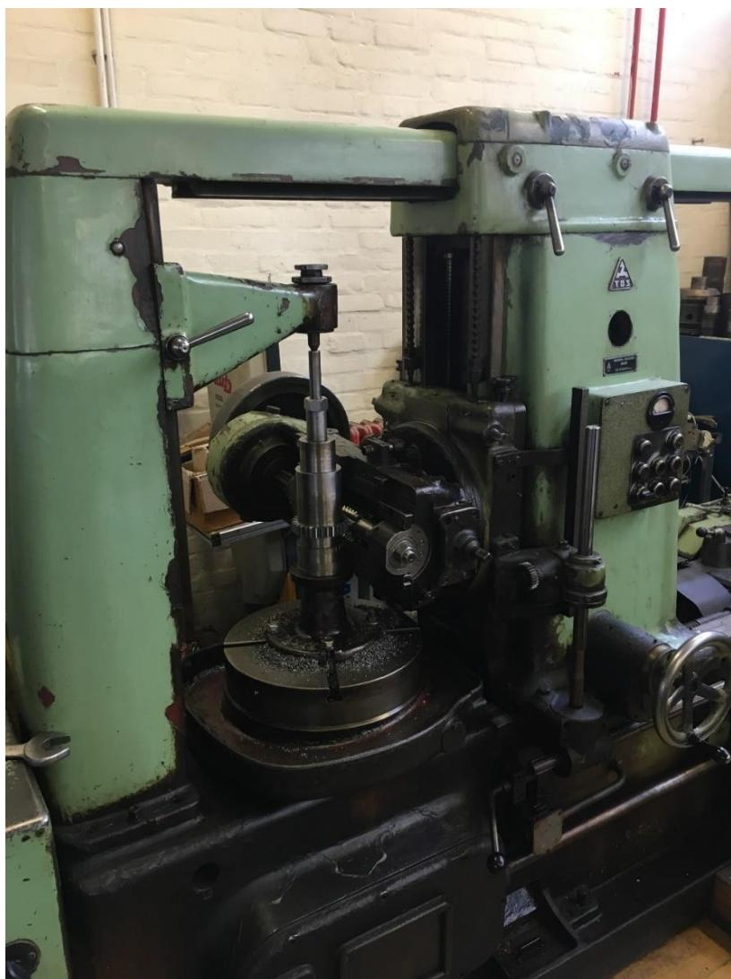
Slika 16. Odvalna glodalica na Fakultetu strojarstva i brodogradnje
