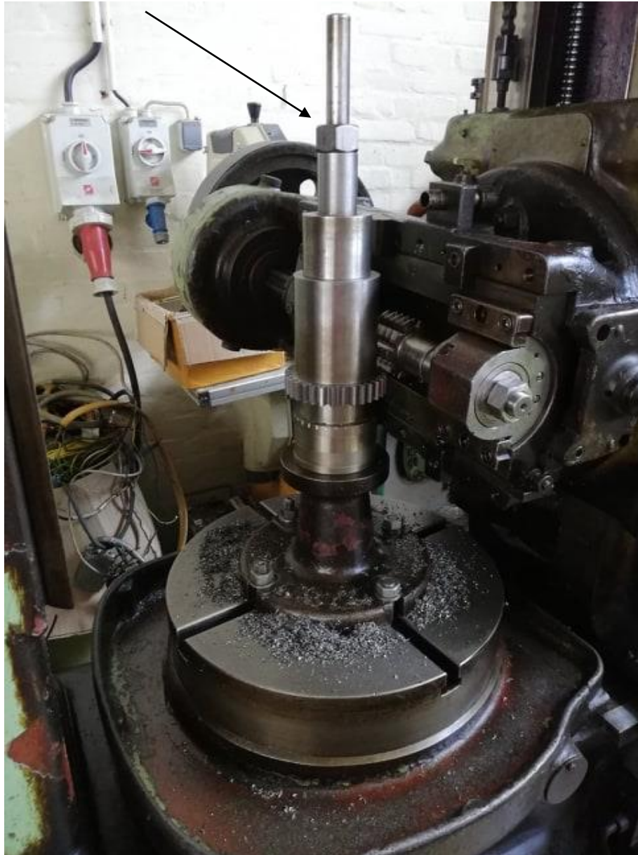
Slika 39. Prikaz trna i glavnog vretena glodalice
