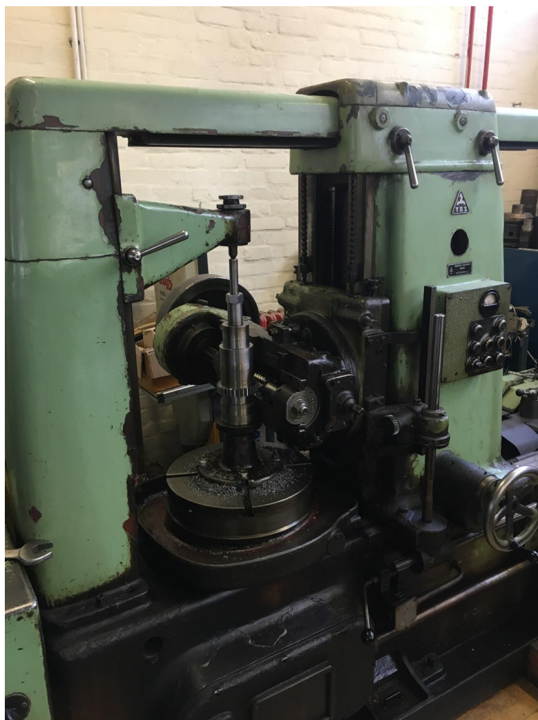
Slika 16. Odvalna glodalica na Fakultetu strojarstva i brodogradnje
