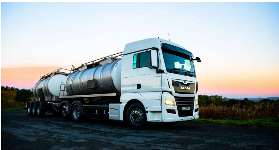
Slika 5. Nadgradnja za transport tekućeg tereta [7]
