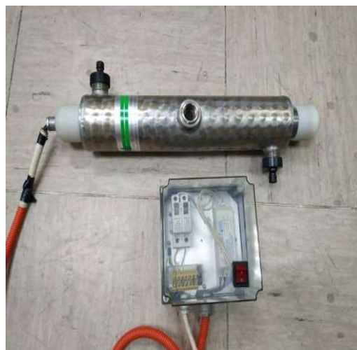
Slika 25. Princip rada UV dezinfekcije i reaktor s UV svjetiljkom za male protoke iz Laboratorija za vodu, gorivo i mazivo Fakulteta strojarstva i brodogradnje
