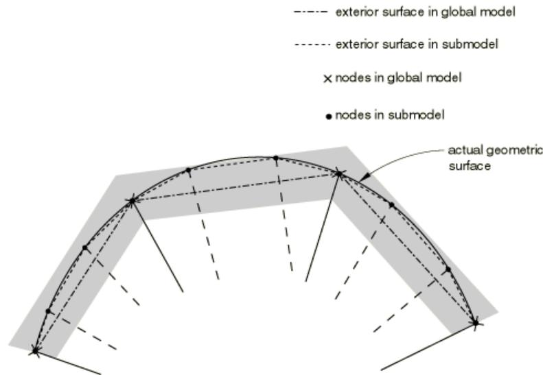
Slika 4.6. Geometrijska tolerancija kod *solid-to-solid* podmodeliranja [8]
