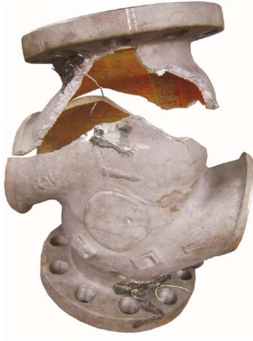
Slika 1.3. Slom kućišta ventila [3]
