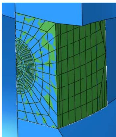
Slika 7.22. Podudaranje geometrije podmodela i kućišta ventila
