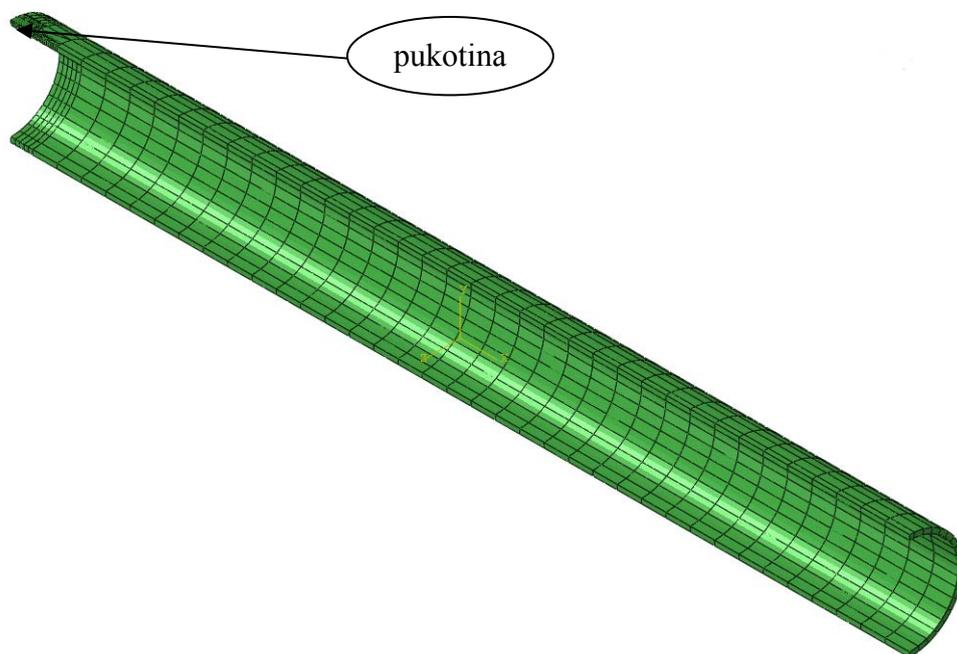
Slika 5.3. Prikaz 1/4 3D modela cijevi s polueliptičnom pukotinom
