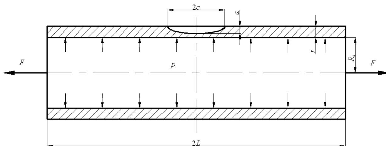
Slika 5.1. Cijev s polueliptičnom pukotinom opterećena unutarnjim tlakom
