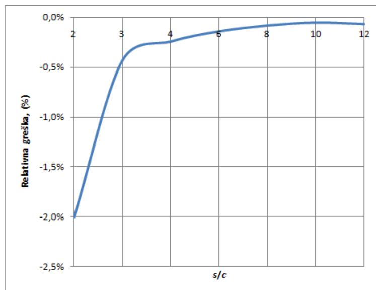
Slika 5.11. Relativna greška faktora intenzivnosti naprezanja po podmodelima
