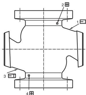
Slika 7.6. Pozicija i orijentacija tenzometara za provođenje eksperimenta [11]
