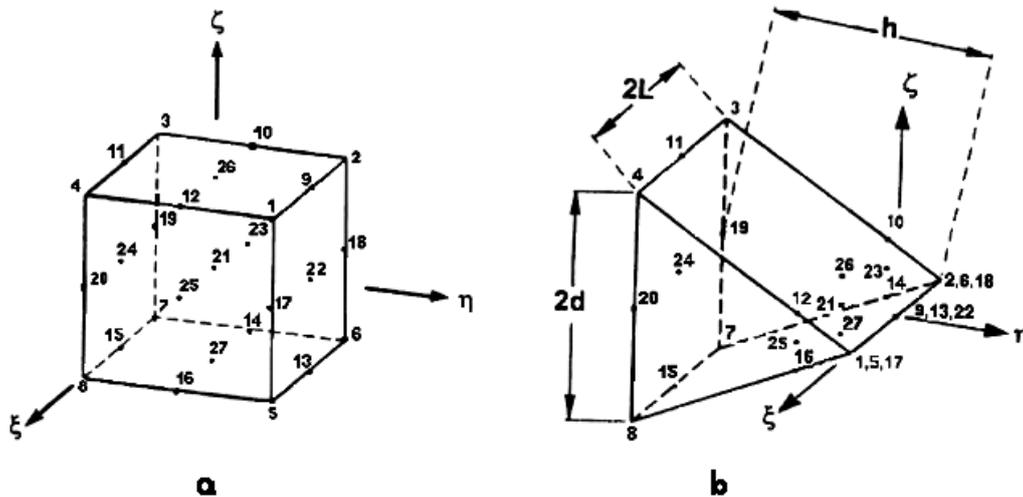
Slika 2.7. 27-čvorni Lagrangeov element: a) izvorni, b) kolabirani [3]
