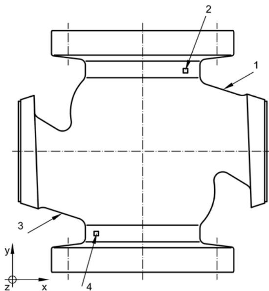
Slika 2. Položaj tenzometara u provedenoj tlačnoj probi
