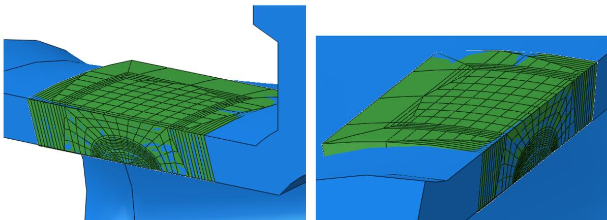
Slika 7.9. Podudaranje geometrije podmodela i kućišta ventila
