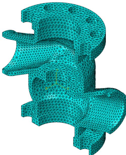
Slika 7.4. Mreža konačnih elemenata kućišta ventila
