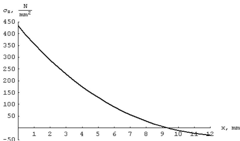
Slika 7.19. Grafički prikaz krivulje raspodjele naprezanja po debljini stijenke za vanjsku pukotinu [12]
