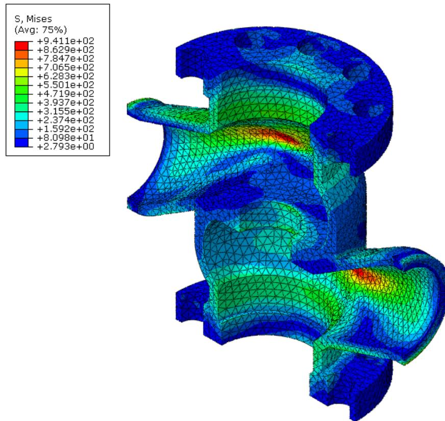
Slika 7.5. Naprezanja kućišta ventila prema *Von Mises-u*
