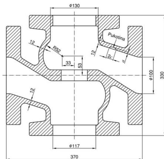
Slika 1. Kućište ventila oznake DN100 PN40 s osnovnim dimenzijama
