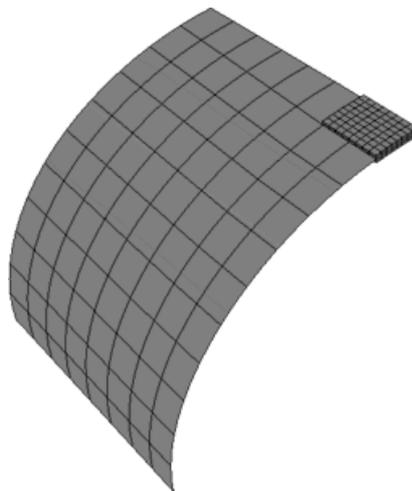
Slika 4.3. Prikaz stvarnog modela izrađenog tehnikom podmodeliranja [6]
