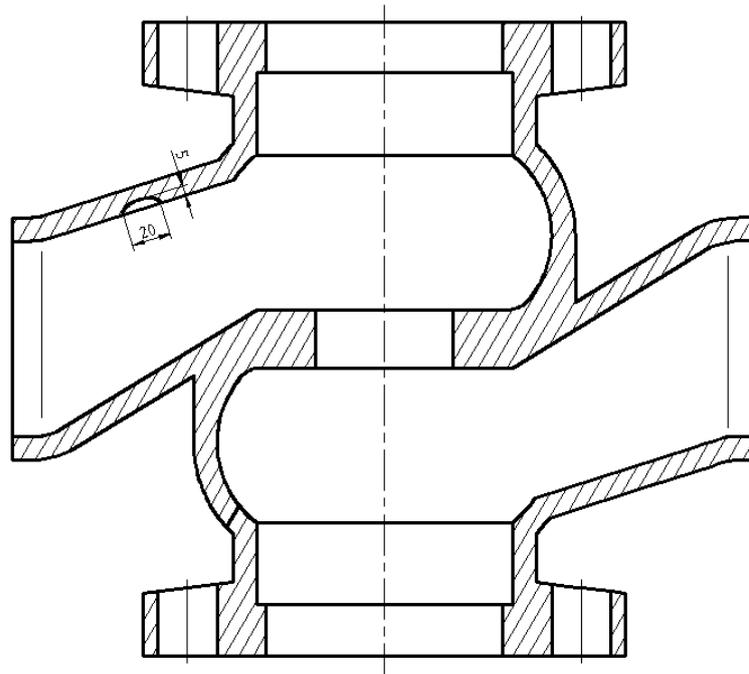
Slika 7.8. Smještaj unutarnje pukotine na priključnom ogranku
