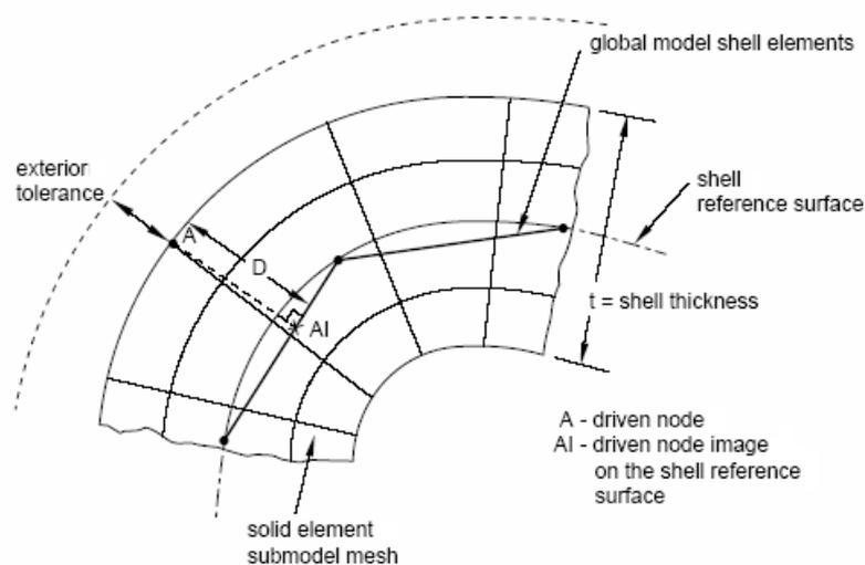
Slika 4.5. Vanjska tolerancija kod *shell-to-solid* modeliranja [6]
