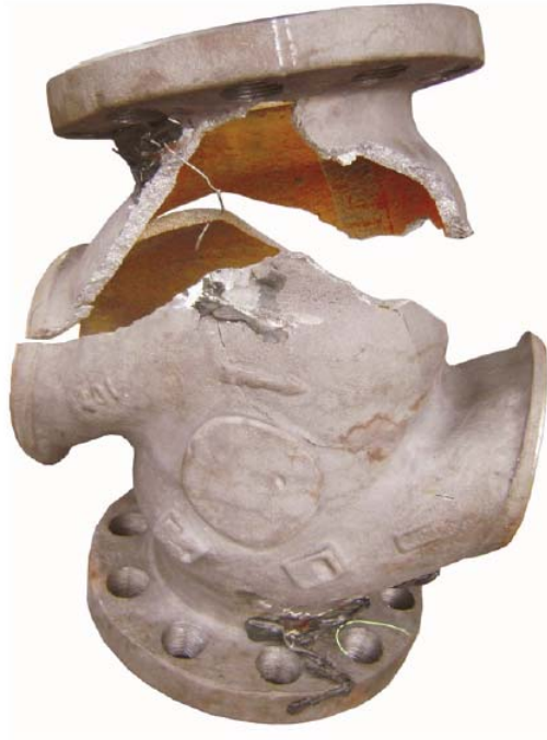
Slika 1.3. Slom kućišta ventila [3]
