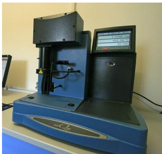
Slika 23. Termogravimetar, Q500, TA Instruments [25]
