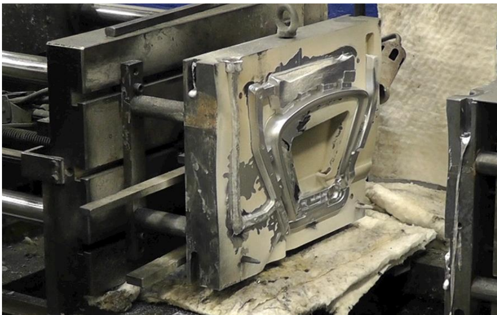
Slika 8. Kokila s pripadajućim aluminijskim odljevkom [12]
