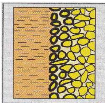
Slika 5. Zrnca pijeska obavijena sjajnim ugljikom [6]
