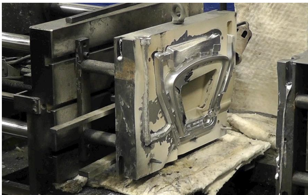
Slika 8. Kokila s pripadajućim aluminijskim odljevkom [12]
