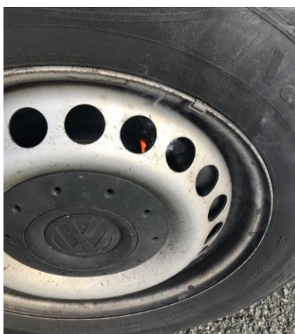
Slika 6.26 Plamen na kočionoj oblozi nakon 9. ispitivanja
