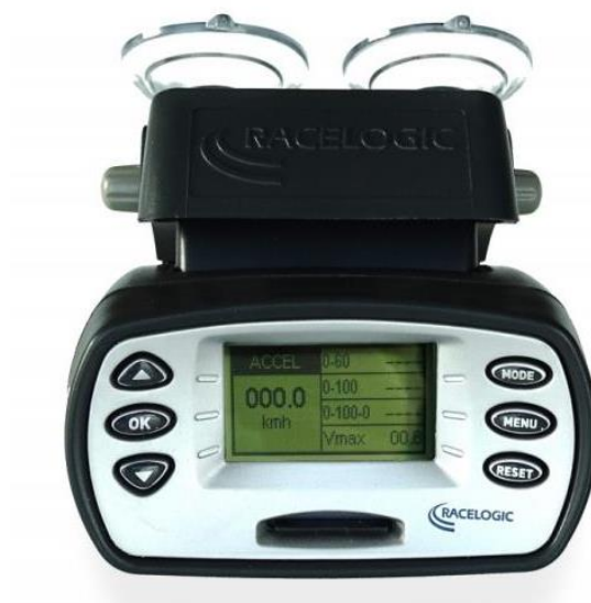
Slika 6.23 RACE LOGIC DRIFT-BOX uređaj
