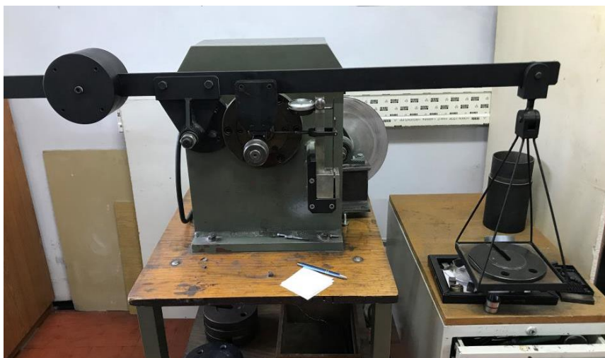
Slika 6.2 Uređaj za ispitivanje faktora trenja
