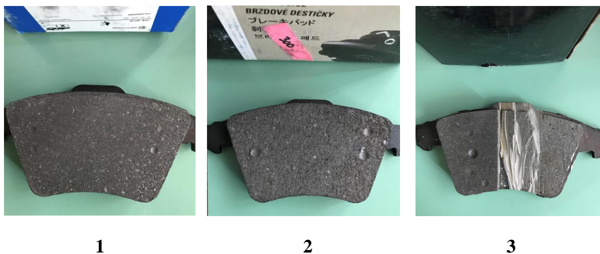
Slika 6.4 Otisci uređaja za ispitivanje tvrdoće na uzorcima
