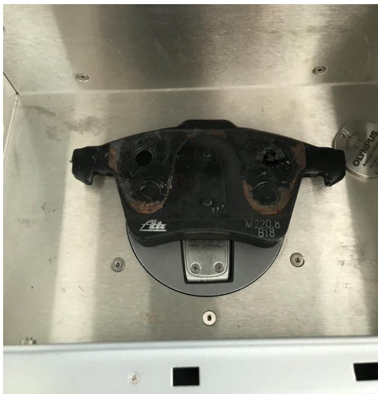
Slika 6.9 Uzorak tijekom ispitivanja na XRF uređaju
