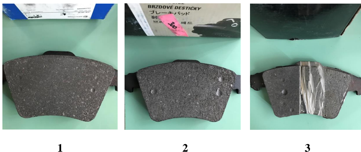
Slika 6.4 Otisci uređaja za ispitivanje tvrdoće na uzorcima
