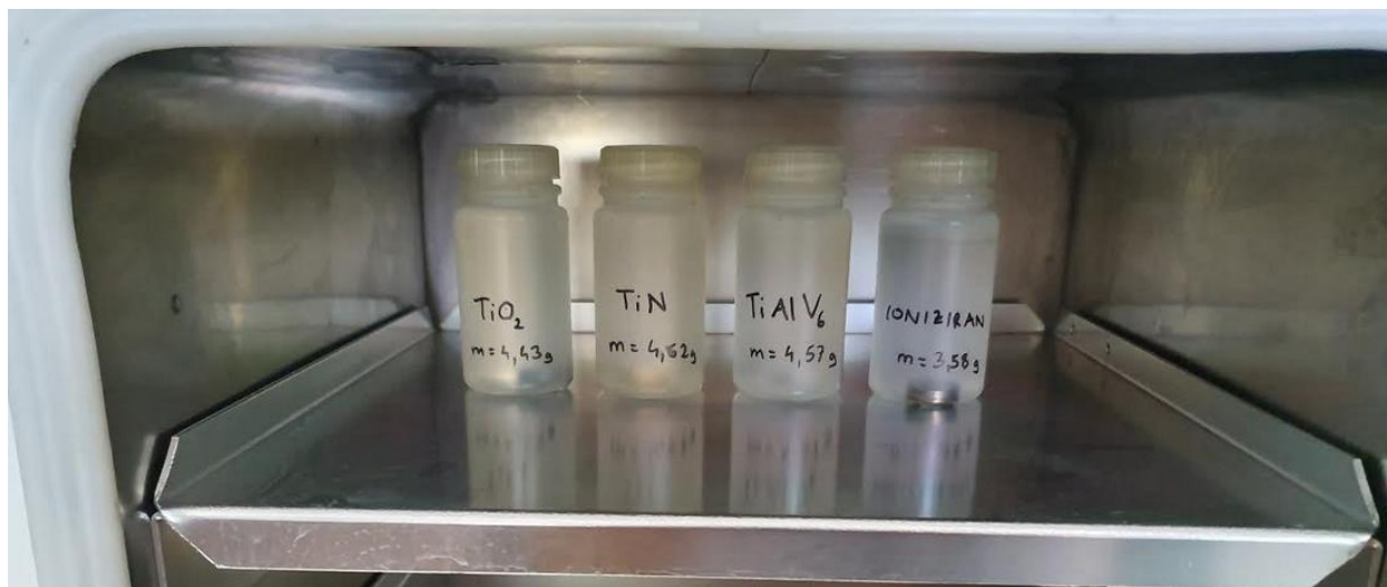
Slika 18 Fotografija uzoraka postavljenih u peć.
