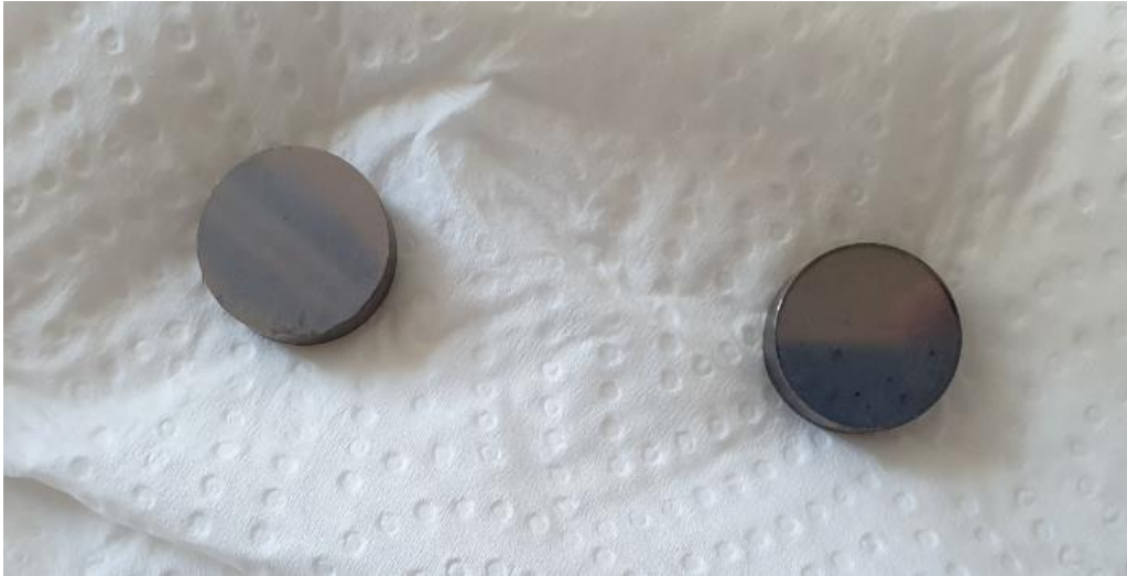
Slika 13 Uzorci nakon nagrizanja i sušenja.
