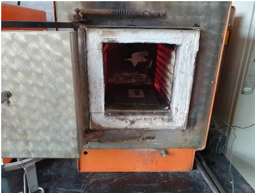
Slika 14 Peć u kojoj je provedena toplinska obrada.
