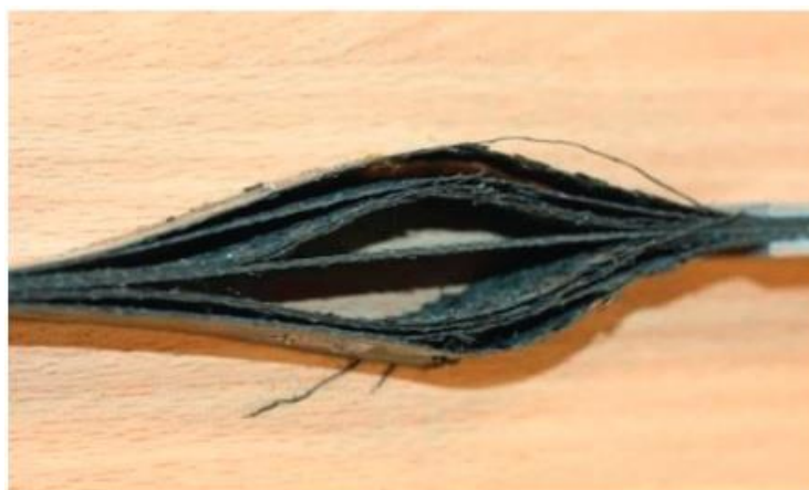
Slika 2. Delaminacija kompozita uslijed vlačnog ispitivanja [3]
