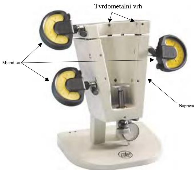
Slika 22. Naprava za mjerenje konusa držača alata [15]
