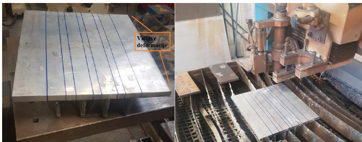
Slika 22. Deformacija osnovne ploče i prikaz plazma rezačice
