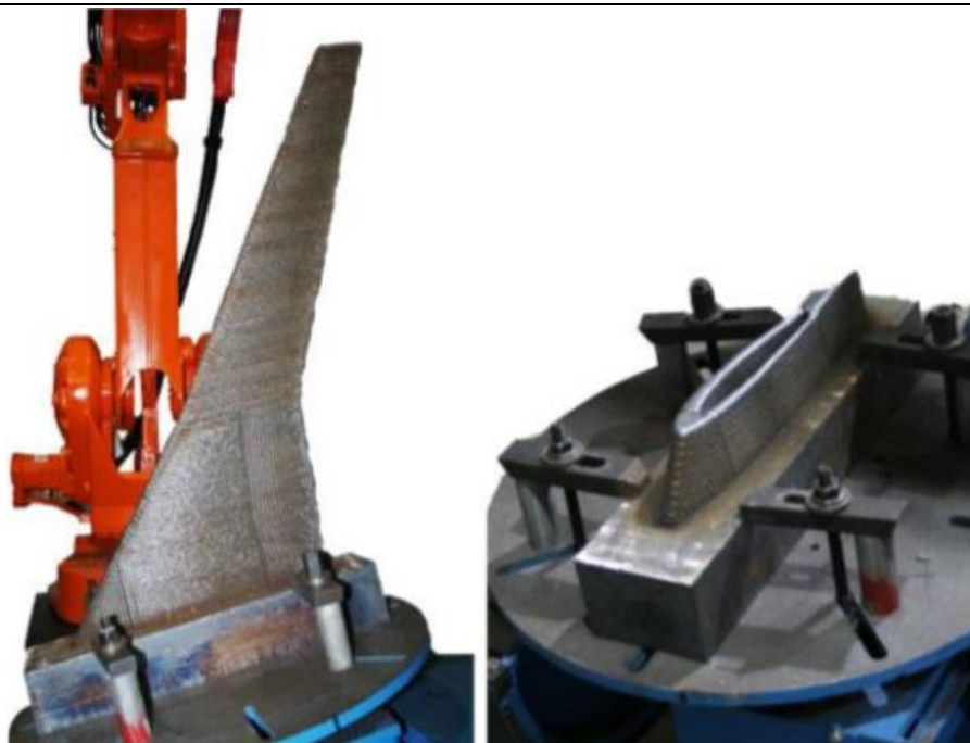
Slika 11. Testno krilo izrađeno WAAM tehnologijom [8]
