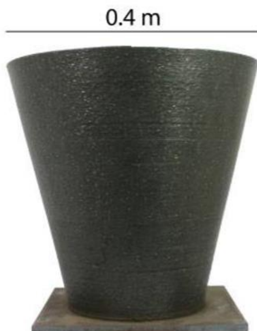
Slika 12. Čelična konusna posuda izrađena WAAM postupkom [8]
