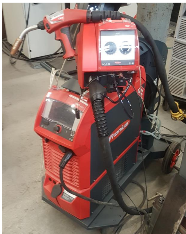
Slika 13. Fronius CMT uređaj
