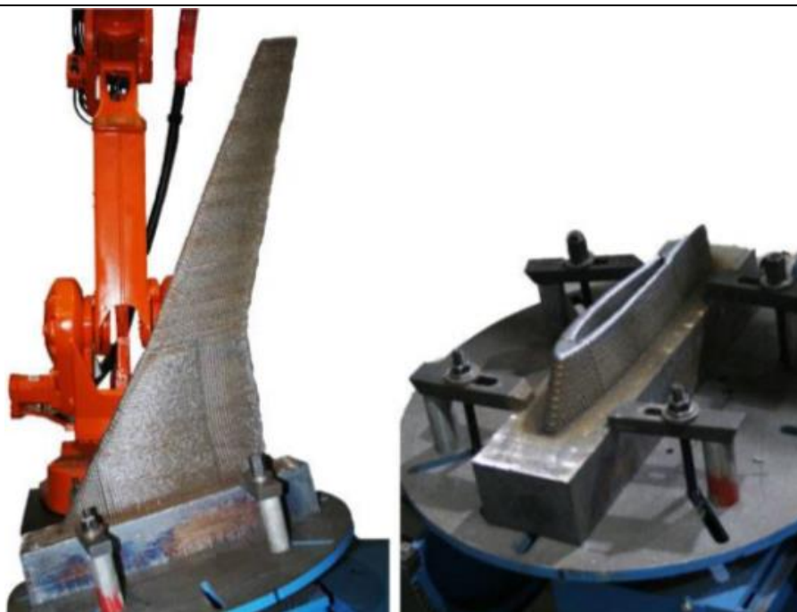
Slika 11. Testno krilo izrađeno WAAM tehnologijom [8]
