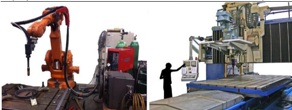
Slika 5. Strojevi za ostvarivanje gibanja pištolja [8]
