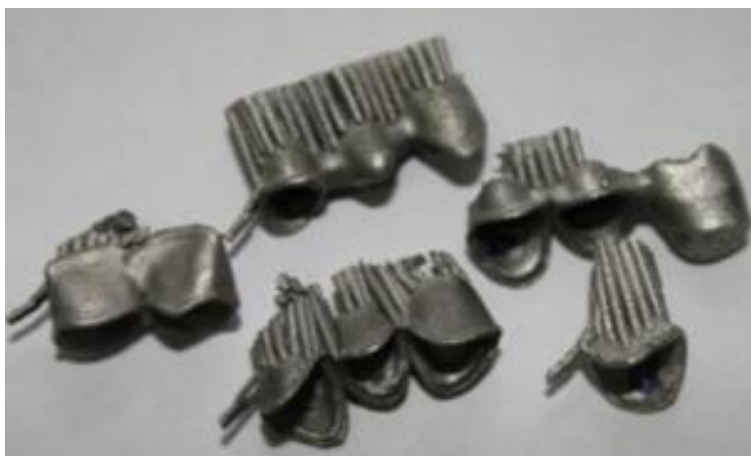
Slika 10. Laserski printane krunice prije završne obrade [19]
