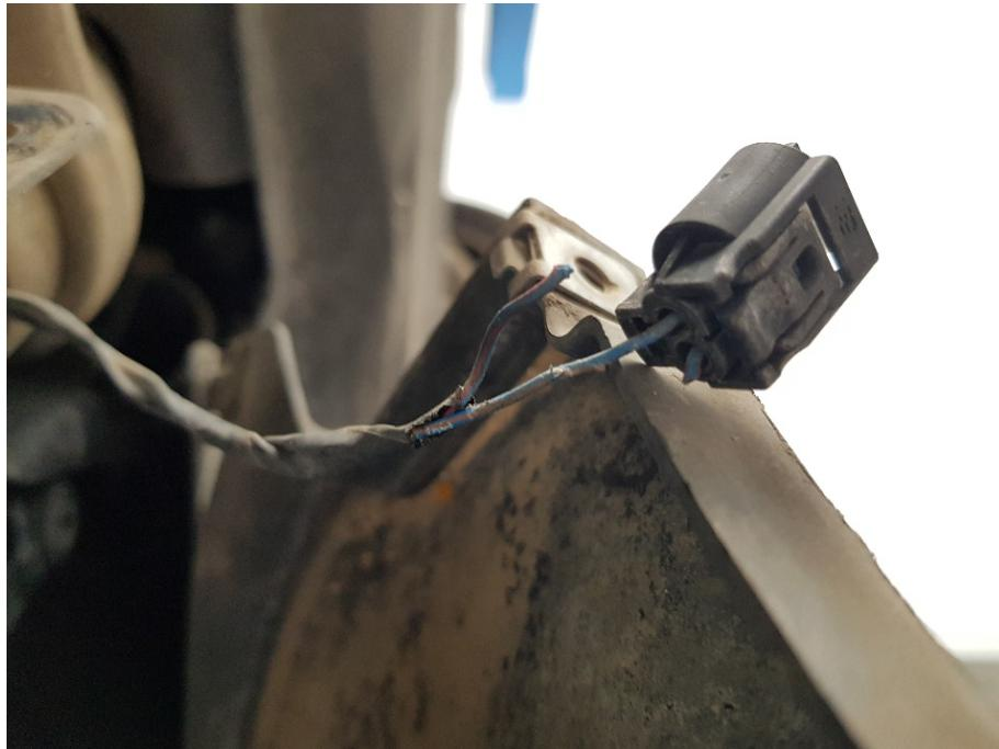
Slika 6.26. Primjer neispravne električne instalacije senzora temperature okoline
