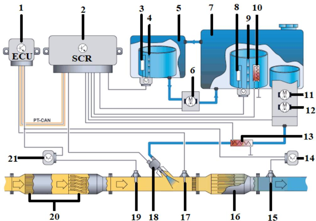
Slika 5.26. Funkcionalna shema rada SCR sustava [20]
