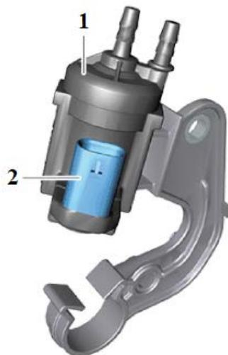
Slika 5.5. Preklopni ventil hladnjaka EGR ventila [20]
