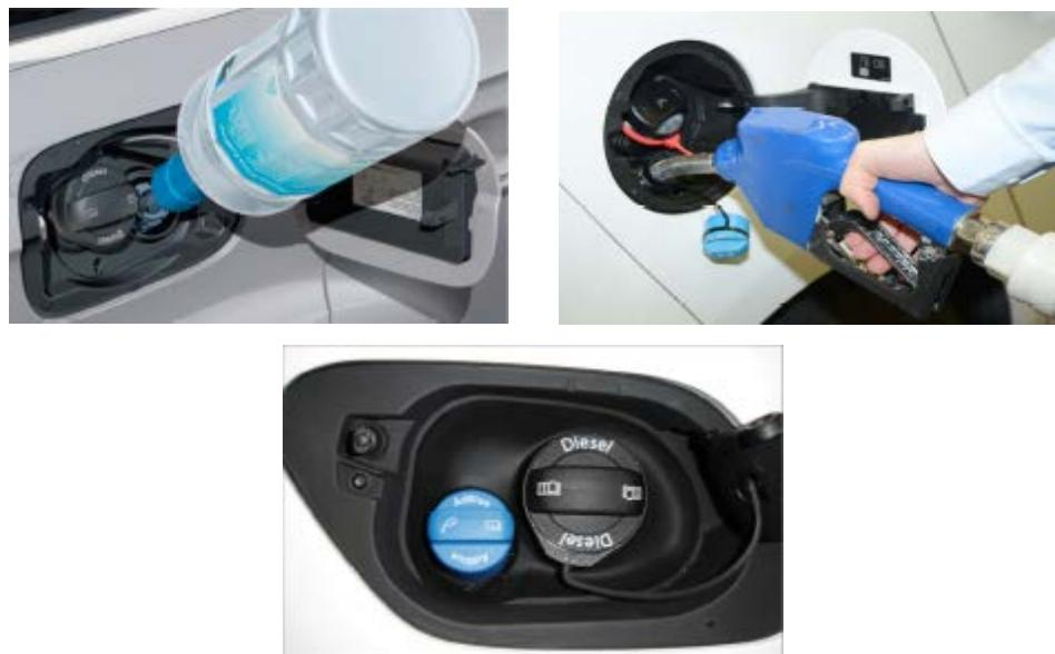
Slika 5.24. Prikaz položaja ugradnje poklopca AdBlue spremnika [23]
