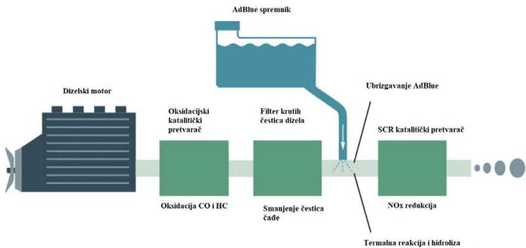
Slika 5.18. Funkcionalni primjer naknadne obrade ispušnih plinova čistog dizelskog goriva s SCR tehnologijom [23]
