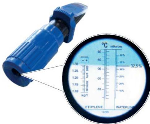
Slika 5.25. Refraktometar s ljestvicom AdBlue [20]
