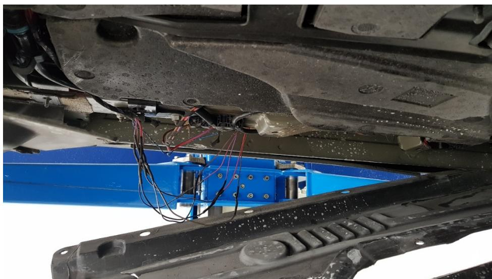
Slika 6.27. Primjer neispravne električne instalacije na NO<sub>x</sub> senzora
