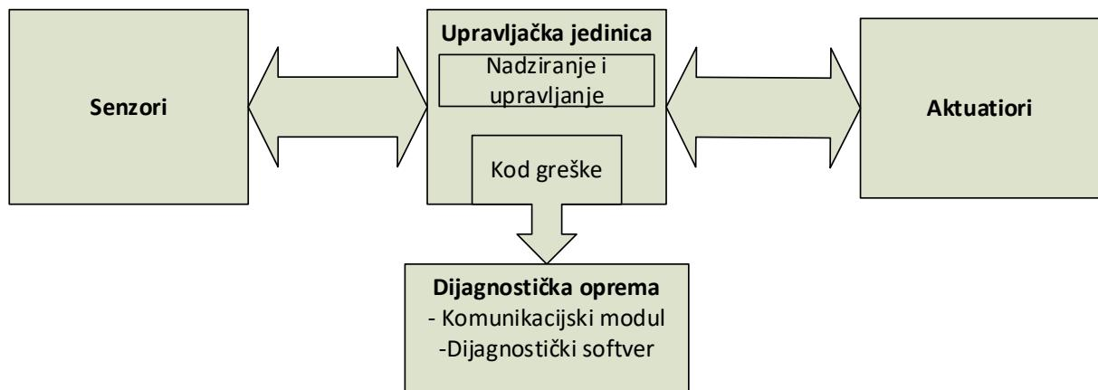
Slika 6.3. Blok–shema spajanja dijagnostičke opreme s upravljačkom jedinicom [28]
