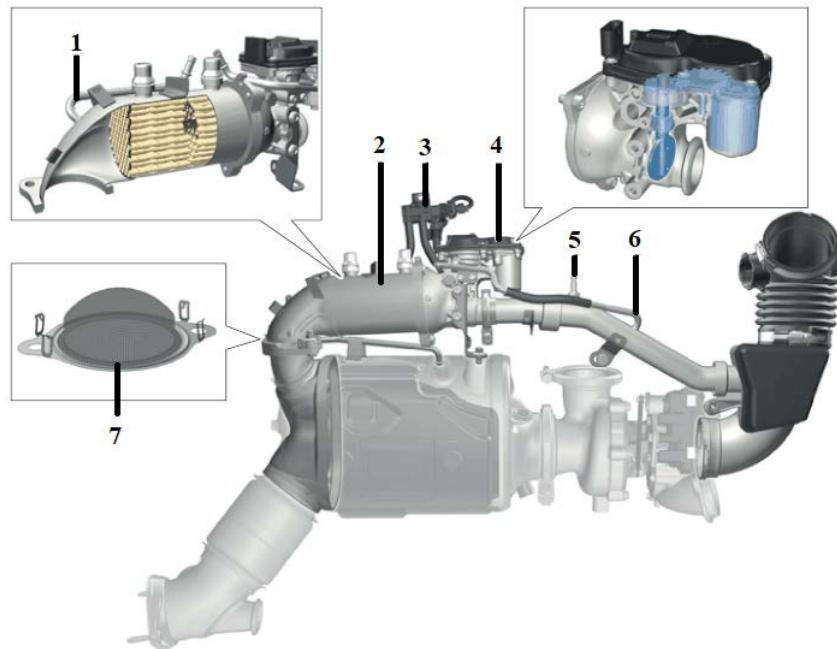
Slika 5.7. Sklop za recirkulaciju ispušnih plinova niskog tlaka [20]
