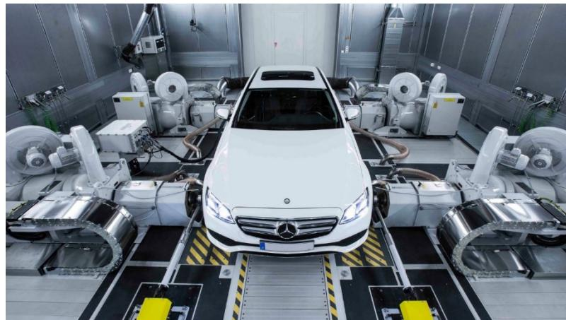
Slika 4.1. Mjerenje emisije štetnih plinova na ispitnim valjcima [17]
