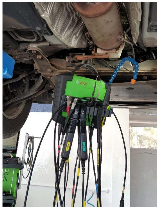
Slika 6.29. Spajanje uređaja BOSCH FSA 500
