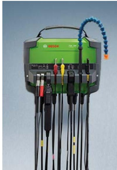
Slika 6.2. Multifunkcionalni uređaj BOSCH FSA 500 [27]
