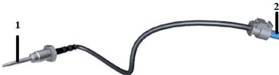
Slika 5.22. Senzor temperature ispušnih plinova [20]
