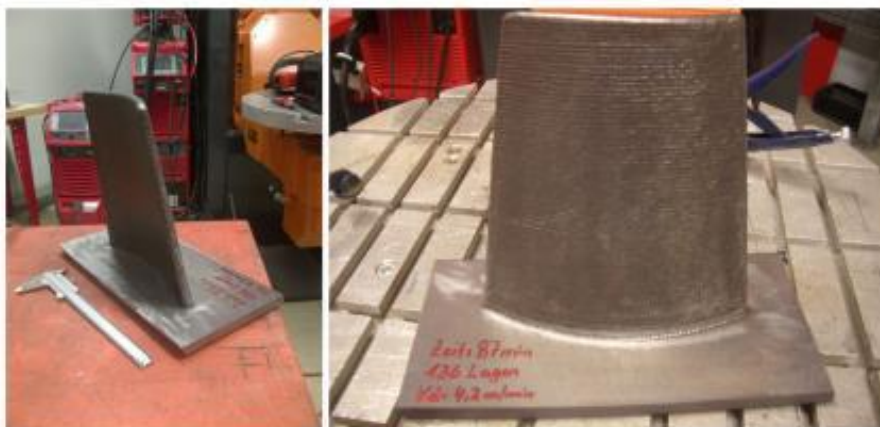
Slika 6. Primjer proizvoda izrađenog od dupleks nehrđajućeg čelika WAAM postupkom [13]
