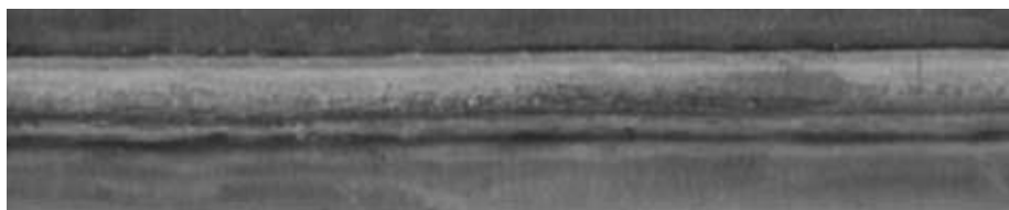
Slika 27. Čelični lim debljine 1,0 mm; sučeljeni spoj razmaka 1 mm; 1,0 mm G4Si1 dodatni materijal 2,0 m/min; U = 19 V; I = 136 A [30]
