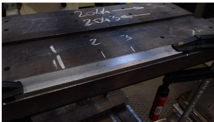
Slika 41. Označena mjesta mjerenja visine zida
