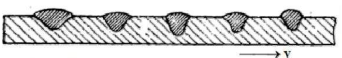
Slika 15. Shematski prikaz izgleda zavara u ovisnosti o brzini zavarivanja [24]
