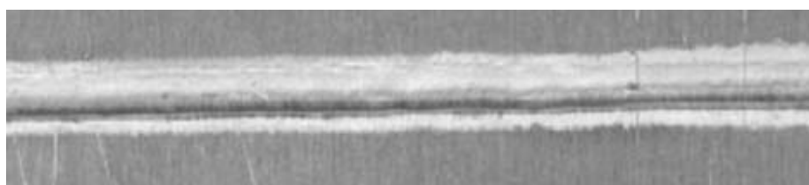
Slika 28. Lim AlMg3; kutni spoj na preklopnom spoju; 1,0 mm AlSi5 dodatni materijal 1,2 m/min; U = 13 V; I = 55 A [30]
