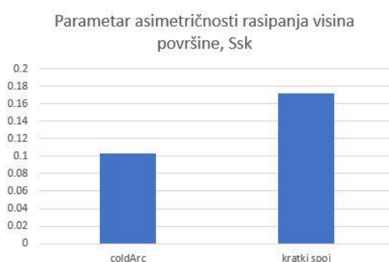
Slika 78. Usporedni prikaz parametra asimetričnosti rasipanja visina površine ( S_{sk} )
