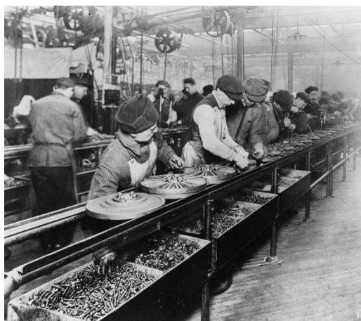
Slika 1. Ford montažna linija, 1913. [1]
