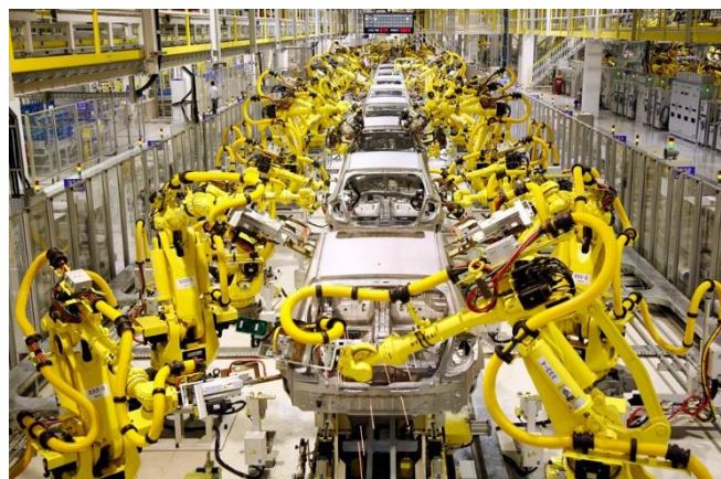
Slika 2. Potpuno automatizirana montažna linija [2].
