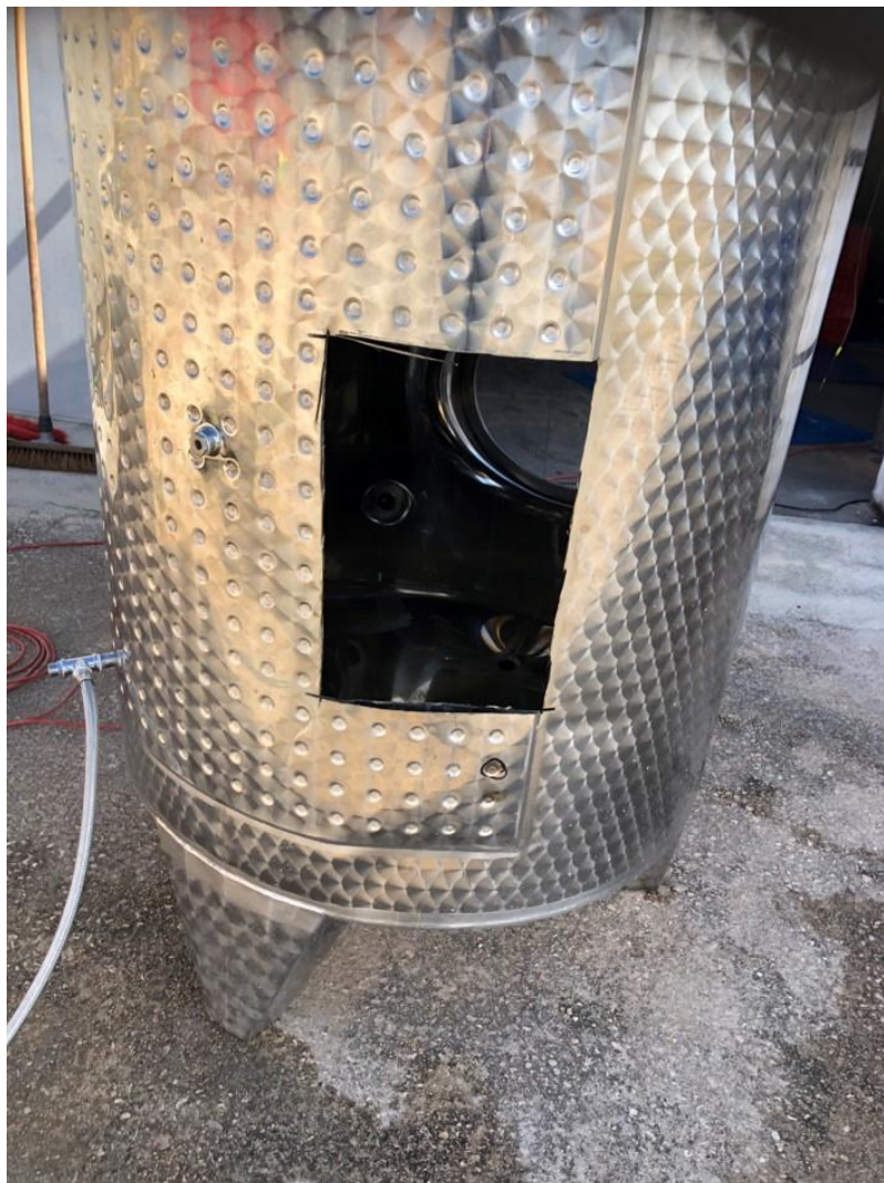
Slika 20. Izrezano područje s najvećom koncentracijom puknuća
