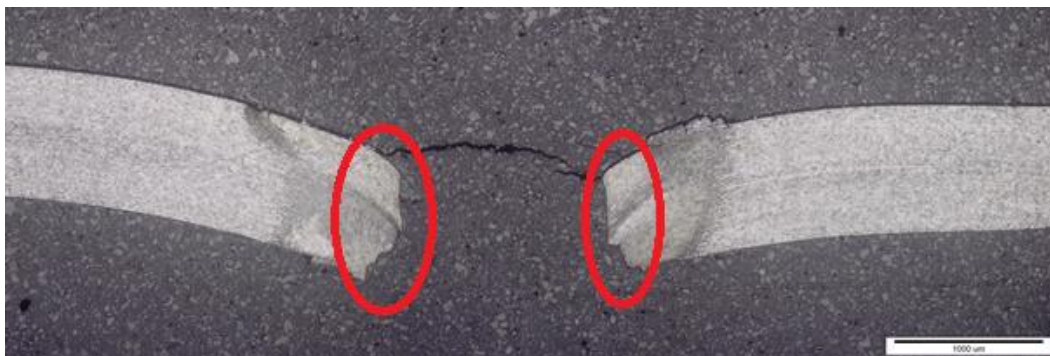
Slika 36. Područje puknuća zavora
