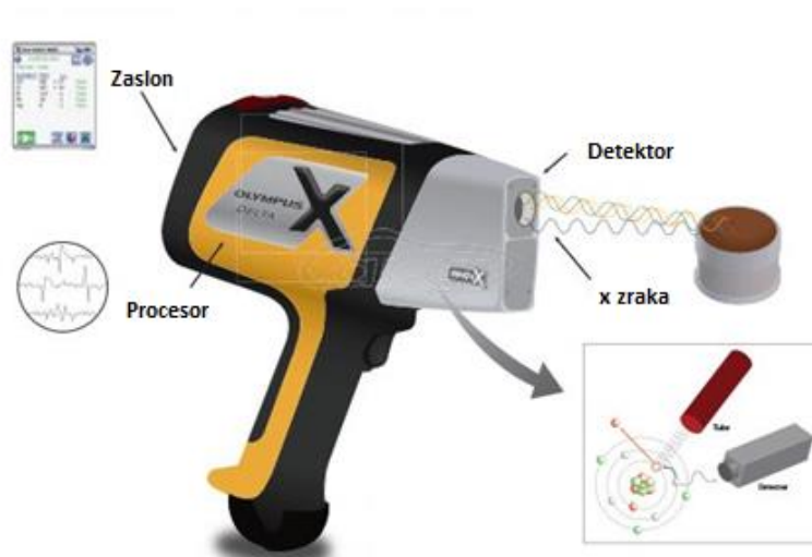
Slika 22. Olympus XRF Analyzer[120]
