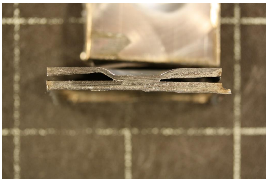
Slika 29. Zavar bez puknuća prije oblaganja polimernom masom
