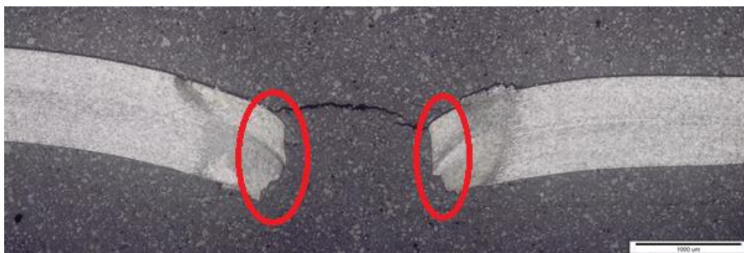
Slika 36. Područje puknuća zavora
