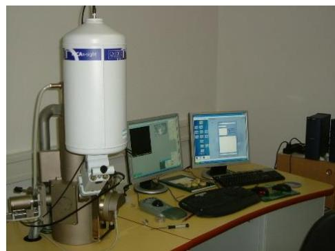
*Slika 31 Skenirajući elektronski mikroskop Tescan i EDS analizator*
