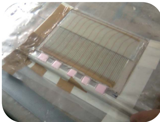
Slika 37 Zatvaranje laminata sa prethodnog šivanim slojevima i vakuumiranje
