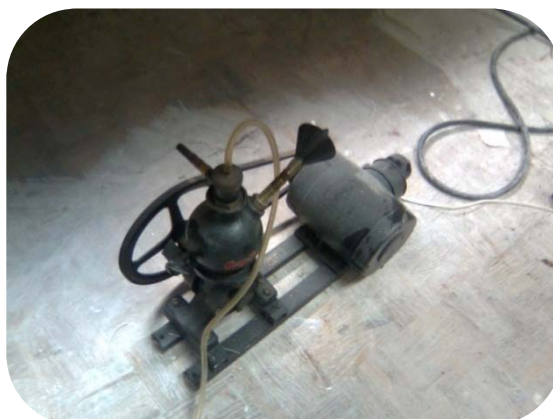
Slika 38 Vakuum pumpa – 150 mbar (85% vakuum)
