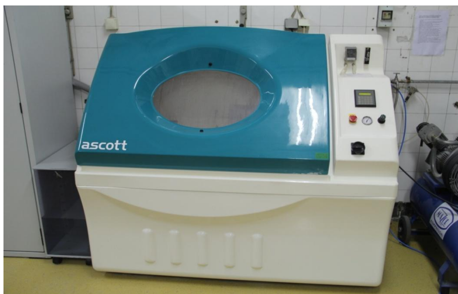
Slika 62. Slana komora, Laboratorij za zaštitu materijala, FSB
