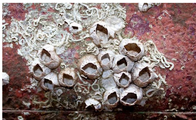
Slika 10. Obraštaj balanidima i crvima cjevašima [17]
