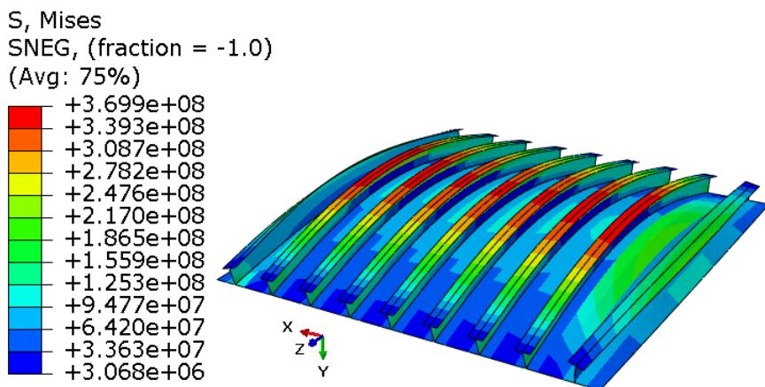
Slika 5.4: Raspodjela ekvivalentnog von Mises naprezanja [Pa]
