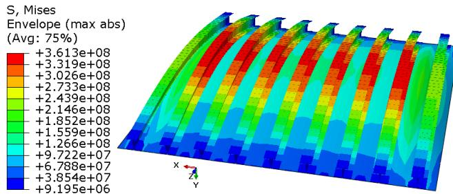
Slika 5.5: Raspodjela ekvivalentnog von Mises naprezanja [Pa]
