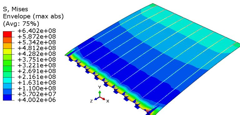
Slika 5.7: Raspodjela ekvivalentnog von Mises naprezanja [Pa]
