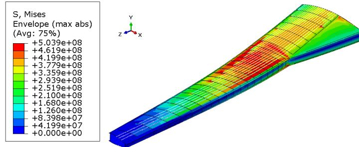
Slika 5.16: Naprezanja [Pa] prema von Mises-u torzijske kutije s grednim elementima za  $n=4,5$
