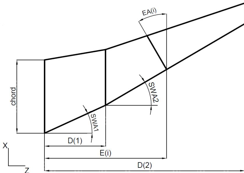
Slika 2.3: Parametri modela krila - tlocrt
