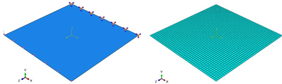
Slika 3.4: a) Savojno opterećenje i rubni uvjeti; b) Numerički model ljuške s ekvivalentnom debljinom
