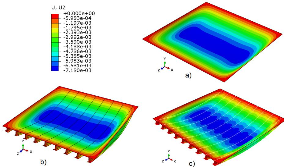
Slika 5.1: Pomak u smjeru osi  $Y$  pri tlačnom opterećenju [m]
