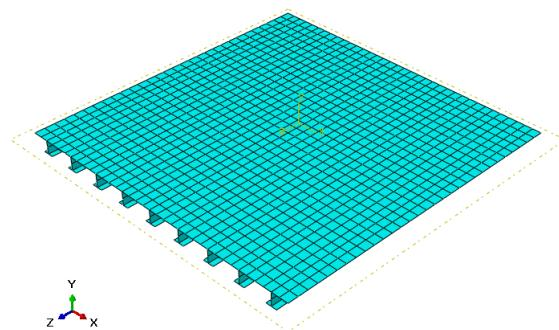
Slika 3.12: Numerički model panela s ljuskastim uzdužnicama
