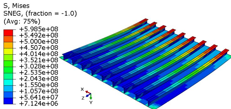
Slika 5.6: Raspodjela ekvivalentnog von Mises naprezanja [Pa]
