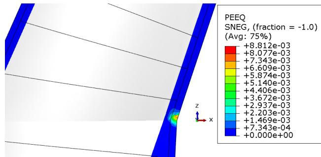
Slika 5.17: Ekvivalentna plastična deformacija [-] torzijske kutije s ekvivalentnim panealom pri  $n=4,5$
