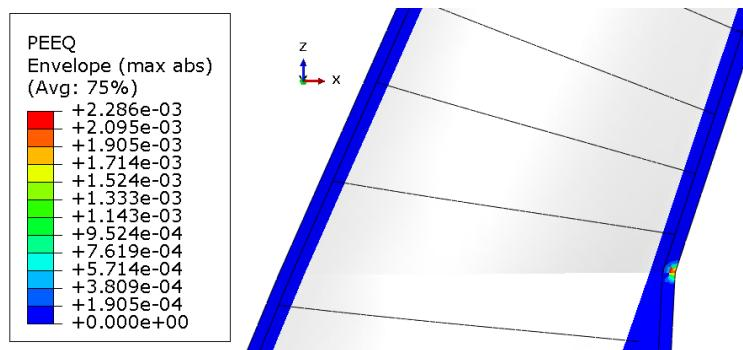
Slika 5.12: Ekvivalentna plastična deformacija [-] torzijske kutije s ekvivalentnim panealom
