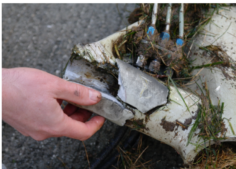
Slika 3: Puknuće noge glavnog podvozja zrakoplova Jetstream 31 [7]
