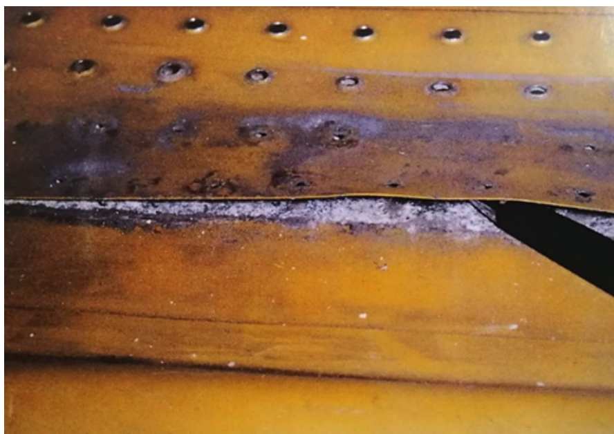
Slika 20: Oštećena oplata zrakoplova uslijed korozije u procjepu [35]
