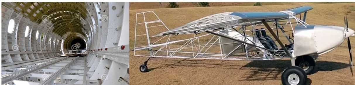
Slika 2: Primjena aluminijevih legura u zrakoplovstvu[5, 6]: a) okviri i uzdužnice putničkog zrakoplova, b) rešetkasta konstrukcija zrakoplova generalne avijacije
