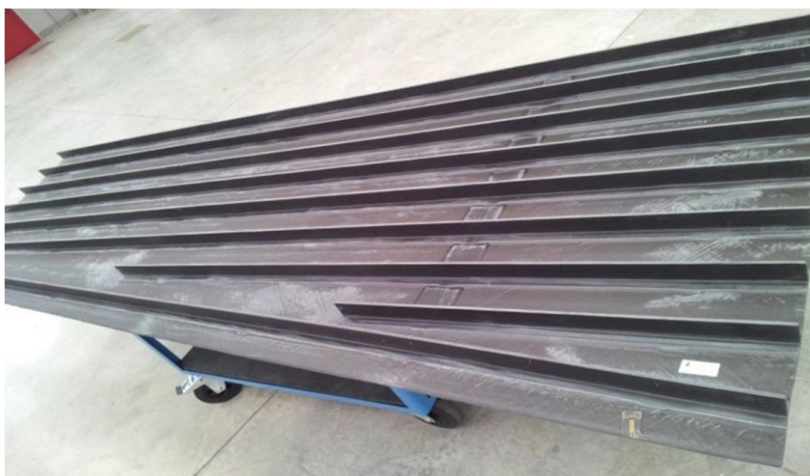
Slika 2. Kompozitni panel krila zrakoplova [1]
