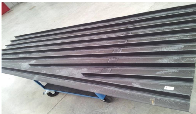
Slika 2. Kompozitni panel krila zrakoplova [1]
