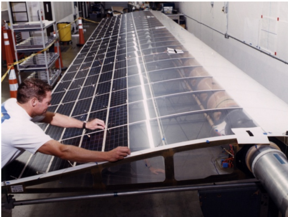
Slika 2.8: Lijepljenje solarnih ćelija na gornjaku krila letjelice Helios [15]
