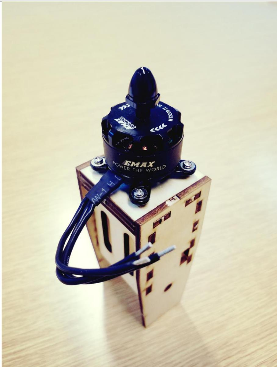
Slika 9. Motor s nosačem
