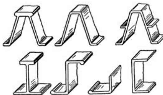
Slika 2.5 Različiti oblici uzdužnica [4]
