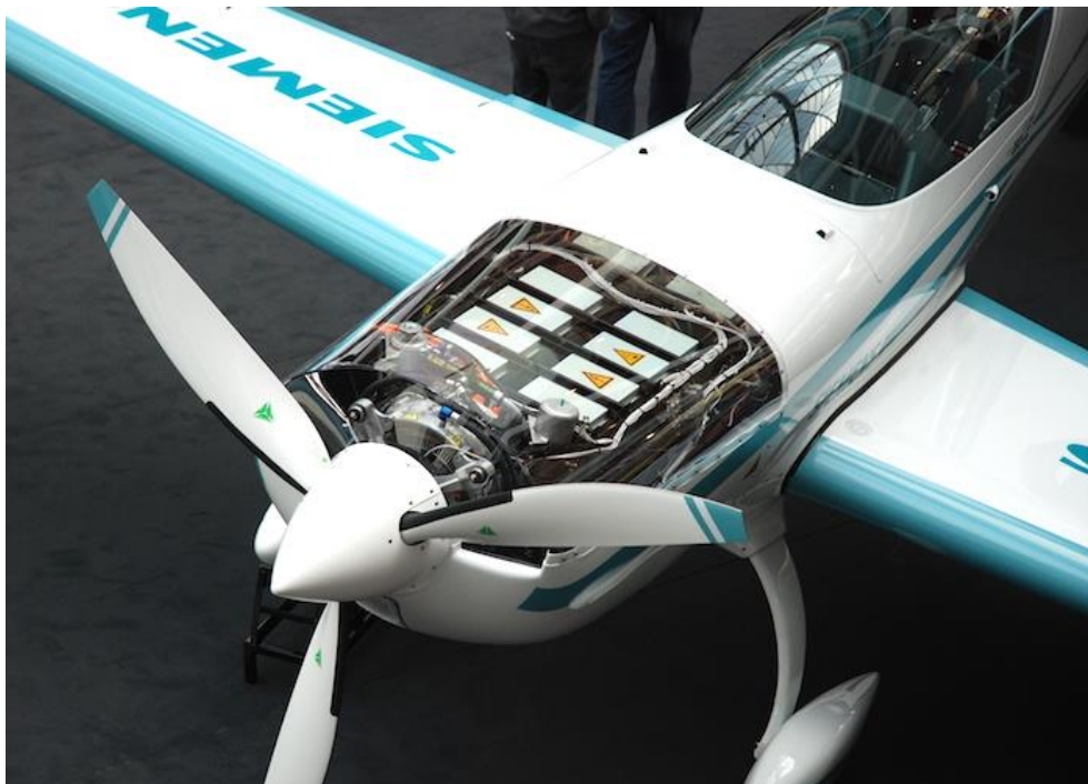
Slika 7. Pogonski sustav zrakoplova Extra 330LE [1]
