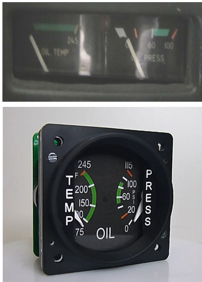
Slika 3.9. Analogni prikaznici tlaka i temperature ulja [7]
