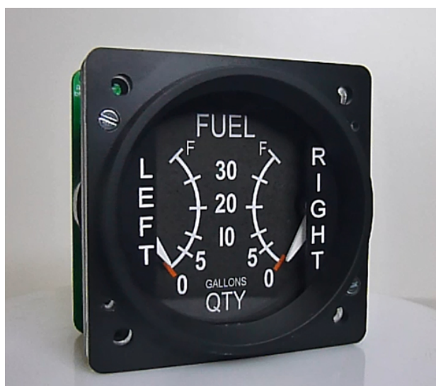
Slika 3.8. Indikator mjerača količine goriva [7]
