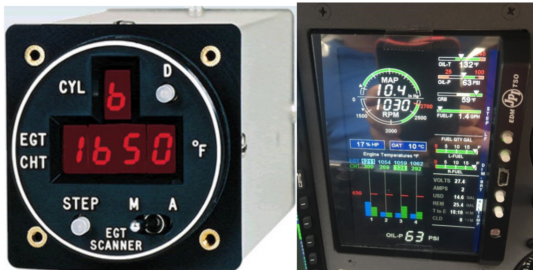
Slika 4.1. Lijevo: prikaznik uređaja EDM-900. Desno: prikaznik uređaja EDM Classic Scanner [9].
