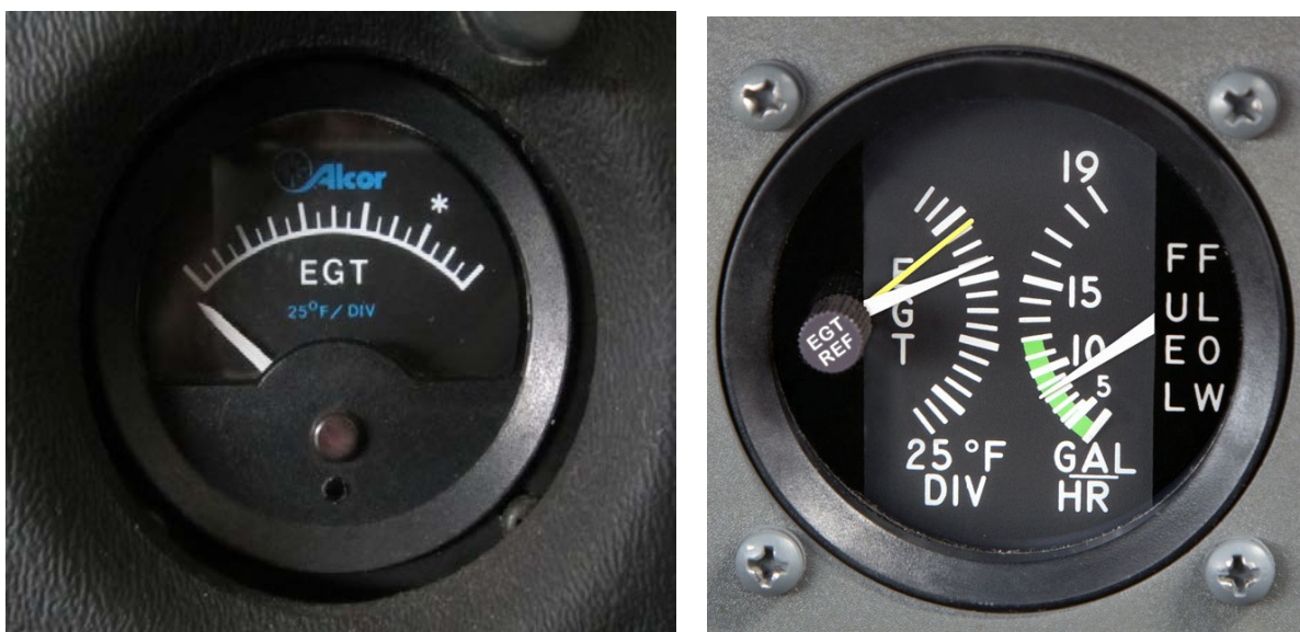
Slika 3.7. Lijevo: analogni EGT prikaznik. Desno: analogni prikaznik EGT i FF [6]
