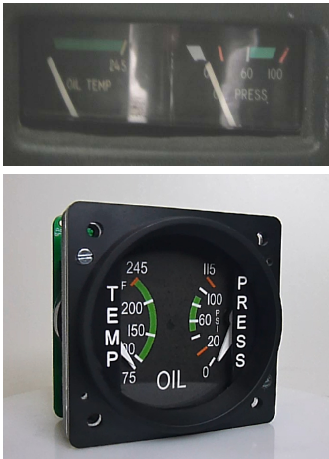
Slika 3.9. Analogni prikaznici tlaka i temperature ulja [7]
