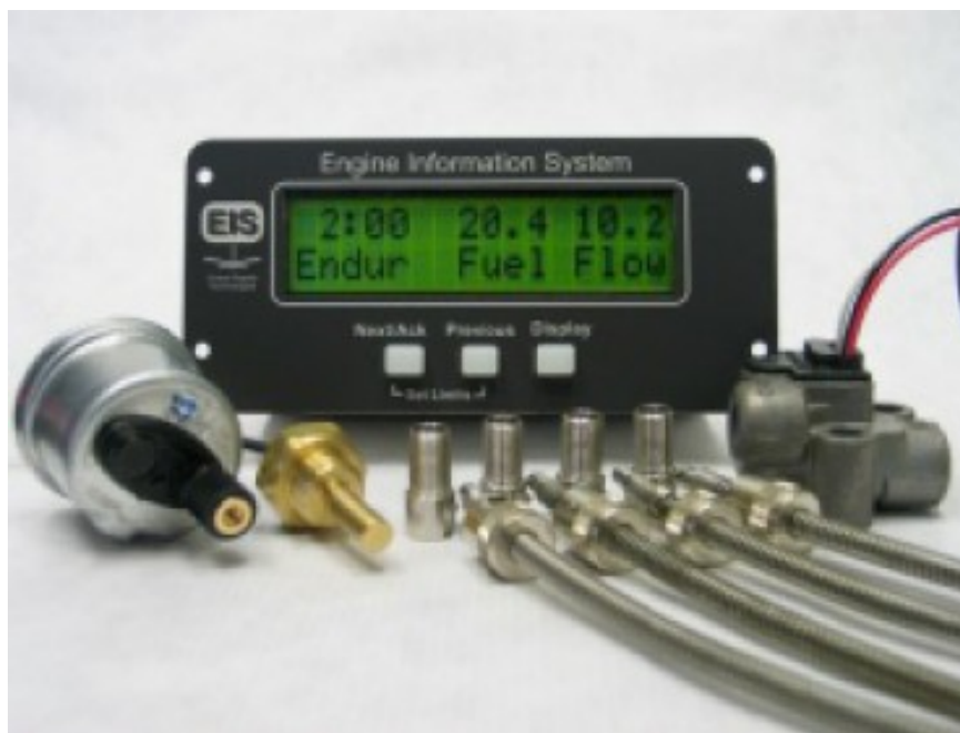
Slika 4.3. Prikaznik uređaja GRT EIS [10]
