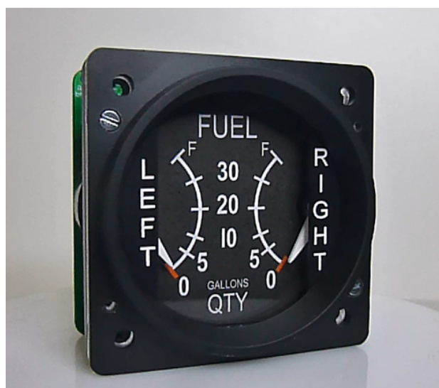
Slika 3.8. Indikator mjerača količine goriva [7]
