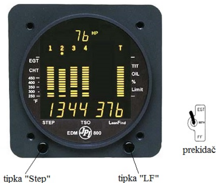
Slika 6.1. Prikaznik uređaja EDM-800 [9]
