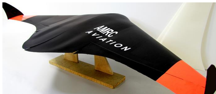
Slika 6 Bespilotna letjelica oblika letećeg krila napravljena FDM metodom od ABS materijala [8]
