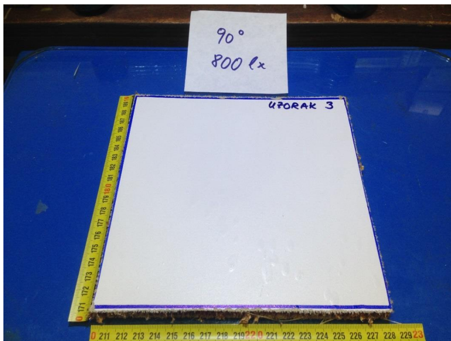
Slika 35 Fotografija ispitnog uzorka "Uzorak 3" snimljena pod kutom od 90°. U donjem desnom kutu daju se naslutiti površinske nepravilnosti u obliku kapljica
