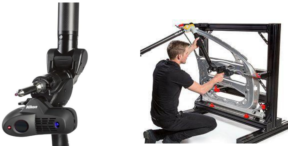
Slika 15 Snimanje površine interijera automobilskih vrata s Nikon ModelMakerom H120 [13]
